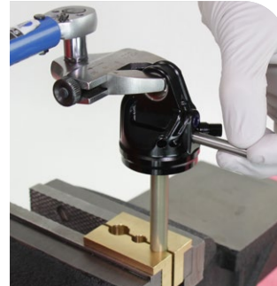
13-mm- oder verstellbarer Schraubenschlüssel 5,6 N•m
