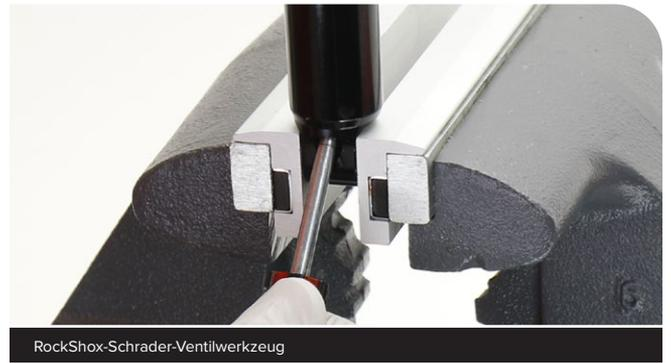
5 Spannen Sie den Dämpferkörper in die SIDLuxe 23,8-mm-Schraubstockblöcke für Hinterbau-Dämpferkörper (00.4318.040.000) ein.
