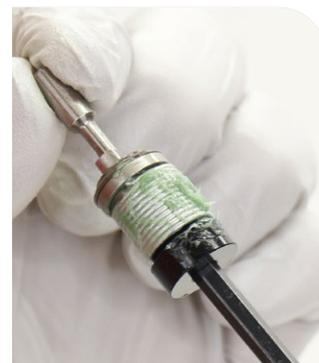
**17** Führen Sie die Nocke der fernbedienbaren Sperre, die Feder und den Vorspanner in das Auge/die Befestigung ein. Halten Sie die äußere Nockenbuchse an der anderen Seite mit dem Finger fest.
