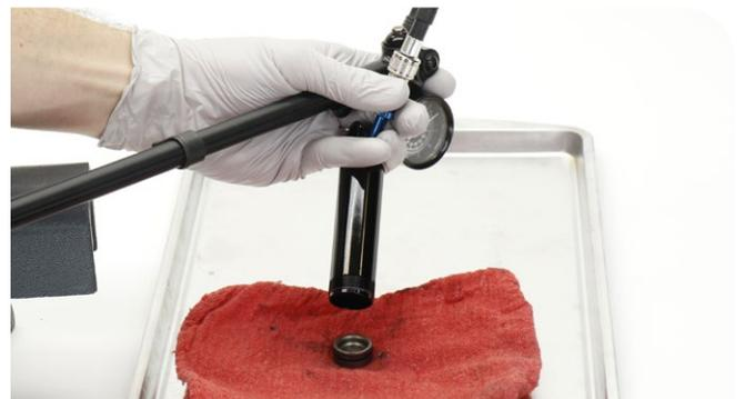
**3** Schrauben Sie den Luftventil-Adapter vom Dämpferkörper ab.
