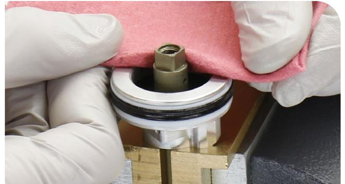
**6** Führen Sie den Dorn in die Mitte der Dämpferführungsstange ein und montieren Sie die Kolben-Baugruppe auf der Dämpferführungsstange. Zentrieren Sie die Teile auf dem Vierkant-Ende der Dämpferführungsstange.
