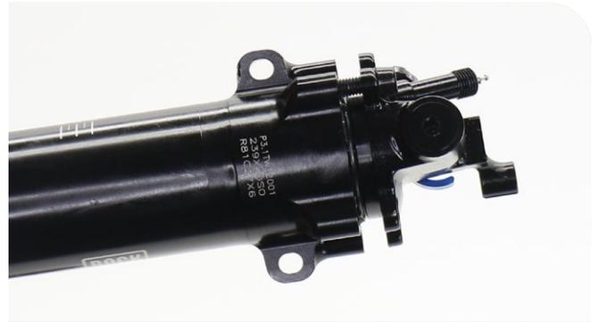
**7** Setzen Sie die zweite Schraube in die diagonal befindliche Bohrung ein und schrauben Sie sie mit zwei vollen Umdrehungen ein.
