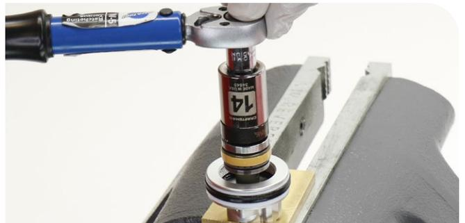
Steckschlüsselwerkzeug für SIDLuxe / IsoStrut-Ventildeckel- und Kolbenschraube – 14-mm-Stecknuss 2,3 N·m
