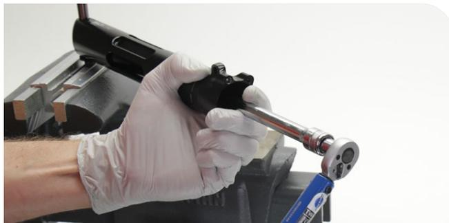
Steckschlüsselwerkzeug für die Dichthülse der IsoStrut-Luftkammer
