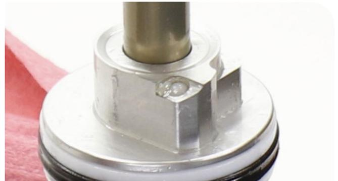
**12** Tragen Sie ein wenig Schmierfett auf das Ende eines 2-mm-Inbusschlüssels auf, um die Entlüftungsschraube zu fixieren.
