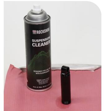
**6** Prüfen Sie mit einer Lampe die Innen- und Außenseite des Dämpferkörpers auf Kratzer, Einkerbungen oder andere Verformungen der Oberflächen. Wenn Sie Verformungen feststellen, muss der Dämpferkörper ersetzt werden.
