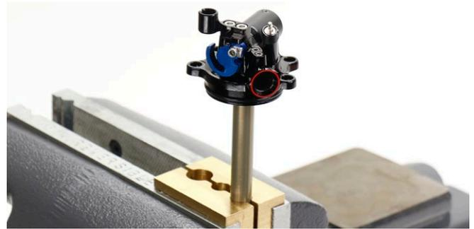
RockShox-Schraubstockblöcke für Hinterbaudämpfer (10 mm)
