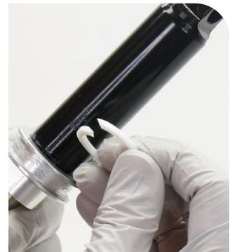
**2** Entfernen Sie den äußeren O-Ring des Auges/der IsoStrut-Luftkammer und entsorgen Sie ihn.
