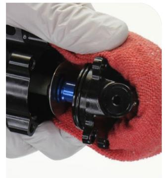
**8** Entfernen Sie den Dämpfer vom Wartungsstift für den Hinterbaudämpfer.
