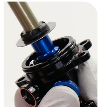
**5** Montieren Sie einen neuen dicken Stützring (dem Auge/der Befestigung am nächsten).
