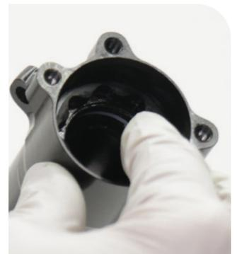
**12** Setzen Sie die IsoStrut-Luftkammer auf den Wartungsstift für den Hinterbaudämpfer auf.
