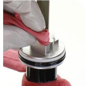
**13** Schrauben Sie den SIDLuxe-Hinterbaudämpfer-Luftventil-Adapter (blau) in eine Dämpferpumpe und das andere Ende an den Luft-/Stickstoff-Einfüllstutzen des Dämpferkörpers.
