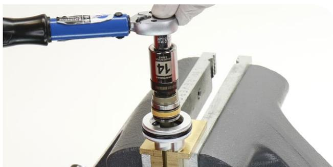
Steckschlüsselwerkzeug für SIDLuxe/IsoStrut-Ventildeckel- und Kolbenschrauben – 14-mm-Stecknuss
