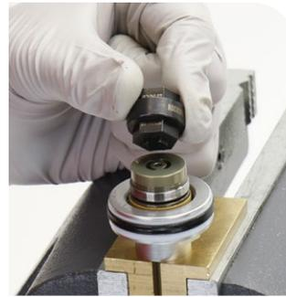
Steckschlüsselwerkzeug für SIDLuxe / Iso-Strut-Ventildeckel- und Kolbenschrauben
