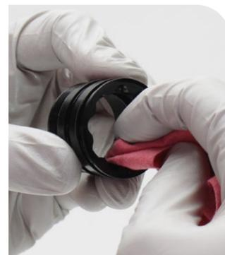
Ersetzen Sie den O-Ring oder die Dichtung durch ein neues Teil aus dem Wartungssatz. Entfernen Sie den O-Ring oder die Dichtung mit den Fingern oder einem Dorn.
