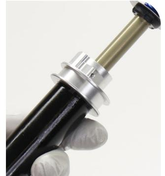
**4** Geben Sie Schmierfett auf einen neuen Augen-/IsoStrut-Luftkammer-O-Ring und setzen Sie ihn ein.
