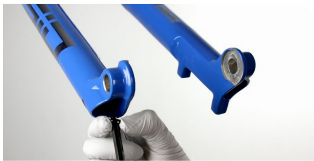
Ultimate : 5 mm sur le côté cartouche
