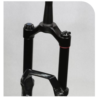
Réglage du débattement maximal
