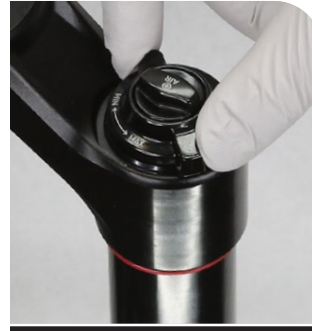
Réglage du débattement minimal
