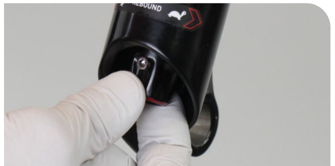
RC Dans le sens inverse des aiguilles d'une montre - Réglage d'ouverture maximale
