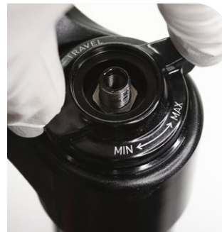
Réglage du débattement maximal
