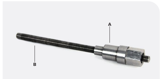
Herramienta de casquillos del amortiguador trasero RockShox de 1/2" x 1/2"
