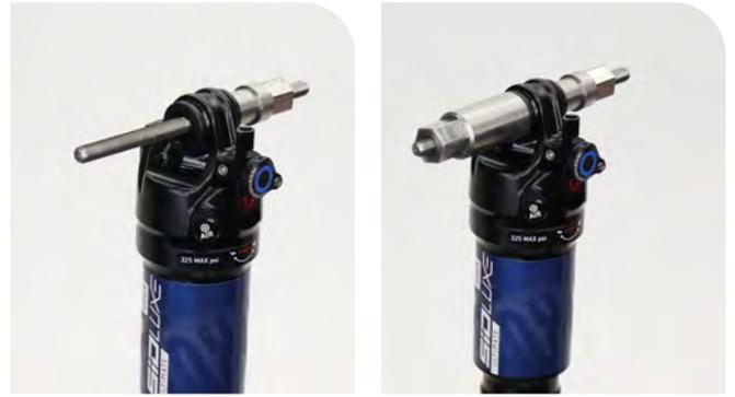
**3** Serrez le receveur dans un étau ou bloquez-le fermement à l'aide d'une clé plate de 13 mm ou d'une clé à molette.
