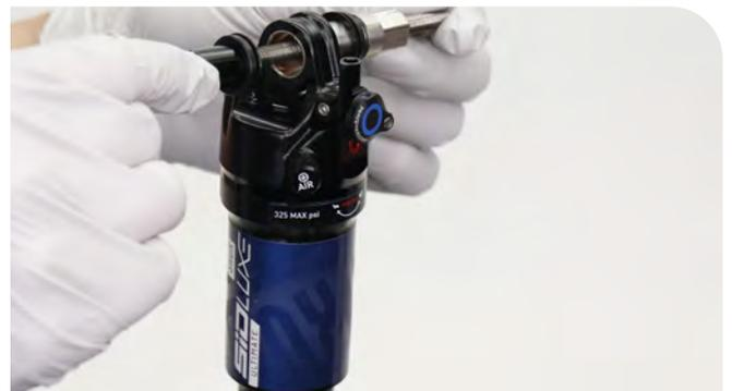
**4** Si la clavette de la bague ne se retire pas facilement, réinsérez la tige filetée et la clavette de pression à travers la tige de l'œillet.
