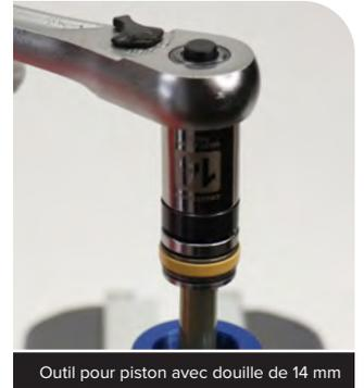
Outil pour piston avec douille de 14 mm
