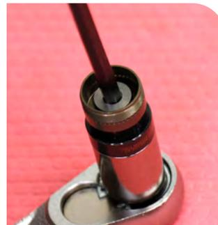
Douille de 14 mm/Outil pour piston/5 mm
