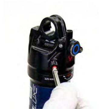
**9** Mettez l'amortisseur en pression jusqu'à ce que le corps de la cartouche d'amortissement soit en position d'extension complète à environ 3,5 bar/50 PSI.
