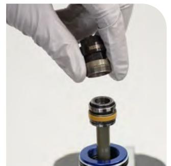
Kolbenwerkzeug und 14-mm-Stecknuss
