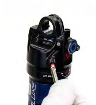
**9** Beaufschlagen Sie den Dämpfer mit ausreichend Druck, um den Dämpferkörper auf die volle Länge auszufahren, etwa 3,5 bar. Bringen Sie die Luftventilkappe mit der Hand an.
