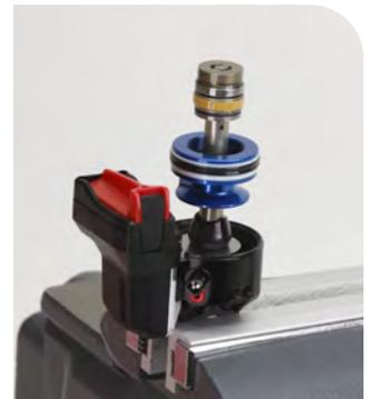
**2** Bewegen Sie die Dichtkopf/Luftkolben-Baugruppe nach unten.
