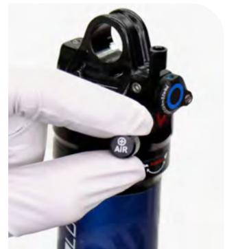
**10** Flight Attendant (FA): Entfernen Sie den Kontakttrenner. Montieren Sie den SRAM-Akku.
