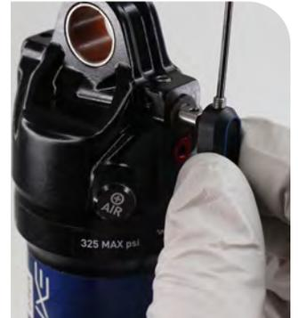
**2** Entfernen Sie die Madenschraube auf der Vorderseite des Auges.
