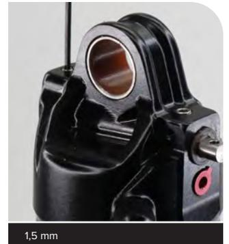
**3** Entfernen Sie die Arretierfeder und den Vorspanner auf der Rückseite des Auges.
