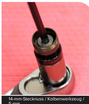
14-mm-Stecknuss / Kolbenwerkzeug / 5 mm
