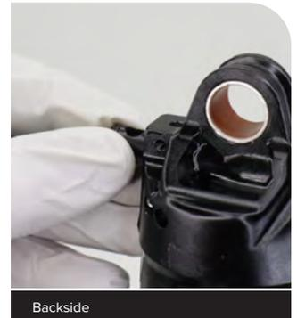
**6** Entfernen Sie die Nocken-Baugruppe auf der Rückseite des Auges.
