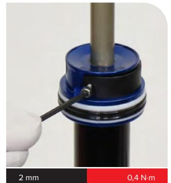
**Ausbau von Tokens:** Spannen Sie das Dämpferkörperauge in den Schraubstock ein.
