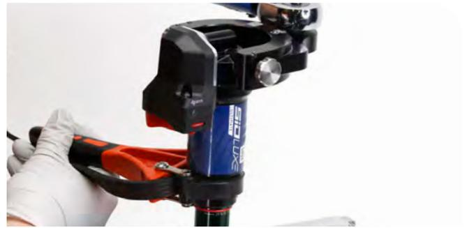
Hahnenfußschlüssel für Zapfenbefestigung und Bandschlüssel
