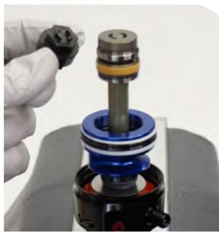
Ventildeckel mit Kolbenwerkzeug
