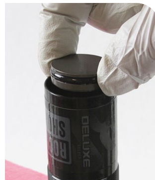
Deluxe IFP Height Tool (Höheneinstellwerkzeug)
