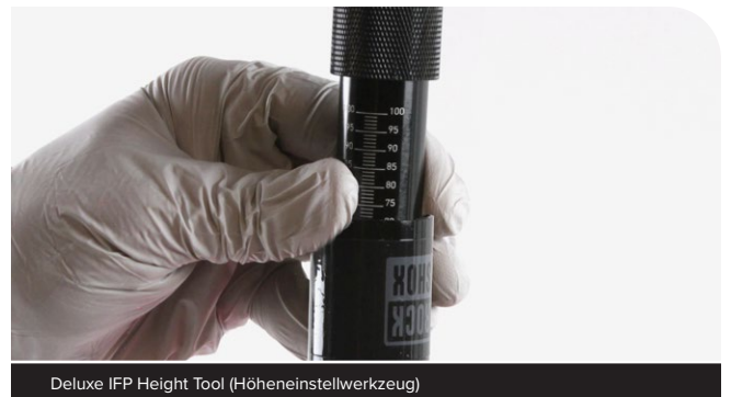
Deluxe IFP Height Tool (Höheneinstellwerkzeug)
