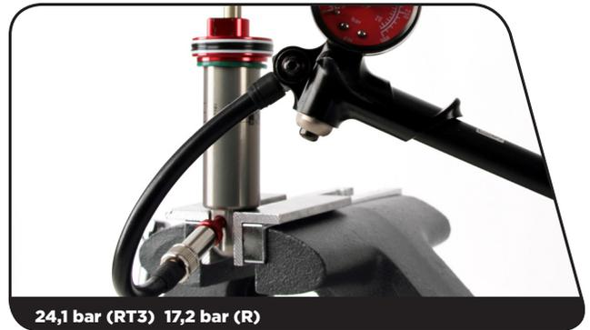
**9** Verwenden Sie ein Schrader-Ventilwerkzeug, um die Kappe des Luft-/Stickstoffeinfüllstutzens des Dämpfers wieder anzubringen.
