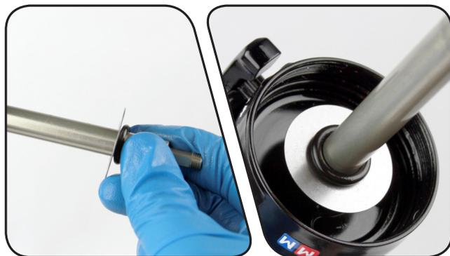
**11** Entfernen und ersetzen Sie mit den Fingern den O-Ring im Inneren des Gewindes des Führungsstangenages.
