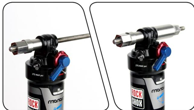
**3** Spannen Sie den Aufnehmer in einem Schraubstock ein oder fixieren Sie ihn mit einem 13-mm-Maulschlüssel bzw. einem verstellbaren Schlüssel.
