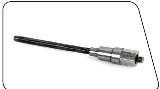
**2** Führen Sie die Gewindestange durch das Führungsstangenauge so ein, dass der Druckstift am Buchsenstift anliegt.
