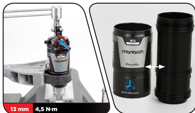
**7** Entnehmen Sie den Dämpfer aus dem Schraubstock. Sprühen Sie Isopropyl-Alkohol auf den Dämpfer und säubern Sie ihn mit einem Lappen.
