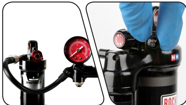
**12 Nur DebonAir™-Luftkammern:** Beaufschlagen Sie mit einer Dämpferpumpe den Dämpfer mit dem gewünschten Luftdruck. Nachdem Sie Luft zum Dämpfer hinzugefügt haben, muss der Druck zwischen den Dämpferkammern ausgeglichen werden.
