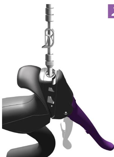
Während Sie den Bremshebel am Lenker halten, schieben Sie den Kolben am Bremssattel vor und lassen Sie den Druck den Hebel in die vollständig entspannte Position zurückziehen.
