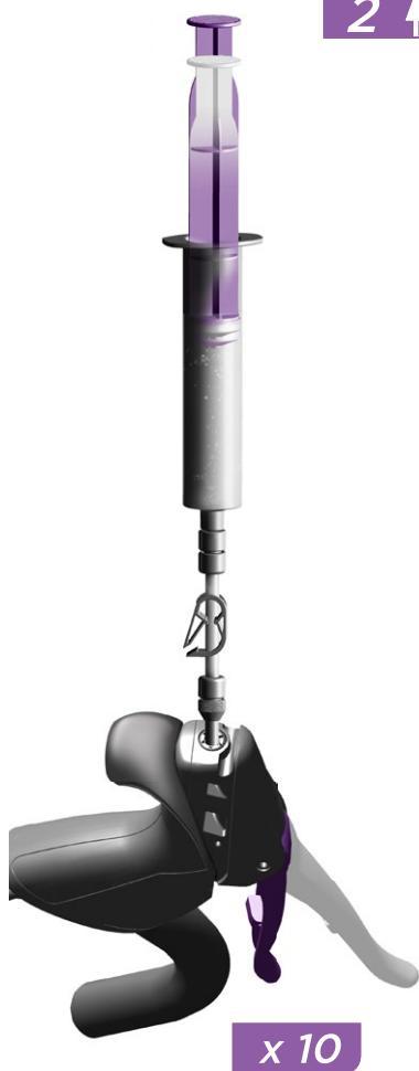
Trzymaj strzykawkę na dźwigni w pozycji pionowej. Zdecydowanie wyciągaj tłoczek, aby stworzyć próżnię, a następnie naciśnij tłoczek, aby uszczelnić układ.
