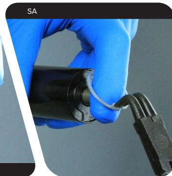
**5** Avec les doigts, installez le boulon inférieur sur la came pneumatique.
