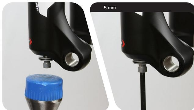
**6** Tirez fermement les fourreaux inférieurs vers le bas jusqu'à ce que l'huile commence à couler. Continuez à tirer les fourreaux inférieurs vers le bas afin de les retirer de la fourche.
