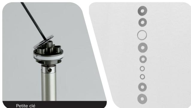
**4** Reportez-vous au tableau ci-dessous pour savoir quelles rondelles mettre en place sur le piston de l'amortisseur du rebond afin d'obtenir le réglage souhaité. À l'aide d'un pied à coulisse, vérifiez le diamètre externe ainsi que l'épaisseur de la rondelle ou bien imprimez cette page (avec un zoom de page réglé sur 100 %) afin de disposer les rondelles directement sur les gabarits de la page.
