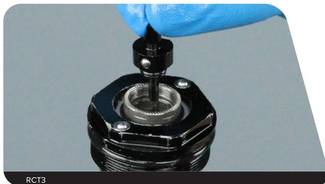
**RC** : à l'aide d'une pince à bec fin, insérez le bouchon de purge dans la molette de réglage de compression jusqu'à ce qu'elle s'enclenche à sa place.
