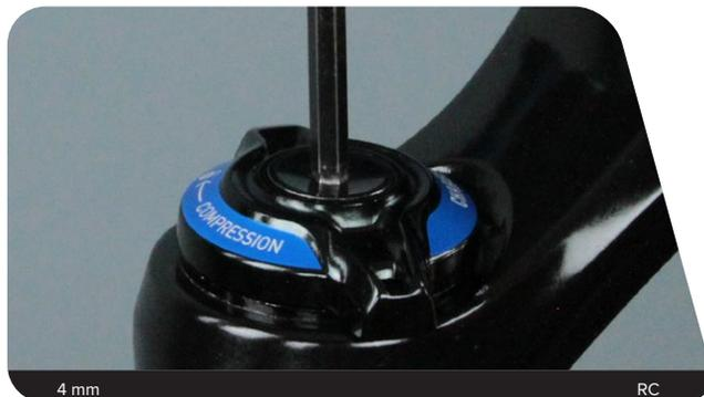
**3** À l'aide d'une clé à douille de 30 mm, desserrez le capuchon supérieur de l'amortisseur.
