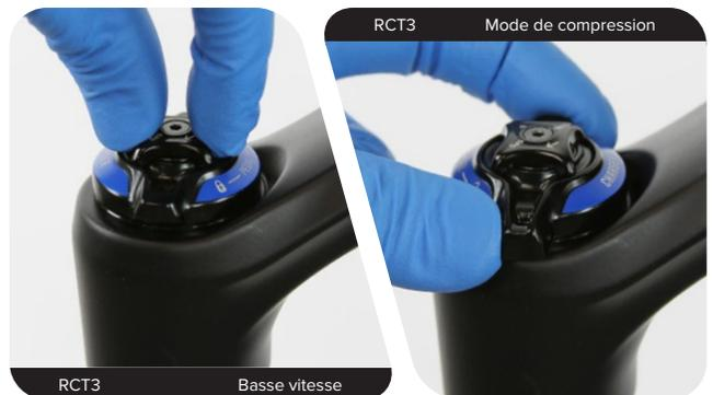
**RC :** tournez la molette de réglage de la compression basse vitesse dans le sens inverse des aiguilles d'une montre jusqu'à ce qu'elle se bloque dans la position d'ouverture maximale.
