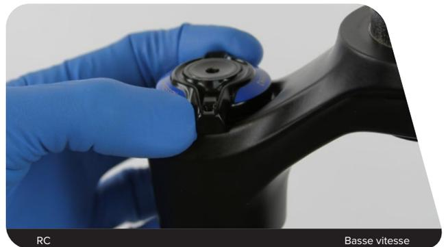
**2** **RCT3** : à l'aide d'une clé hexagonale de 2 mm, retirez la vis de la molette de réglage de compression basse vitesse. Retirez la molette de réglage de compression basse vitesse.
