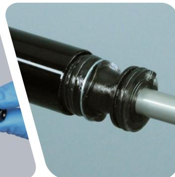
**6** Vaporisez de l'alcool isopropylique sur l'intérieur et l'extérieur du tube supérieur puis nettoyez-le avec un chiffon.
