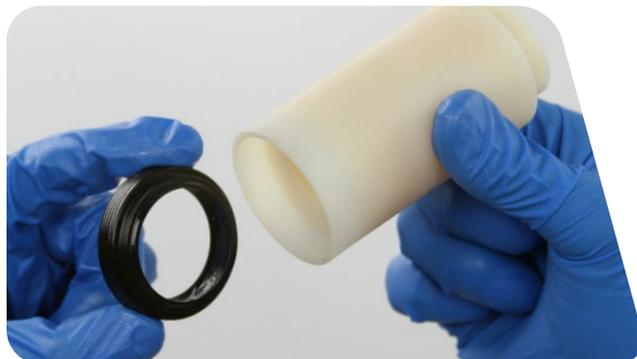
**9** Maintenez fermement le fourreau inférieur en place puis, à l'aide de l'outil d'installation des joints, insérez bien droit le joint anti-poussière dans le fourreau inférieur jusqu'à ce que la surface du joint affleure avec le haut de la surface du fourreau inférieur.
