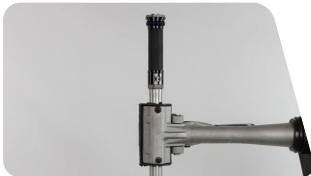
**1** **RCT3** : à l'aide d'une petite pince pour anneaux de blocage, retirez l'anneau de blocage situé sur la molette de réglage de compression basse vitesse.
