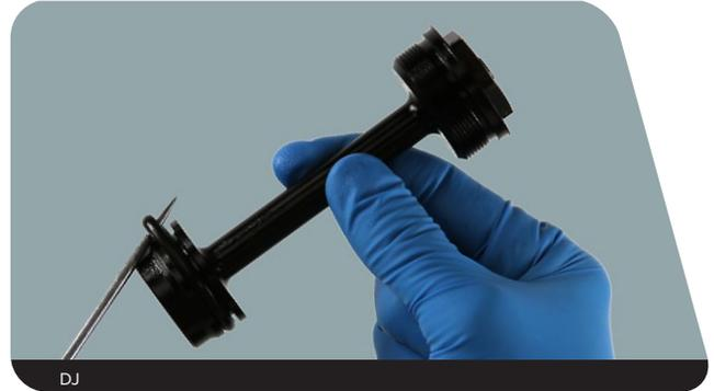
**4** **Dual Position Air** : repoussez la came pneumatique dans le tube supérieur afin d'éviter qu'elle ne se raye lors du démontage de l'anneau de blocage.
