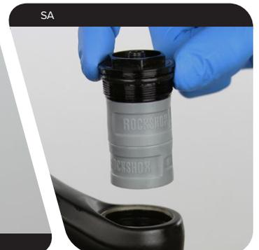
**3** Avec les doigts ou une pointe, retirez le joint torique du capuchon supérieur.
