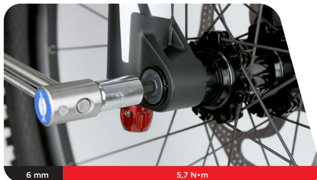
**9** À l'aide d'une clé dynamométrique équipée d'une douille hexagonale de 6 mm, serrez le boulon de l'axe du côté opposé à la chaîne à un couple de 3,4 N•m.
