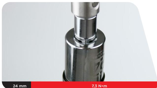
**5** Mettez en place la molette de réglage de compression basse vitesse et la vis de blocage de cette molette.
