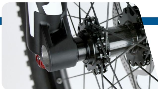
**8** Insérez la partie fileté du Maxle Lite DH dans le moyeu du côté de la chaîne jusqu'à ce qu'il s'engage dans le filetage de la patte du fourreau inférieur.
