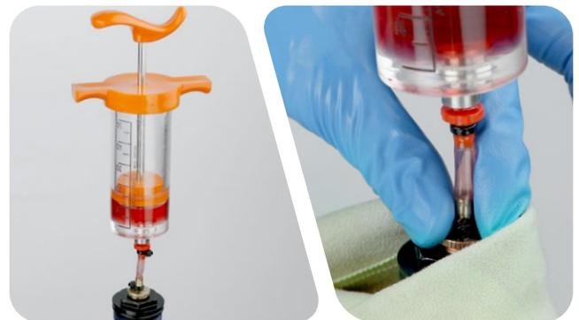
**24** Avec les doigts, installez le réglage de compression basse vitesse dans le capuchon supérieur de compression.
