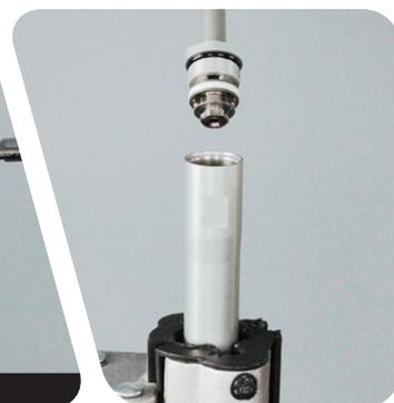
**Code de la date de fabrication après 26T5 :** placez une clé plate de 21 mm sur les bords plats du tube de la cartouche. Placez une clé plate de 23 mm sur la tête d'étanchéité de l'amortisseur.
