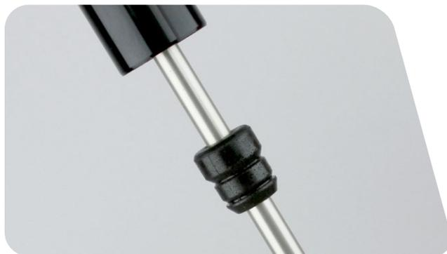
**30** Mettez en place la molette de réglage de compression basse vitesse et la vis de blocage de la molette. À l'aide d'une clé dynamométrique équipée d'une douille hexagonale de 2 mm, serrez la vis à un couple compris entre 1 et 1,5 N•m
