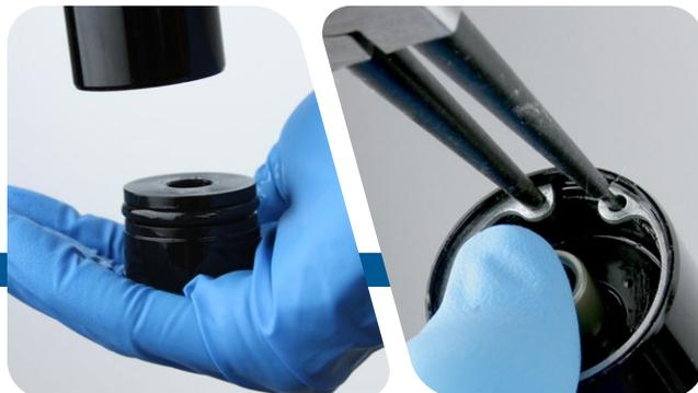
**29** Avec les doigts, installez la butée de talonnage sur la came de l'amortisseur du rebond avec sa plus petite extrémité tournée vers le bas.
