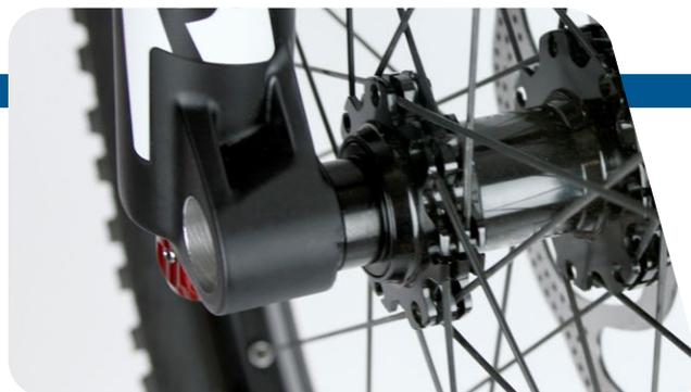
**9** Insérez la partie filetée du Maxle Lite DH dans le moyeu du côté de la chaîne jusqu'à ce qu'il s'engage dans le filetage de la patte du fourreau inférieur.
