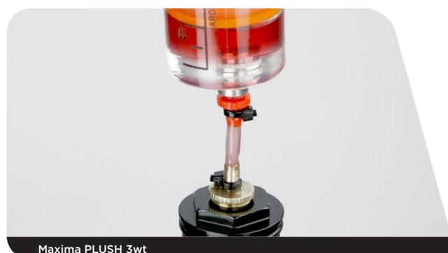
**22** Créez une dépression dans l'unité de l'amortisseur en tirant sur le piston de la seringue tout en repoussant la came de l'amortisseur du rebond vers le haut. Ceci fera sortir les bulles d'air contenues dans l'unité de l'amortisseur.
