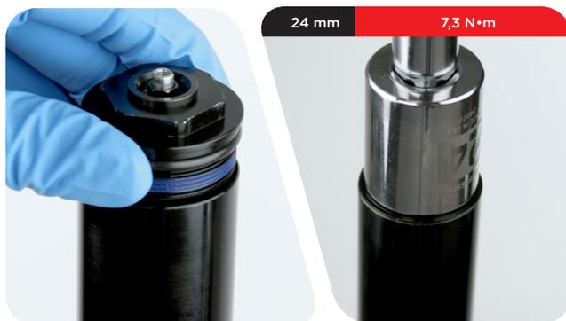
**28** Appliquez de la graisse SRAM Butter sur le joint d'étanchéité de la tête d'étanchéité inférieure puis installez-la sur la came du rebond avec le côté épais de la tête d'étanchéité inférieure tourné vers le tube supérieur. Appuyez sur la tête d'étanchéité inférieure afin qu'elle se loge dans le bas du tube supérieur.
