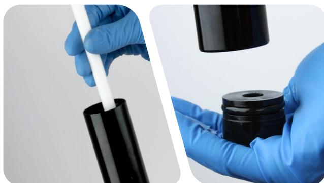
**8** Avec les doigts, retirez le joint torique externe situé sur la tête d'étanchéité inférieure. À l'aide d'une pointe, piquez et retirez le joint d'étanchéité interne de la tête d'étanchéité inférieure.
