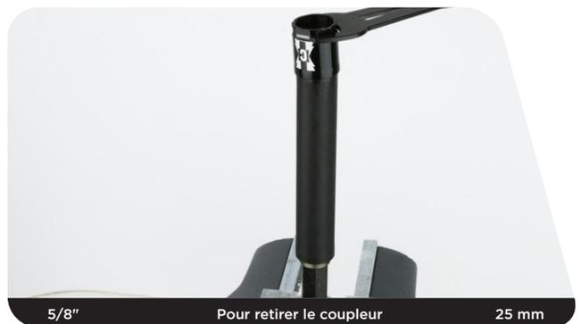
**26** À l'aide d'une pointe ou de vos doigts, retirez le joint torique situé à l'intérieur du coupleur.
