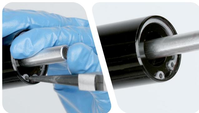
**4** Appliquez une bonne dose de graisse SRAM Butter sur le ressort hélicoïdal.
