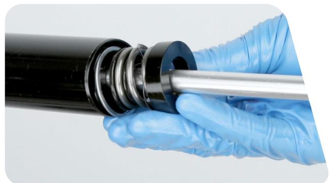
**8** Sprühen Sie Isopropyl-Alkohol auf die Innen- und Außenseite des Standohrs, und säubern Sie es mit einem Lappen.
