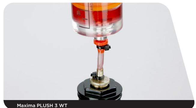
**22** Erzeugen Sie Unterdruck in der Dämpfer-Baugruppe, indem Sie den Spritzenkolben zurückziehen und gleichzeitig die Zugstufendämpfer-Führungsstange nach oben schieben. Dadurch werden die Luftblasen aus der Dämpfer-Baugruppe gesaugt.
