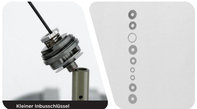
**4** Verwenden Sie die folgende Tabelle, um den Federplättchenstapel für die gewünschte Abstimmung ihres Druckstufendämpferkolbens zusammenzustellen. Prüfen Sie mit einer metrischen Lehre den Außendurchmesser und die Dicke der Plättchen oder drucken Sie die Seite im Maßstab 100 % aus, um den Federplättchenstapel anhand der Umrisse auf der Seite zusammenzustellen.
