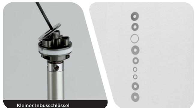
**4** Verwenden Sie die folgende Tabelle, um den Federplättchenstapel für die gewünschte Abstimmung ihres Zugstufendämpferkolbens zusammenzustellen. Prüfen Sie mit einer metrischen Lehre den Außendurchmesser und die Dicke der Plättchen oder drücken Sie die Seite im Maßstab 100 % aus, um den Federplättchenstapel anhand der Umriss auf der Seite zusammenzustellen.
