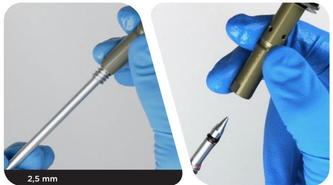
**23** Entfernen Sie mit den Fingern oder einem Dorn den O-Ring von der Lowspeed-Druckstufennadel.
