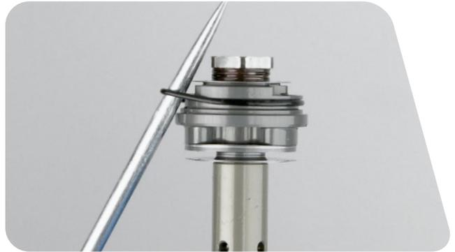
**22** Entfernen Sie mit den Fingern oder mit einem 2,5-mm-Inbusschlüssel die Lowspeed-Druckstufennadel.
