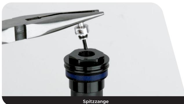
**20** Entfernen Sie mit den Fingern oder einem Dorn den O-Ring vom Lowspeed-Druckstufeneinsteller.
