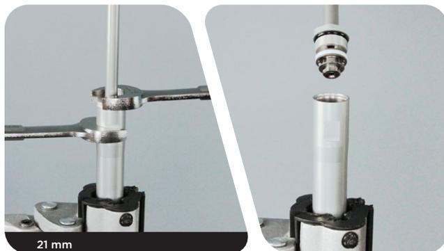
**Herstellungsdatumscode nach 26T5:** Platzieren Sie einen 21-mm-Maulschlüssel auf den Schlüsselflanken des Patronenrohrs. Platzieren Sie einen 23-mm-Maulschlüssel auf dem Dichtkopf des Dämpfers.
