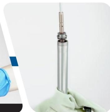
**15** Sprühen Sie Isopropyl-Alkohol auf die Gewinde des Patronenrohrs und säubern Sie die Gewindegänge mit einem Lappen.
