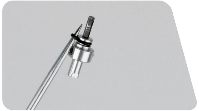
**21** Entfernen Sie mit den Fingern oder einem Dorn den O-Ring vom Druckstufenkolben.
