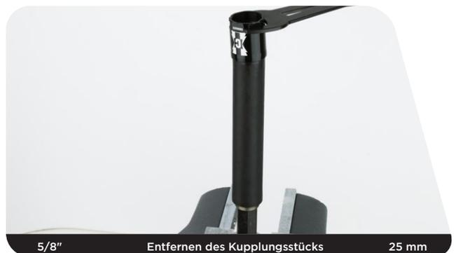
**26** Entfernen Sie mit einem Dorn oder mit den Fingern den O-Ring im Inneren des Kupplungsstücks.
