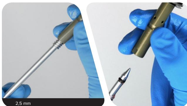
**22** Avec les doigts ou une pointe, retirez le joint torique de l'aiguille de compression basse vitesse.
