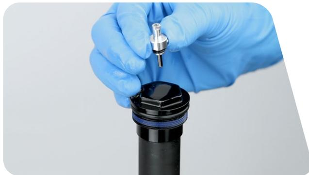
**25** Avec les doigts, installez l'écrou de maintien du capuchon supérieur de compression. À l'aide d'une clé dynamométrique équipée d'une douille de 6 mm, serrez à un couple de 4,8 N·m.
