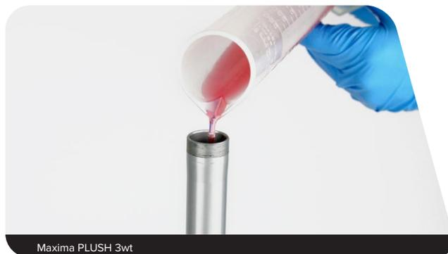
**13** Avec la paume de la main ou un chiffon, recouvrez le tube de la cartouche et actionnez la came de rebond de l'amortisseur à plusieurs reprises afin de préparer la purge de l'air contenu dans l'amortisseur.
