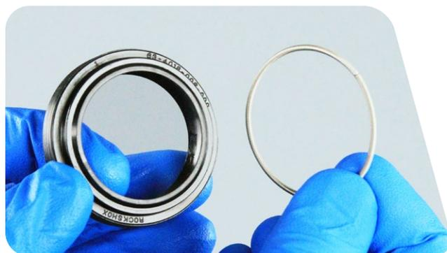
**8** Insérez la partie étroite du joint anti-poussière neuf dans la partie creuse de l'outil d'installation des joints.
