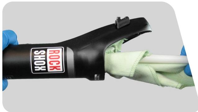
**6** Mettez en place les joints en mousse neufs sur les douilles supérieures à l'intérieur du fourreau inférieur.
