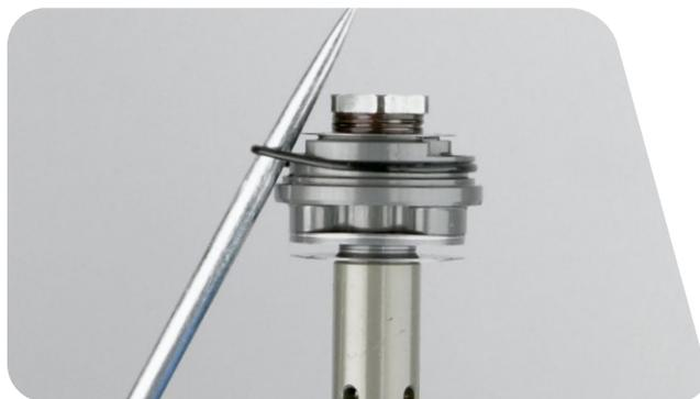
**21** À l'aide d'une clé hexagonale de 2,5 mm ou avec les doigts, retirez l'aiguille de compression basse vitesse.
