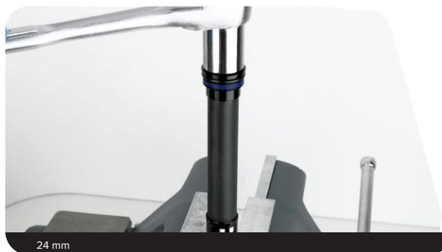
**24** Serrez une douille hexagonale de 5/8 po dans un étau.
