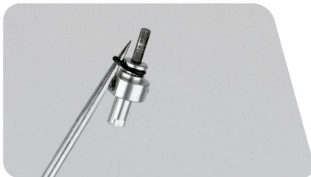
**20** Avec les doigts ou une pointe, retirez le joint torique du piston de compression.
