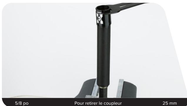
**25** À l'aide d'une pointe ou de vos doigts, retirez le joint torique situé à l'intérieur du coupleur.
