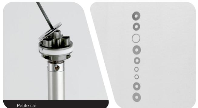
**4** Reportez-vous au tableau ci-dessous pour savoir quelles rondelles mettre en place sur le piston de l'amortisseur du rebond afin d'obtenir le réglage souhaité. À l'aide d'un pied à coulisse, vérifiez le diamètre externe ainsi que l'épaisseur de la rondelle ou bien imprimez cette page (avec un zoom de page réglé sur 100 %) afin de disposer les rondelles directement sur les gabarits de la page.
