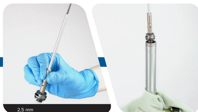
**15** Vaporisez de l'alcool isopropylique sur le filetage du tube de la cartouche puis nettoyez-le avec un chiffon.
