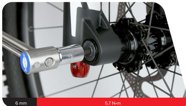
**10** À l'aide d'une clé dynamométrique équipée d'une douille hexagonale de 6 mm, serrez le boulon de l'axe du côté opposé à la chaîne à un couple de 3,4 N·m.
