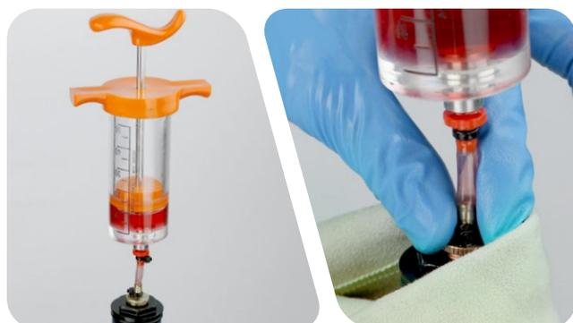
**24** Avec les doigts, installez le réglage de compression basse vitesse dans le capuchon supérieur de compression.
