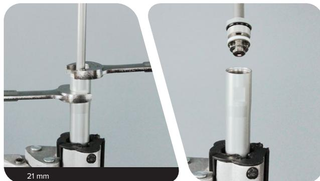
**Code de la date de fabrication après 26T5 :** placez une clé plate de 21 mm sur les bords plats du tube de la cartouche. Placez une clé plate de 23 mm sur la tête d'étanchéité de l'amortisseur.
