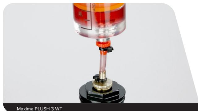
**22** Erzeugen Sie Unterdruck in der Dämpfer-Baugruppe, indem Sie den Spritzenkolben zurückziehen und gleichzeitig die Zugstufendämpfer-Führungsstange nach oben schieben. Dadurch werden die Luftblasen aus der Dämpfer-Baugruppe gesaugt.
