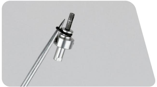
**20** Entfernen Sie mit den Fingern oder einem Dorn den O-Ring vom Druckstufenkolben.
