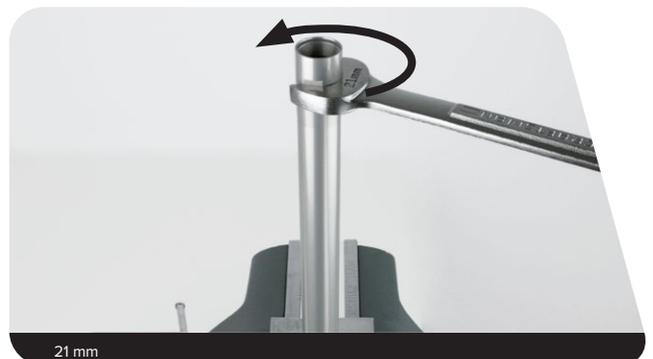
**15** Entnehmen Sie das Kupplungsstück, die Membran und die Druckstufen-Abdeckkappen-Baugruppe aus dem Schraubstock.
