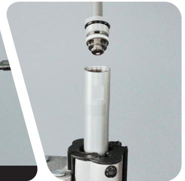
**Herstellungsdatumscode nach 26T5:** Platzieren Sie einen 21-mm-Maulschlüssel auf den Schlüsselflanken des Patronenrohrs. Platzieren Sie einen 23-mm-Maulschlüssel auf dem Dichtkopf des Dämpfers.
