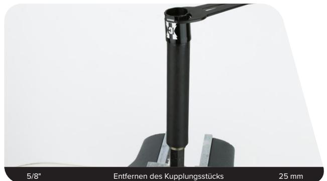
**25** Entfernen Sie mit einem Dorn oder mit den Fingern den O-Ring im Inneren des Kupplungsstücks.
