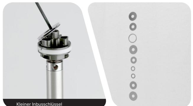
**4** Verwenden Sie die folgende Tabelle, um den Federplättchenstapel für die gewünschte Abstimmung Ihres Zugstufendämpferkolbens zusammenzustellen. Prüfen Sie mit einer metrischen Lehre den Außendurchmesser und die Dicke der Plättchen oder drucken Sie die Seite im Maßstab 100 % aus, um den Federplättchenstapel anhand der Umrisse auf der Seite zusammenzustellen.
