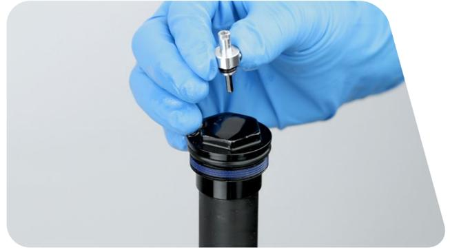
**25** Bringen Sie die Sicherungsmutter der Druckstufen-Abdeckkappe von Hand an. Ziehen Sie die Mutter mit einem Drehmomentschlüssel mit einer 6-mm-Stecknuss mit 4,8 N•m fest.
