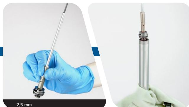
**15** Sprühen Sie Isopropyl-Alkohol auf die Gewinde des Patronenrohrs und säubern Sie die Gewindegänge mit einem Lappen.
