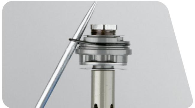
**21** Entfernen Sie mit den Fingern oder mit einem 2,5-mm-Inbusschlüssel die Low-speed-Druckstufennadel.
