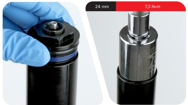
**28** Tragen Sie SRAM Butter-Schmierfett auf den Abstreifer des unteren Dichtkopfs auf und montieren Sie ihn auf der Zugstufen-Führungsstange, wobei die flache Seite des unteren Dichtkopfs zum Standrohr weisen muss. Schieben Sie den unteren Dichtkopf in das untere Ende des Standrohrs ein.
