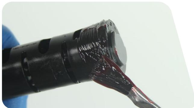
**9** 将压缩阻尼器插入上管。缓慢下压并左右转动阻尼器，直至装好。
