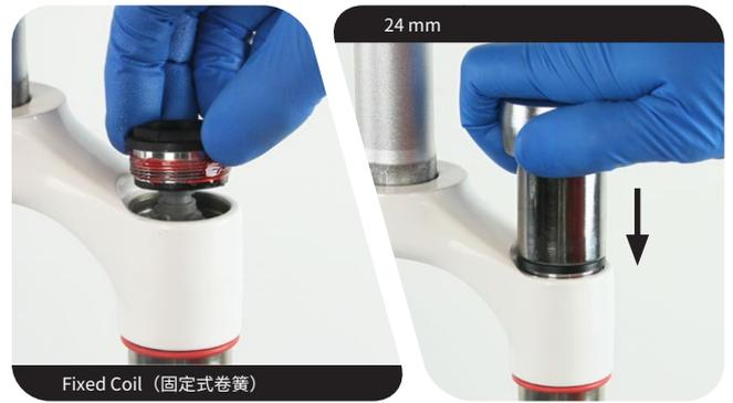
**Dual Position Coil™**：用手向下压顶盖，将其旋入上管。
