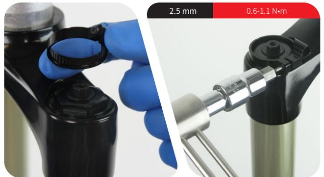
12 Crown Adjust (肩盖调节) - Recon Gold 和 Sektor Gold: 在顶盖锁止弹簧孔中涂抹少量润滑脂。将锁止弹簧安装到顶盖上。
