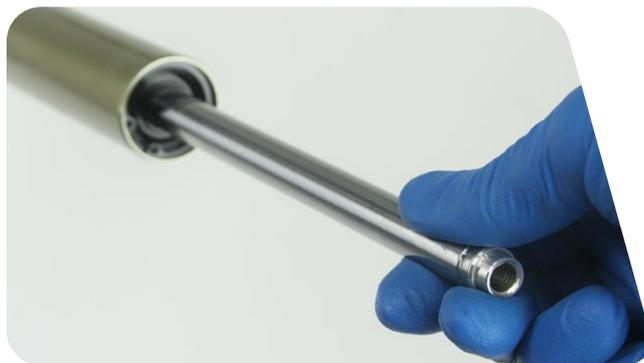
5 将 RockShox® 5wt 避震油倒入阻尼器侧上管内。
