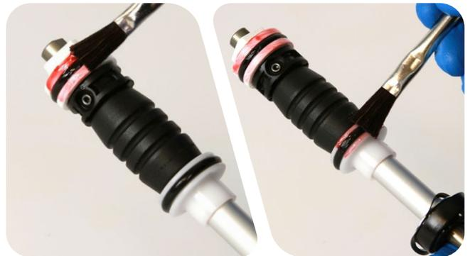
**4** 将空气弹簧组件插入上管。用力将正、负压空气活塞推入上管。
