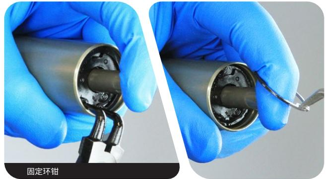
**3** 用力拉空气轴，从上管卸下空气弹簧组件。清洁并检查组件是否损坏。
