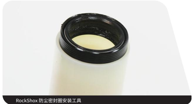
7 稳稳握住下管，将防尘密封圈均衡地推入下管，直至密封圈表面与下管顶部齐平。
