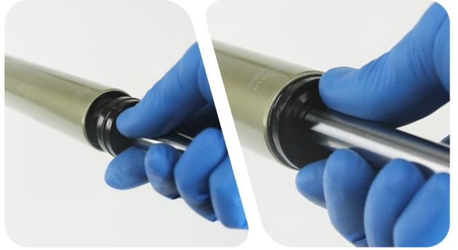
**2** 将回弹密封头推入上管，直到可见固定环槽。
