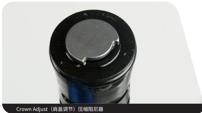
Crown Adjust (肩盖调节) 压缩阻尼器
