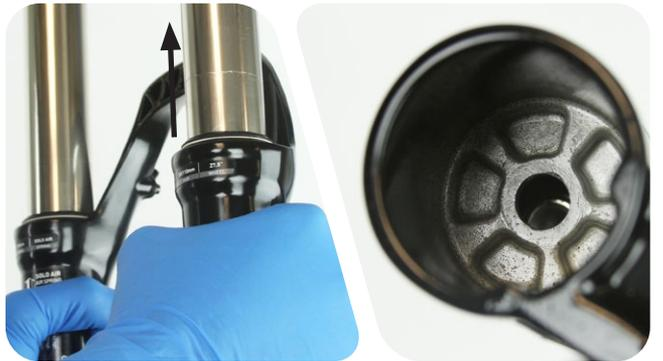
**3** 将前叉倾斜放置，底部螺栓孔朝上。分别向每支下管的底部螺栓孔注入 RockShox® 15wt 避震油。
