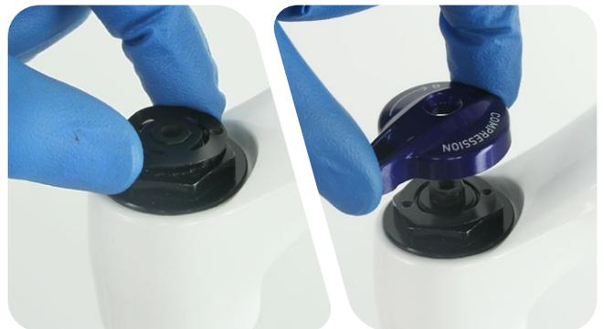
安装旋钮固定螺钉, 并拧紧至 1.35 N·m。
