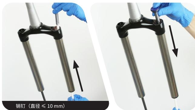
**5** 将回弹阻尼器活塞推入上管，直至活塞刚好位于上管螺纹的下方。
