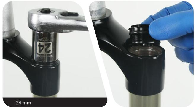
**2** 将空气轴推入上管，以防在拆卸固定环时刮伤空气轴。
