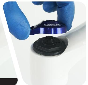
**Remote Adjust (线控调节) :** 卸下线控线轴固定螺钉和线控线轴。
