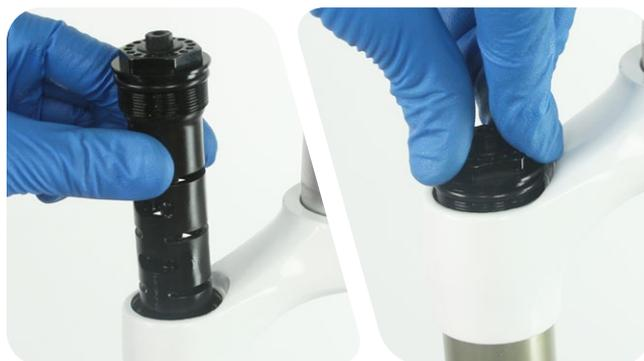
**Remote Adjust (线控调节) - 30 Gold:** 将线控线缆引导片朝向正面。用手将顶盖旋入上管内。
