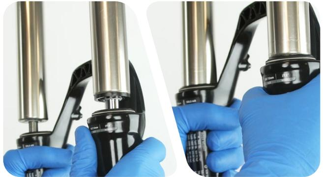
下管的内底部不应接触弹簧轴或阻尼轴。轴末端与下管螺栓孔之间应有明显的空隙。
