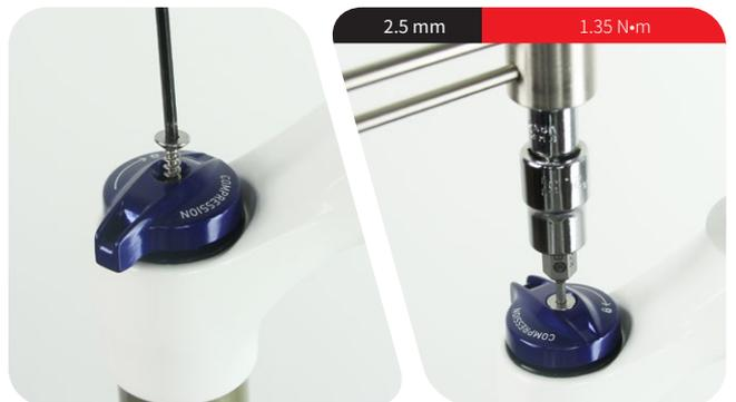
Remote Adjust (线控调节) : 安装线控线轴, 使线缆定位螺钉位于 7 点至 8 点钟的位置。
