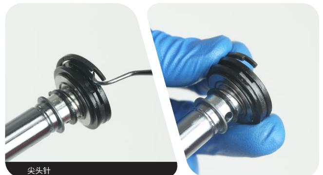
12 将密封头安装在回弹阻尼轴上。
