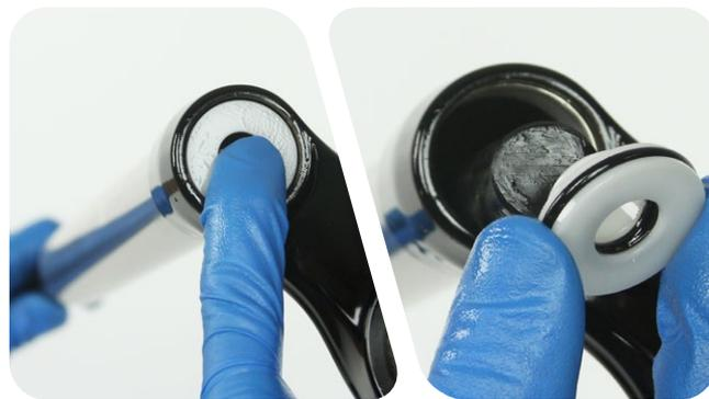
**10 Recon™ Silver 和 Sektor™ Silver:** 从密封头上卸下 O 型圈。将新的 O 型圈安装到密封头上。
