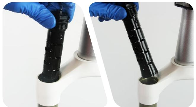
**30™ Gold Remote Adjust (线控调节) :** 从阻尼器卸下线缆引导片。
