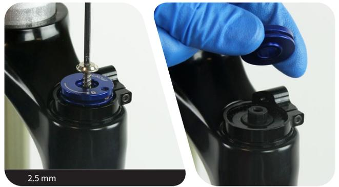
**Recon™ Gold 和 Sektor™ Gold:** 旋松线控线缆引导片的螺栓，然后卸下线缆引导片。
