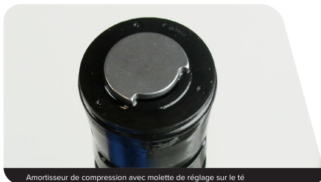
Amortisseur de compression avec molette de réglage sur le té
