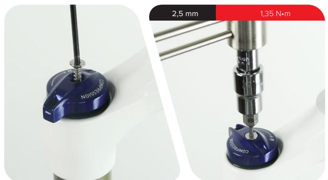
**Fernbedienter Einsteller:** Montieren Sie den Fernbedienungsring mit der Zugeinstellschraube in der 7- bis 8-Uhr-Position.
