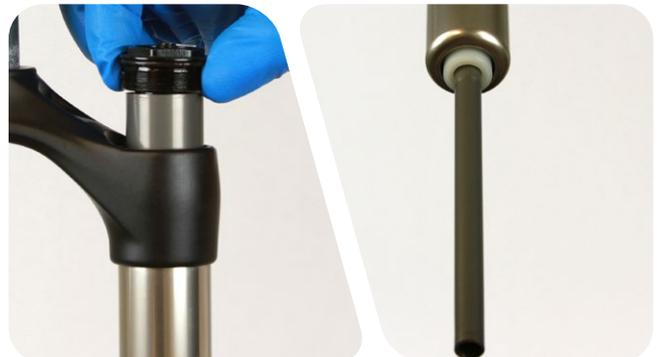
**9** Schrauben Sie die Abdeckkappe in das Standrohr.
