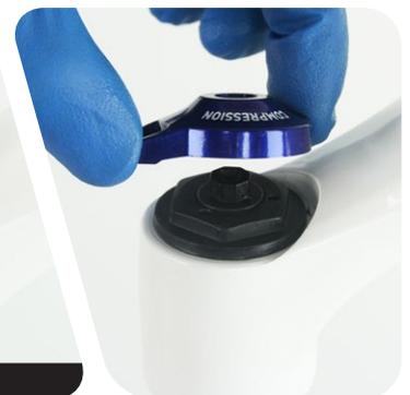
**Fernbedienter Einsteller:** Entfernen Sie die Befestigungsschraube des Fernbedienungsringes und den Fernbedienungsring.
