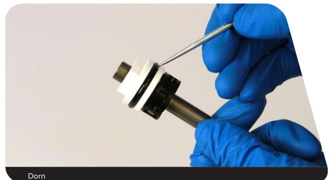
**7** Entfernen Sie den oberen Anschlagpuffer und das All-Travel-Distanzstück (falls montiert).
