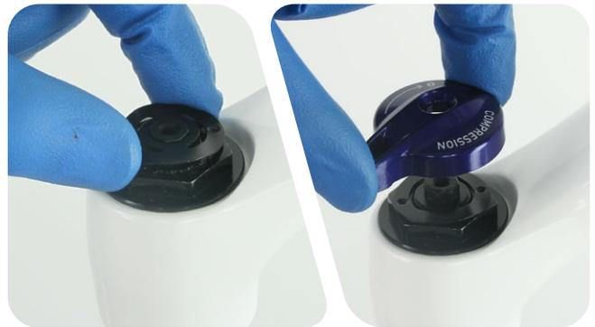
Bringen Sie die Schraube des Einstellrings an und ziehen Sie sie mit 1,35 N·m fest.
