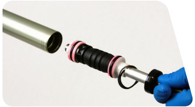
Setzen Sie die flache Grundplattenscheibe (A) und danach die Wellenscheibe (B) in das Standrohr ein.
