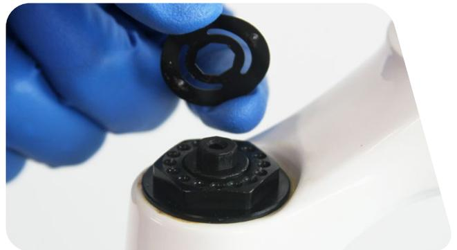
**1b Fernbedienter Einsteller:** Entfernen Sie die Befestigungsschraube und den Fernbedienungsring.
