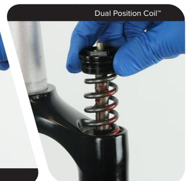
**4** Sprühen Sie Isopropyl-Alkohol auf die Feder und die Federführungsstange und reinigen Sie sie mit einem fusselfreien Lappen.
