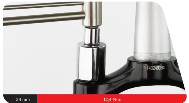
**5 Fixed Coil:** Bringen Sie den Vorspannungseinstellung an.
