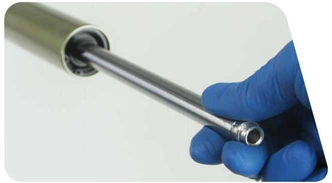
**5** Füllen Sie RockShox® 5 WT-Federungsöl in das Standrohr auf der Dämpferseite.
