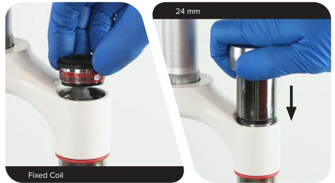
**Dual Position Coil™:** Drücken Sie die Abdeckkappe nach unten und schrauben Sie sie von Hand in das Standrohr.
