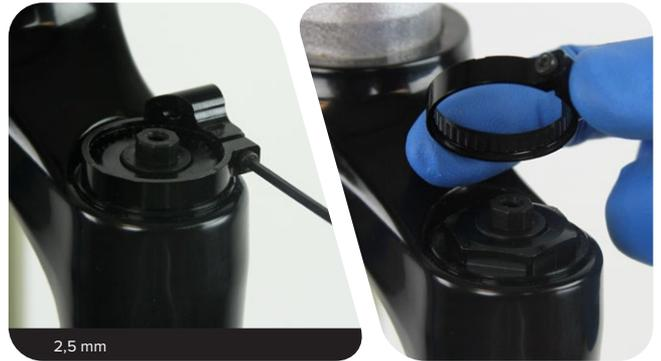
**2** Schrauben Sie die Abdeckkappe des Druckstufendämpfers ab.
