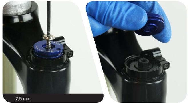
**Recon™ Gold und Sektor™ Gold:** Lösen Sie die Schraube der Fernbedienungs-Zugführung und entfernen Sie die Zugführung.
