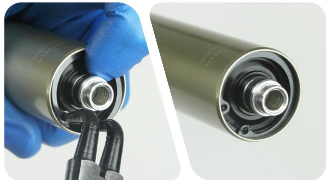
**4** Ziehen Sie die Zugstufendämpfer-Führungsstange in die vollständig ausgezogene Position aus.
