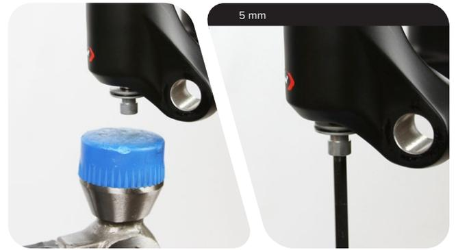
**6** Tirez fermement les fourreaux inférieurs vers le bas jusqu'à ce que l'huile commence à couler. Continuez à tirer les fourreaux inférieurs vers le bas afin de les retirer de la fourche.
