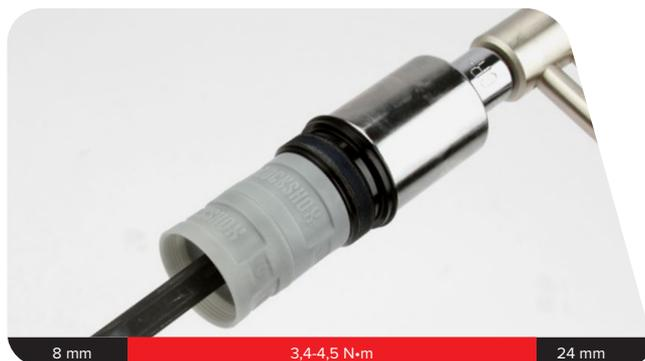
**Dual Position Air :** Au besoin, installez des Bottomless Tokens supplémentaires sur la came du ressort pneumatique DPA.
