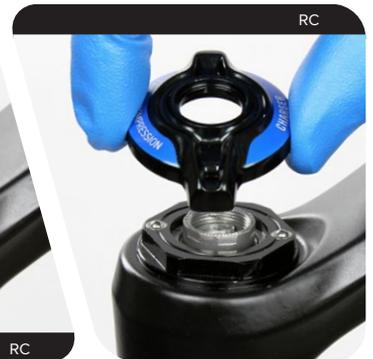
**3** À l'aide d'une clé à douille de 30 mm, desserrez le capuchon supérieur de l'amortisseur.
