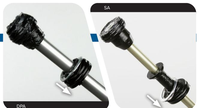
**8** **Dual Position Air** : Avec les doigts ou une pointe, retirez le joint torique externe du piston pneumatique. Avec une pointe, piquez le joint torique interne puis retirez-le.
