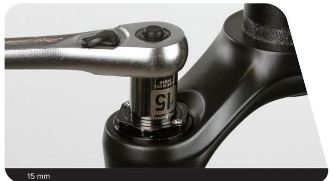
**5 RCT3 :** Mettez en place la molette de réglage du mode de compression sur le capuchon supérieur de compression en veillant à ce que la longue languette soit tournée vers l'**avant** du té. Tournez la molette **dans le sens des aiguilles d'une montre** jusqu'à ce qu'elle s'enclenche dans le premier cran.
