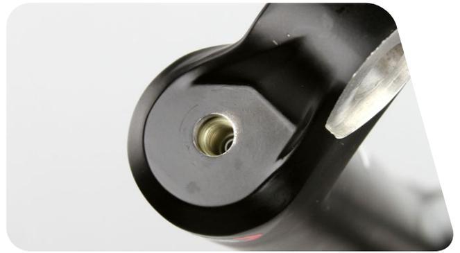
**6** À l'aide d'une pointe et d'une pince à bec fin, retirez les anciennes rondelles d'écrasement de chaque boulon inférieur.
