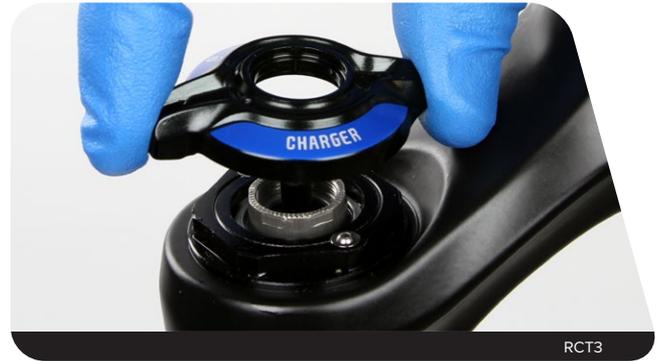
**RC** : À l'aide d'une clé hexagonale de 4 mm, retirez l'écrou de blocage de la molette. Retirez la molette de réglage de compression basse vitesse.
