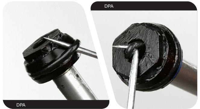
**Solo Air** : Avec les doigts ou une pointe, retirez le joint de section carrée du piston pneumatique.
