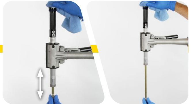
**5** Remplissez la seringue de purge RockShox Charger à moitié avec de l'huile de suspension 3wt, puis vissez la seringue et l'embout de la durite Charger dans l'unité du capuchon supérieur de compression.
