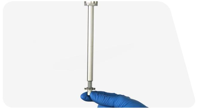
**4** Recouvrez le capuchon supérieur d'un chiffon et actionnez la came de l'amortisseur du rebond à plusieurs reprises pour pré-purger l'air présent dans l'amortisseur.
