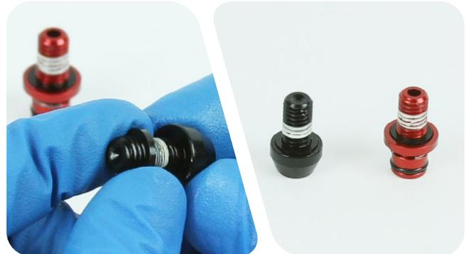
**7** Vissez le boulon inférieur de couleur noire dans le fourreau inférieur du côté du ressort. Vissez le boulon inférieur de couleur argentée dans le fourreau inférieur du côté de l'amortisseur.
