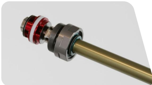
**9** Avec les doigts, retirez la bague de coulissage hors du piston de l'amortisseur du rebond.
