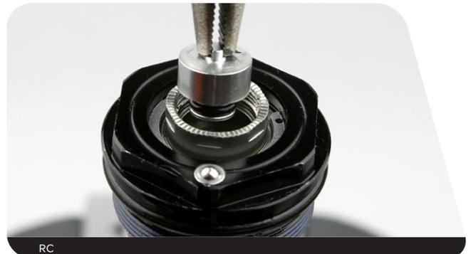
**3** Avec les doigts, installez le boulon inférieur dans la came de l'amortisseur du rebond, puis tirez sur le boulon inférieur vers le bas.
