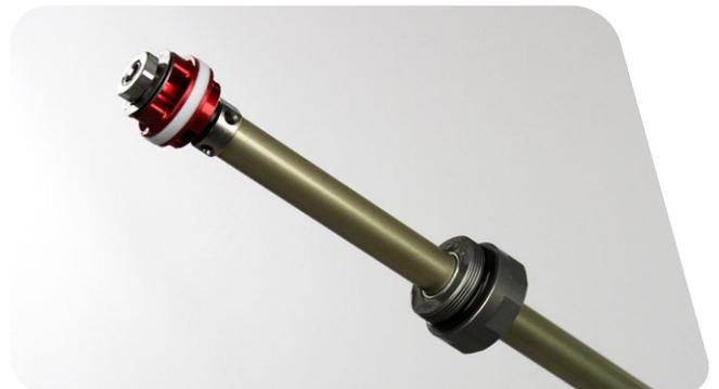
**8** Appliquez de la graisse SRAM Butter sur les joints **neufs** de la tête d'étanchéité de l'amortisseur du rebond.
