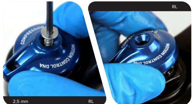
**1b** **Rappel à distance RL** : appuyez sur le rapel à distance pour le mettre en position ouverte. Retirez la vis de maintien, la bobine du câble et le câble. Desserrez le boulon du collier d'arrêt du câble du rappel à distance. Retirez le collier d'arrêt du câble.
