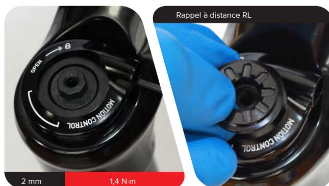
Installez la partie supérieure de la bobine du câble en vous assurant que le point indicateur situé sur la bobine du câble se trouve entre les deux repères imprimés sur l'arrêt du câble. Mettez la vis de fixation en place puis serrez-la.
