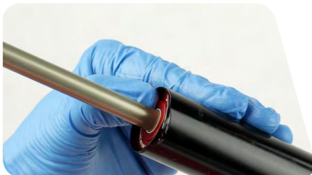
**17** Les circlips ont un côté avec un angle acéré et un autre avec un angle arrondi. Installez les circlips de sorte que le côté avec l'angle acéré soit orienté vers l'outil pour faciliter l'installation et le démontage.
