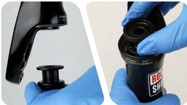
**4** Faites tremper les bagues en mousse neuves dans de l'huile de suspension RockShox. Installez les bagues en mousse neuves dans les fourreaux.
