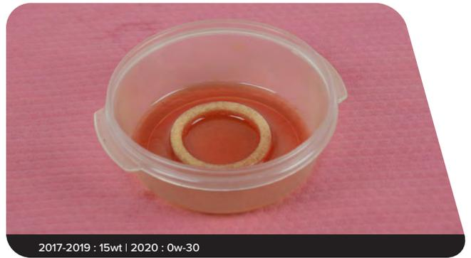
**4** Nettoyez l'intérieur et l'extérieur des fourreaux. Nettoyez les joints anti-poussière.
