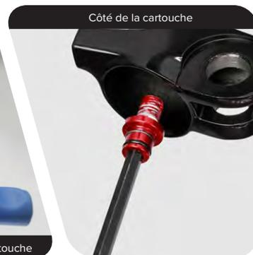
**11** Tirez fermement les fourreaux vers le bas jusqu'à ce que le liquide commence à en couler. Tirez les fourreaux vers le bas pour les retirer de la fourche.
