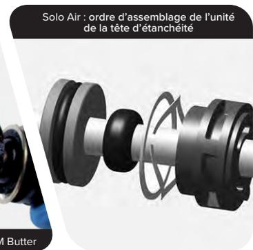
**16** Insérez l'unité du ressort pneumatique à l'intérieur du plongeur. Enfoncez fermement le piston pneumatique dans le plongeur.
