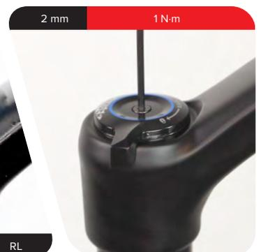
**4 RLC** : installez la molette de réglage du verrouillage sur le capuchon supérieur de manière à ce que la molette passe de la position ouverte à la position fermée.
