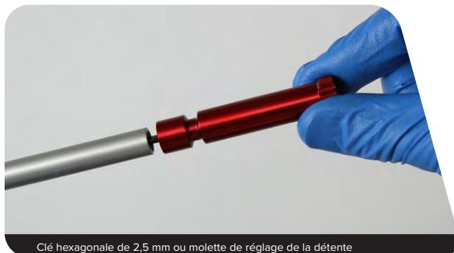
Clé hexagonale de 2,5 mm ou molette de réglage de la détente
