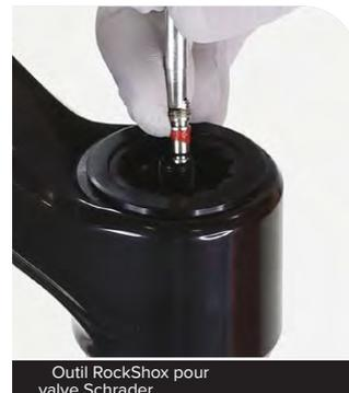
**3** Les chambres du ressort à air positive et négative **doivent être TOTALEMENT dépressurisées** avant de retirer l'unité du capuchon supérieur du ressort à air.
