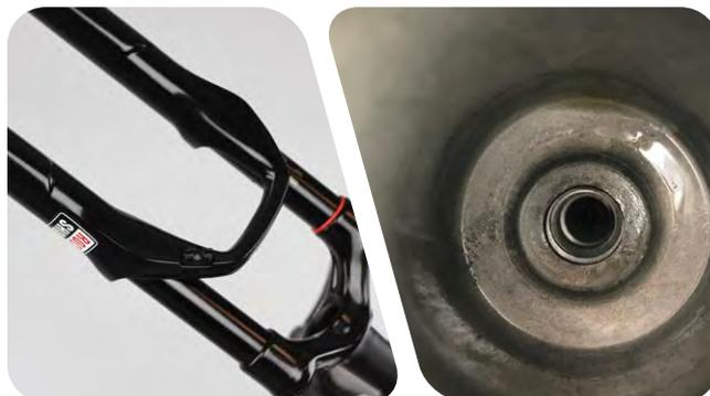
**6** **Entretien 200 heures uniquement :** à l'aide d'une pointe et d'une pince à bec fin, retirez les anciennes rondelles d'écrasement de chaque boulon inférieur.
