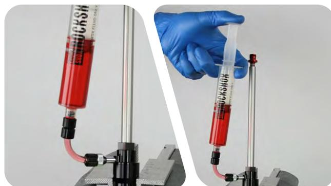
**10** Enfoncez la came de la cartouche de détente. Maintenez la pression sur le piston de la seringue tant qu'elle se remplit d'huile. Tirez lentement la came de la cartouche de détente vers le haut. Maintenez la pression sur le piston de la seringue tant que le système se remplit d'huile.
