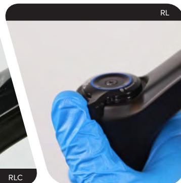
**2a Molette de réglage sur le té :** retirez la molette de verrouillage et de compression basse vitesse située sur le capuchon supérieur. Conservez les pièces ensemble et mettez-les de côté.
