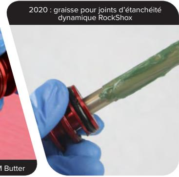
**Solo Air :** installez la tête d'étanchéité flottante, la butée de talonnage de la tête d'étanchéité flottante, la rondelle de maintien en aluminium, la rondelle ondulée et le guide de la came pneumatique sur la came pneumatique, dans cet ordre.
