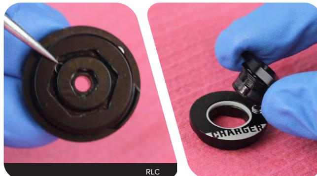
Retirez la bague de coulissage située sur la bobine. Appliquez de la graisse sur la bague de coulissage neuve puis installez-la.
