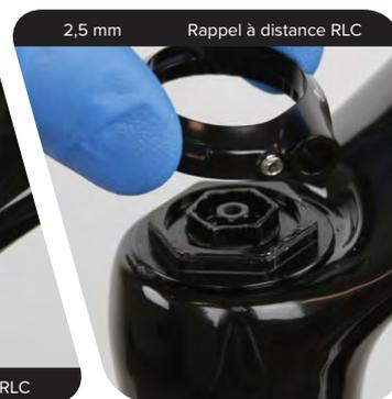
**2c** **Rappel à distance** : retirez le collier d'arrêt du câble. Retirez la bobine.
