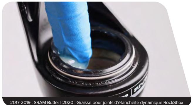
2017-2019 : SRAM Butter | 2020 : Graisse pour joints d'étanchéité dynamique RockShox
