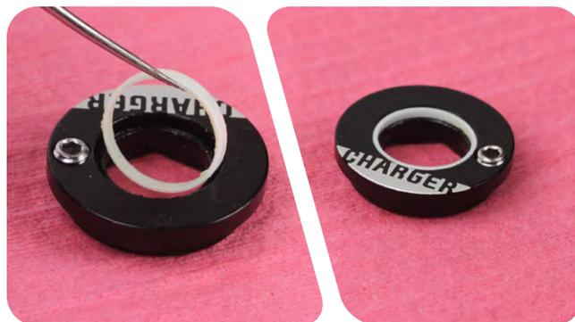
Appliquez de la graisse sur la molette de réglage de compression basse vitesse. Appuyez sur le renflement de la bille de détente afin d'installer la molette de compression basse vitesse dans la bobine. Tournez la molette de 8 à 10 clics à partir de la position ouverte.
