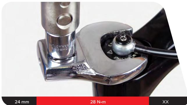
**20 RL :** installez la molette de réglage du verrouillage sur le capuchon supérieur de manière à ce que la molette passe de la position ouverte à la position fermée.
