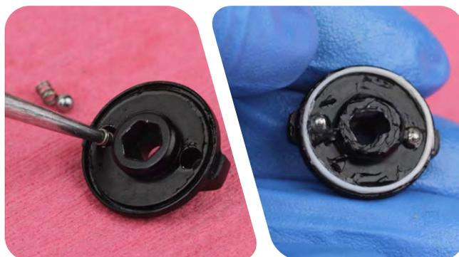
Mettez en place la molette de compression basse vitesse sur la molette de verrouillage. Mettez la vis de maintien en place puis serrez-la.
