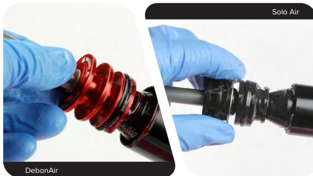
**17** Los anillos de retención tienen un lado recto y otro redondeado. Si coloca los anillos de retención con el lado recto apuntando hacia la herramienta, le resultará más fácil instalarlos y retirarlos.
