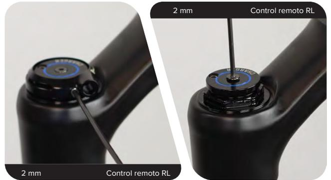
**3** Retire el conjunto del Charger 2 Damper. Limpie las roscas del tubo superior.
