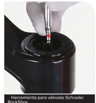
**3** Las cámaras positiva y negativa del resorte neumático **deben estar TOTALMENTE despresurizadas** antes de retirar el conjunto de la tapa superior del resorte neumático.
