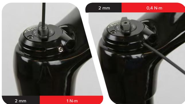
**4 Control remoto RL:** Instale la parte superior del carrete del cable.
