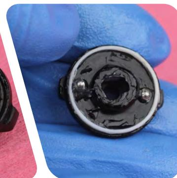
Instale el mando de compresión de baja velocidad en el mando de bloqueo. Instale y apriete el tornillo de retención.
