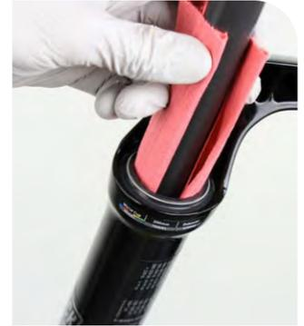
Sustituya la junta tórica o de estanqueidad por otra nueva del kit de mantenimiento. Utilice los dedos o un punzón para perforar y retirar la junta tórica o de estanqueidad antiguas.
