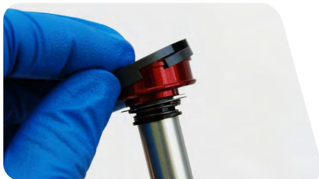
**12** Instale el cabezal de sellado en el eje del amortiguador.
