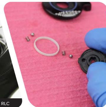
Instale un muelle en cada orificio de la parte inferior del mando de compresión de baja velocidad. Coloque una bola de retención encima de cada muelle. Instale un anillo deslizante nuevo en la ranura.
