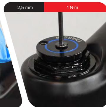
Instale el collarín de tope del cable. Enrosque a mano el perno del collarín de tope del cable y después apriételo. Consulte el manual de usuario del control remoto para obtener instrucciones sobre la instalación del cable.
