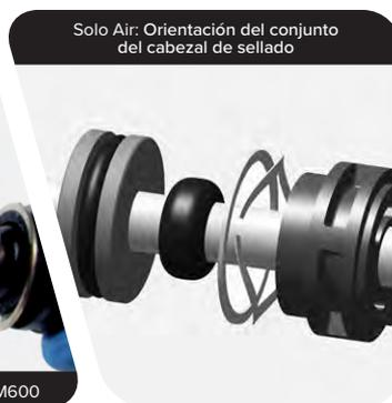
**16** Inserte el conjunto de resorte neumático en el tubo superior. Empuje firmemente el pistón neumático dentro del tubo superior.
