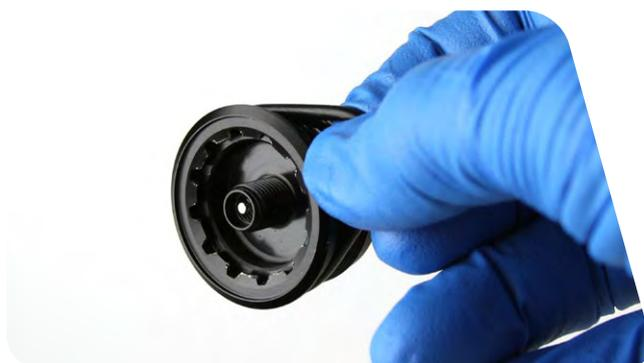
6 Retire la amortiguación inferior exterior de rebote del eje neumático.
