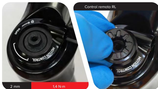
Instale la parte superior del carrete del cable de forma que el punto indicador del carrete quede dentro de la marca impresa en el tope del cable. Instale y apriete el tornillo de fijación.
