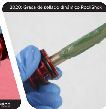
**Solo Air:** Instale el cabezal del sellado flotante, la amortiguación superior exterior del cabezal de sellado flotante, la arandela de apoyo de aluminio, la arandela ondulada y la guía del eje neumático, en este orden, en el eje neumático.
