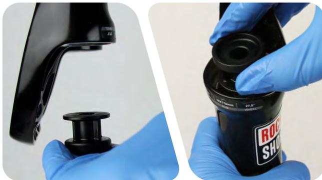
**4** Empape los nuevos anillos de gomaespuma nuevos en aceite para suspensiones RockShox. Instale los anillos de gomaespuma nuevos en el brazo inferior.
