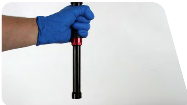
**10** Retire el tubo del tornillo de banco. Oriente el tubo del cartucho hacia abajo y apriete la cámara flexible hasta que caiga el limpiador y cualquier resto de aceite en un recipiente para recogerlo.
