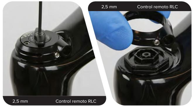
**2c Control remoto:** Retire el collarín de tope del cable. Retire el carrete.
