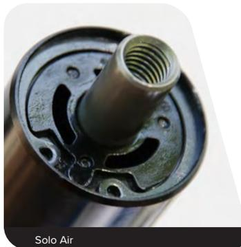
**18** Instale la amortiguación inferior exterior de rebote en el eje neumático.
