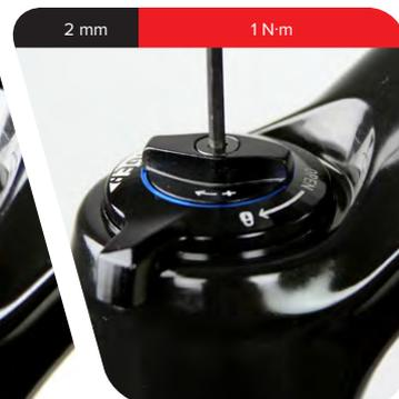
**Mantenimiento cada 200 horas** Siga con [Instalación del brazo inferior](#) cada 200 horas.
