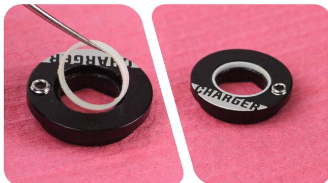
Aplique grasa al mando del ajustador de compresión de baja velocidad. Presione hacia abajo el saliente del anillo de retención para instalar el mando de compresión de baja velocidad en el carrete. Gire el mando 8-10 clics desde su posición abierta.
