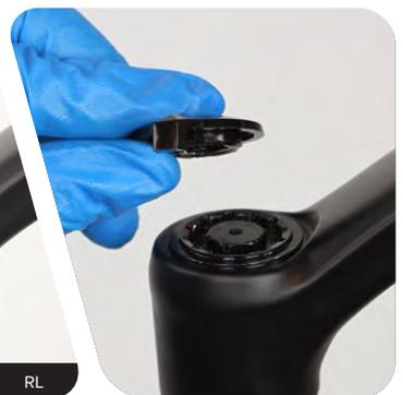
**2b Control remoto:** Retire el mando del ajustador de compresión de baja velocidad y el conjunto del carrete. Retire el collarín de tope del cable. Coloque las piezas juntas y déjelas a un lado.
