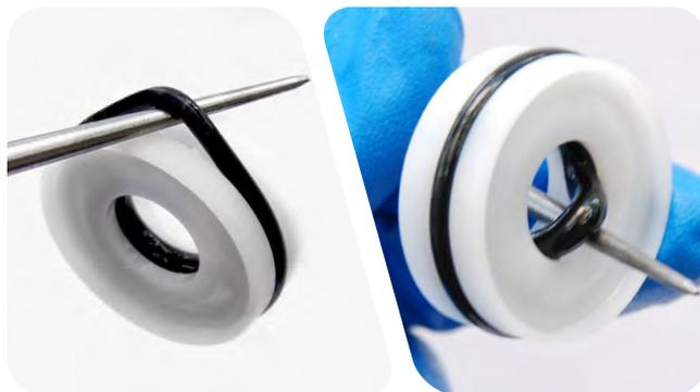
**11** Retire el anillo deslizante del pistón e instale uno nuevo.
