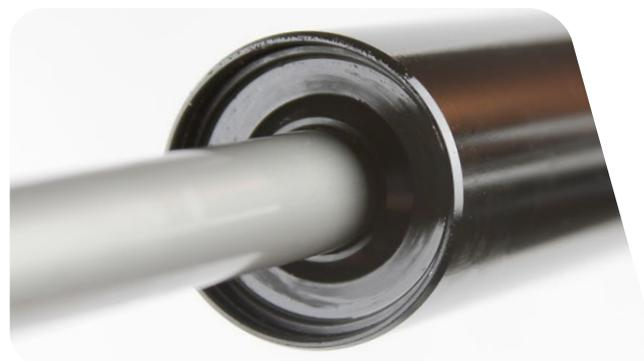
**13** Les anneaux de blocage ont un côté avec un angle acéré et un autre avec un angle arrondi. Installez les anneaux de blocage en faisant en sorte que le côté avec l'angle acéré soit orienté vers l'outil pour faciliter l'installation et le démontage.
