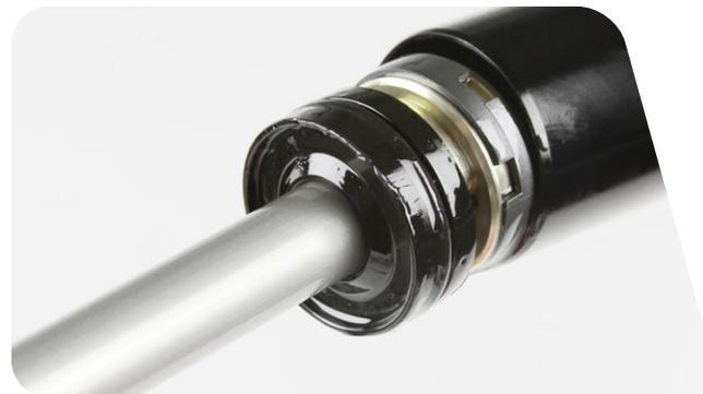
**12** Repoussez la tête d'étanchéité du rebond dans le tube supérieur jusqu'à faire apparaître la cannelure de l'anneau de blocage.
