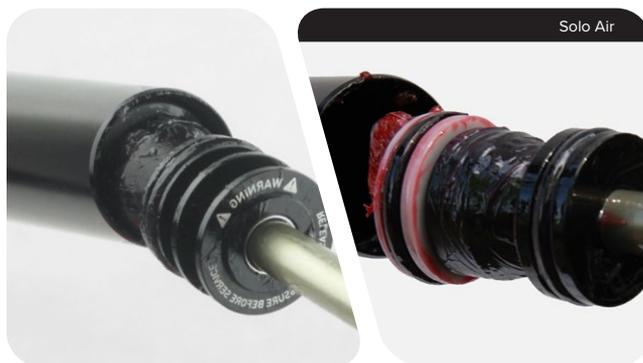
**17** Les circlips ont un côté avec un angle acéré et un autre avec un angle arrondi. Installez les circlips de sorte que le côté avec l'angle acéré soit orienté vers l'outil pour faciliter l'installation et le démontage.
