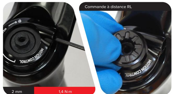
Installez la partie supérieure de la bobine du câble en vous assurant que le point indicateur situé sur la bobine du câble se trouve entre les deux repères imprimés sur l'arrêt du câble. Mettez la vis de fixation en place puis serrez-la.
