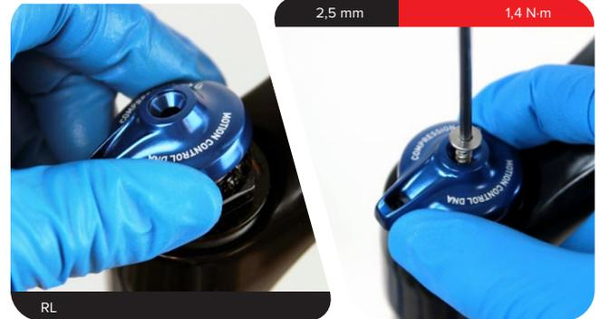
**21b** **Commande à distance RL** : installez le collier d'arrêt du câble.
