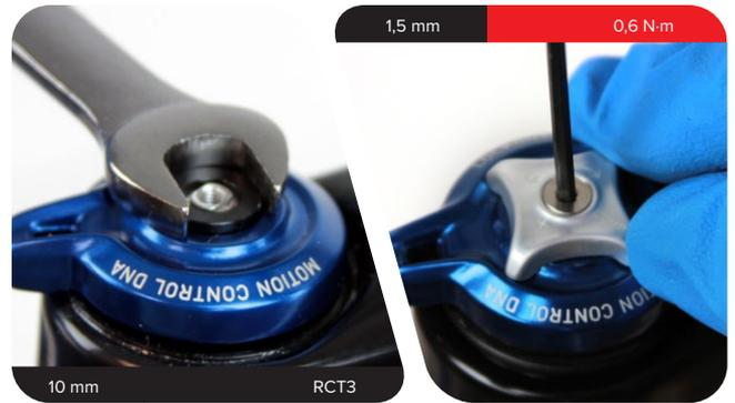
**RL** : installez la molette de réglage du verrouillage sur le capuchon supérieur de manière à ce que la molette passe de la position ouverte à la position fermée.
