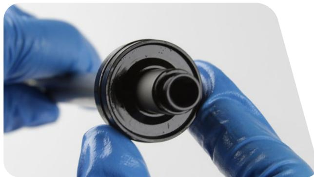
**11** Insérez en biais le piston de l'amortisseur de rebond dans la base du tube supérieur. Insérez en premier le côté opposé à la bague de coulissage. Tout en maintenant le piston de biais, faites-le tourner jusqu'à ce que la bague de coulissage entre dans le tube supérieur.
