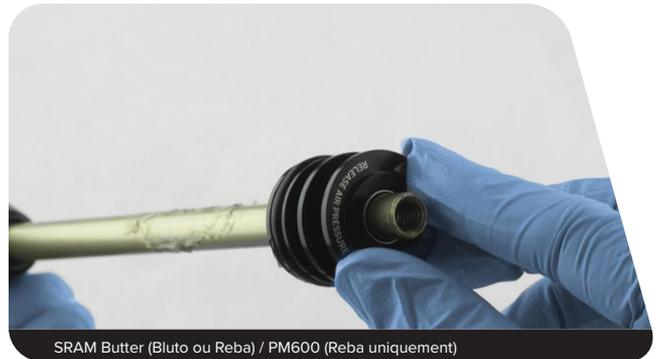
**Solo Air:** installez la tête d'étanchéité flottante, la butée de talonnage de la tête d'étanchéité flottante, la rondelle de maintien en aluminium, la rondelle ondulée et le guide de la came pneumatique sur la came pneumatique, dans cet ordre.
