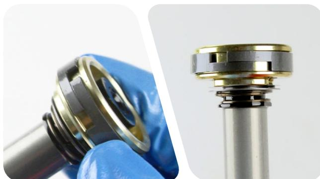
**10** Mettez la tête d'étanchéité en place sur la came de l'amortisseur.
