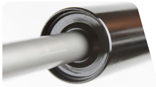
**13** Sicherungsringe haben jeweils eine Seite mit einer eckigen und einer runden Kante. Bauen Sie Sicherungsringe so ein, dass die eckige Kante zum Werkzeug weist. Das vereinfacht den Ein- und Ausbau.
