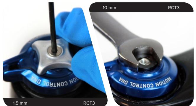
**1b RL Remote:** Drücken Sie den Fernbedienungshebel in die offene Position. Entfernen Sie die Befestigungsschraube, den Zugring und den Zug. Lösen Sie die Klemmschraube des Fernbedienungszug-Anschlagrings. Entfernen Sie den Zuganschlagring.
