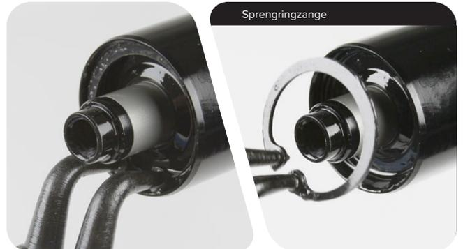
**5** Entfernen Sie den Zugstufendämpfer und den Dichtkopf.
