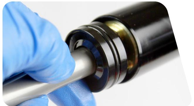
**6** Reinigen Sie die Innen- und Außenseite des Standrohrs.
