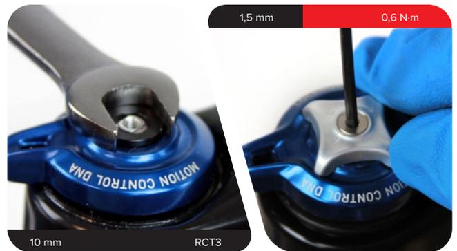
**RL:** Montieren Sie den Sperren-Einstellung so auf der Abdeckkappe, dass der Einstellring sich von der offenen in die geschlossene Position dreht.
