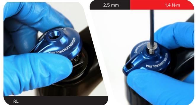
**21b RL Remote:** Bringen Sie den Zuganschlagring an.
