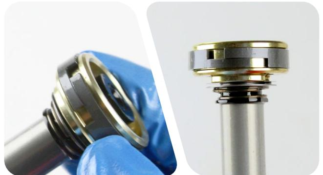
**10** Montieren Sie den Dichtkopf auf der Führungsstange.
