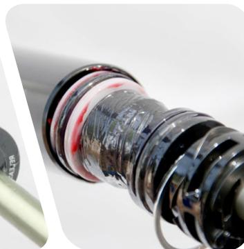
**9** Reinigen Sie die Innen- und Außenseite des Standrohrs. Überprüfen Sie die Innen- und Außenseite des Standrohrs auf Beschädigungen.
