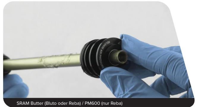
**Solo Air:** Bringen Sie nacheinander den schwimmenden Dichtkopf, den oberen Anschlagpuffer des schwimmenden Dichtkopfs, die Aluminium-Haltescheibe, die Wellenscheibe und die Luftführungsstangen-Führung auf der Luftführungsstange an.
