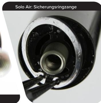
**8** Ziehen Sie kräftig an der Luftführungsstange, um die Luftfeder-Baugruppe aus dem Standrohr zu ziehen. Reinigen und prüfen Sie die Baugruppe auf Beschädigungen.
