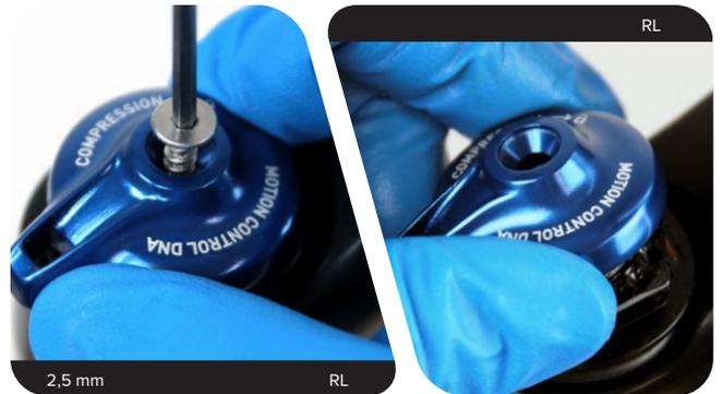
**RCT3:** Entfernen Sie die Feststellschraube, die Mutter und den Einsteller.
