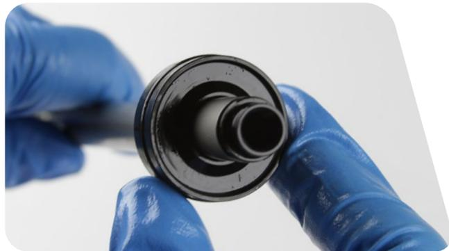
**11** Führen Sie den Zugstufendämpferkolben schräg in die Unterseite des Standrohrs ein; schieben Sie dabei die Seite gegenüber vom Gleitringspalt zuerst in das Standrohr. Bewegen und drehen Sie den Kolben weiter, bis sich der Gleitring im Standrohr befindet.
