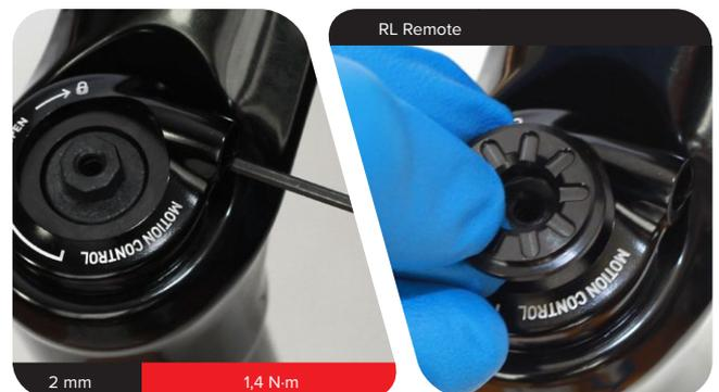
Setzen Sie den Zugringanschlag so ein, dass der Punkt auf dem Zugring innerhalb der auf dem Zuganschlag aufgedruckten Bereichsmarkierung liegt. Bringen Sie die Feststellschraube an und ziehen Sie sie fest.
