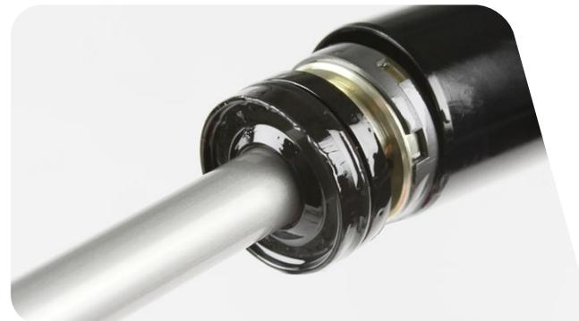
**12** Schieben Sie den Zugstufendichtkopf in das Standrohr, bis die Sicherungring-Nut zu sehen ist.
