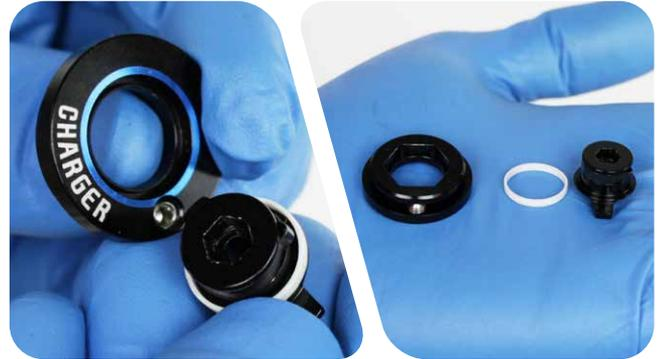
Instale el carrete del control remoto en el ajustador hexagonal con el tornillo de sujeción del cable del carrete orientado dentro de la zona de 87°.
