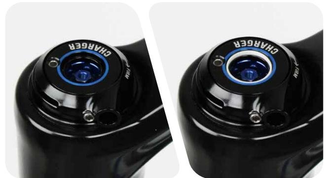
Instale el mando del regulador de baja velocidad en el ajustador hexagonal. Instale y apriete el tornillo de retención del mando.
