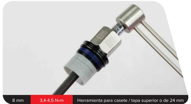
**Dual Position Air:** Instale los elementos Bottomless Token que desee en el eje del muelle neumático de DPA.
