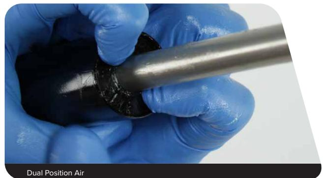
**7** Los anillos de retención tienen un lado recto y otro redondeado. Si coloca los anillos de retención con el lado recto apuntando hacia la herramienta, le resultará más fácil instalarlo y retirarlo.
