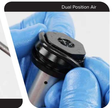
**DebonAir:** Retire la junta de anillo cuádruple del pistón neumático y deséchela.
