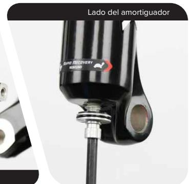
**9** Golpee cada perno inferior para sacar los ejes de cada lado del brazo inferior. La cabeza del perno debe entrar en contacto con la parte de abajo del brazo inferior.
