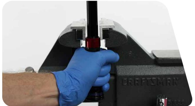
**11** Retire el tubo del tornillo de banco. Oriente el tubo del cartucho hacia abajo y apriete la cámara flexible hasta que caiga el limpiador y cualquier resto de aceite en un recipiente para recogerlo.
