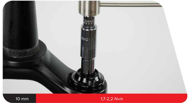
**12** Instale el obús de la válvula Schrader en la tapa superior y apriételo con los dedos.
