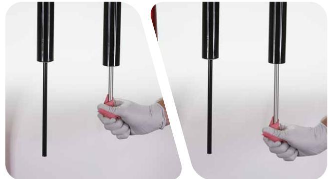
**4 Dual Position Air:** Retire la tuerca de retención del mando del regulador de recorrido.
