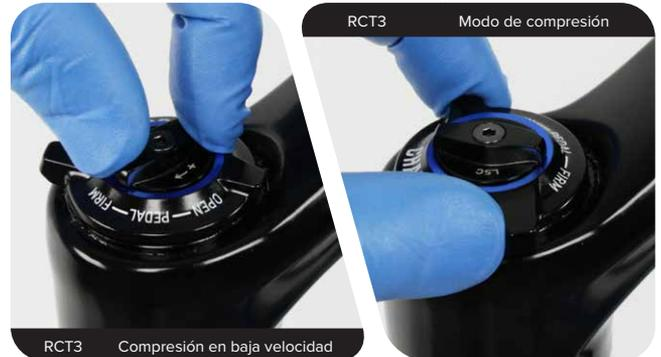
**RCT R:** Gire a tope el mando del regulador de compresión de baja velocidad en sentido antihorario hasta la posición de apertura total.
