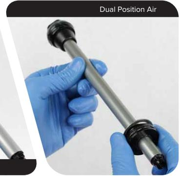
**5** Aplique grasa a las juntas tóricas y de estanqueidad exteriores del pistón neumático y el cabezal de sellado.
