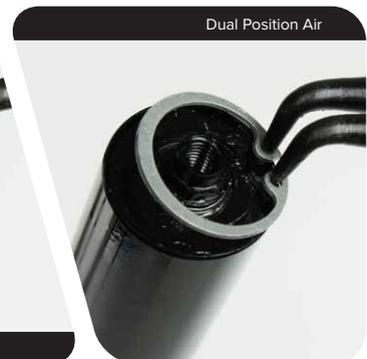
**DebonAir:** Empuje firmemente el eje neumático dentro del tubo superior con el pulgar. Empuje la pestaña del cabezal de sellado (A) hacia dentro del tubo superior y por debajo del anillo de retención.
