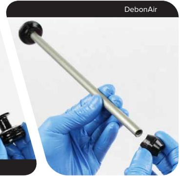
**10 Dual Position Air:** Retire las juntas tóricas interior y exterior del pistón neumático y deséchelas. Limpie el pistón neumático.
