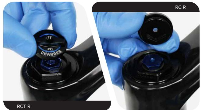
**5** Desenrosque la tapa superior del amortiguador y retire el conjunto del amortiguador Charger 2.
