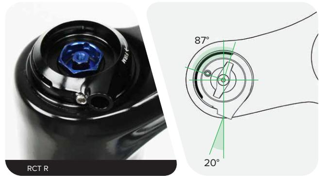
Empuje hacia dentro el retenedor del muelle del mando del regulador de baja velocidad (A) y empuje el mando para sacarlo del carrete del control remoto.
