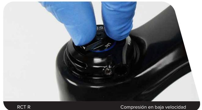
**RC:** Gire a tope el mando del regulador de compresión en sentido antihorario hasta la posición de apertura total.
