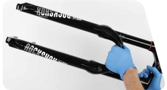
El muelle y los ejes del amortiguador deben poder verse a través de los orificios de los pernos inferiores.
