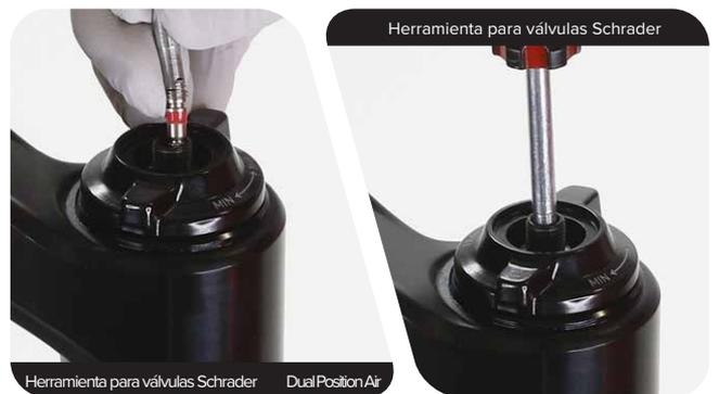
**Mantenimiento cada 200 horas** Para continuar con el mantenimiento del amortiguador Lyrik, vaya al apartado [Mantenimiento del amortiguador Charger 2](#).
