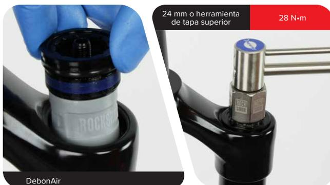
**11 Dual Position Air:** Coloque el mando del regulador en la tapa superior, con la pestaña larga cerca de la parte posterior de la corona. Gire el mando regulador en sentido antihorario hasta que encaje en el primer espacio de enclavamiento.
