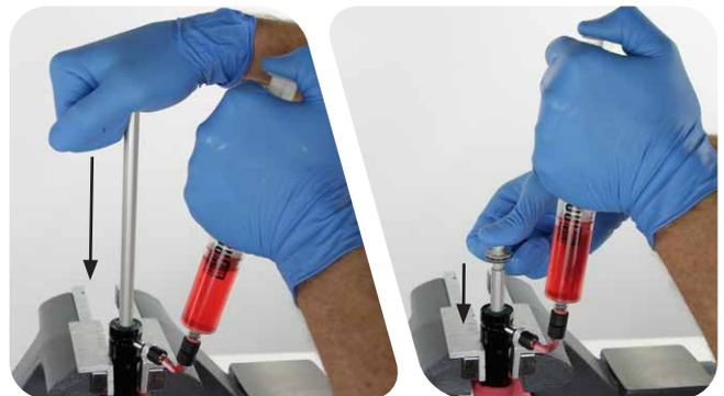
Tire despacio del eje del amortiguador de rebote para extraerlo del tubo del cartucho a la vez que aplica presión en sentido contrario al émbolo de la jeringuilla mientras el amortiguador se va llenando de aceite.
