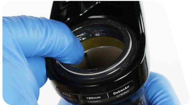
**3** Instale el conjunto del brazo inferior en los tubos superiores y deslícelo lo justo para encajar los cojinetes superiores con los tubos superiores.
