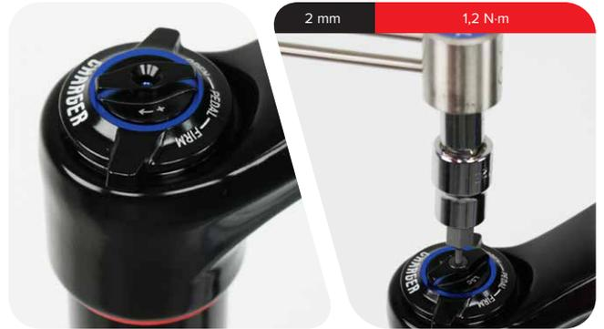
**RC:** Instale el mando del regulador de compresión en la tapa superior con la pestaña hacia adelante, en la posición desbloqueada.
