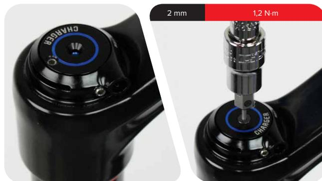
**4** **RCT R / RC R:** Apriete el tornillo de sujeción del collarín de tope del cable.
