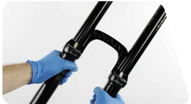
El fondo interior del brazo inferior no debe llegar a tocar con el muelle ni con los ejes del amortiguador. Debe quedar visible un hueco entre los extremos del eje y los orificios de los pernos del brazo inferior.
