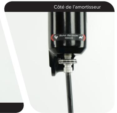
**5** Tapez sur chaque boulon inférieur pour déloger les deux cames des fourreaux inférieurs. La tête du boulon doit toucher la base du fourreau inférieur.
