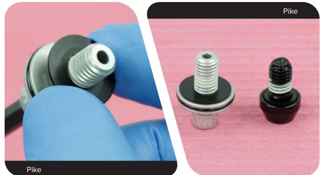
**7** Mettez le boulon inférieur de couleur noire en place sur la came du côté du ressort.
