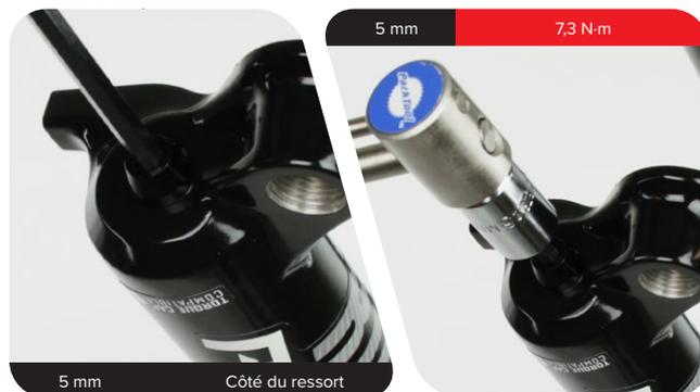
**8** Installez la molette de l'amortisseur du rebond puis serrez la vis de fixation.
