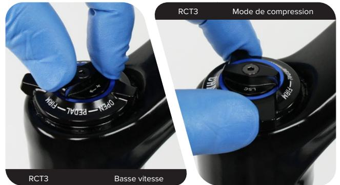
**RCT R** : tournez la molette de réglage de la compression basse vitesse dans le sens inverse des aiguilles d'une montre, en position d'ouverture maximale, jusqu'à ce qu'elle se bloque.
