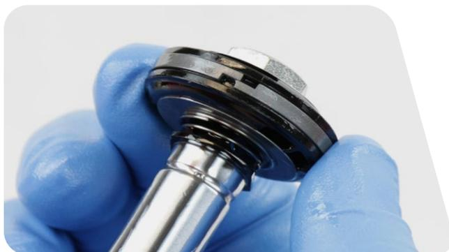
**5** Installez la tête d'étanchéité sur la came de l'amortisseur du rebond.
