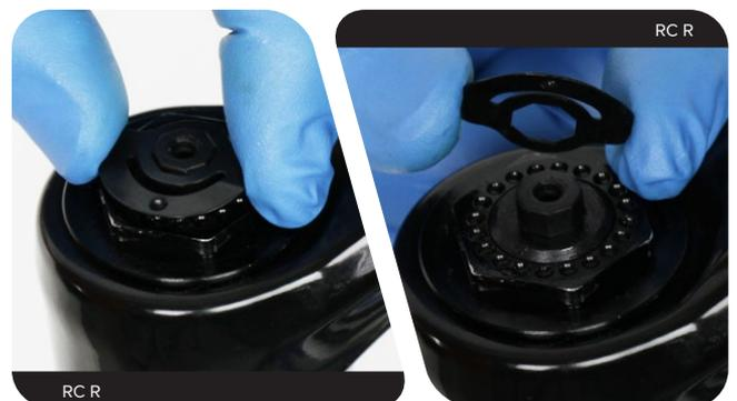
**4** RC R : desserrez la vis de fixation puis retirez le collier d'arrêt du câble.
