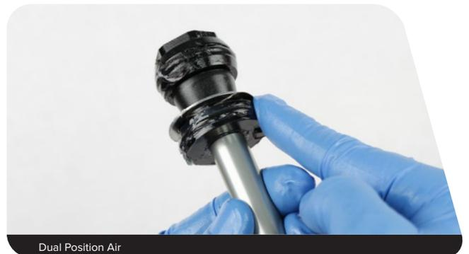
**6** Insérez l'unité du ressort pneumatique à l'intérieur du tube supérieur. Enfoncez fermement le piston pneumatique dans le tube supérieur.
