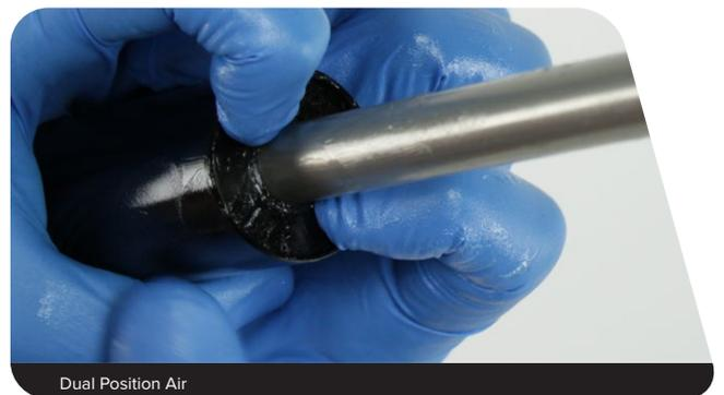
**7** Les anneaux de blocage ont un côté avec un angle acéré et un autre avec un angle arrondi. Installez les anneaux de blocage en faisant en sorte que le côté avec l'angle acéré soit orienté vers l'outil pour en faciliter l'installation et le démontage.
