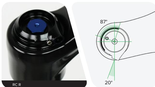
Installez la bobine de la commande à distance sur la tige de réglage hexagonale de manière à ce que la vis de fixation du câble de la bobine se trouve dans la zone à 87°.
