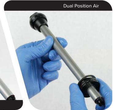
**5** Appliquez de la graisse sur le piston pneumatique et sur les joints/joints toriques externes de la tête d'étanchéité.
