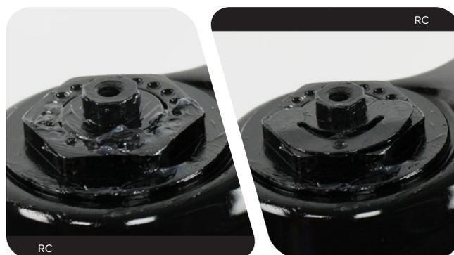
**6a** **RC** : mettez la molette de réglage en place avec la languette tournée à 7 ou 8 heures en position déverrouillée.
