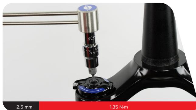
**6b RC R :** mettez le collier d'arrêt du câble en place avec le guide de la gaine tourné vers l'avant à 6 heures, en respectant un angle d'environ 20 à 30° par rapport au centre.
