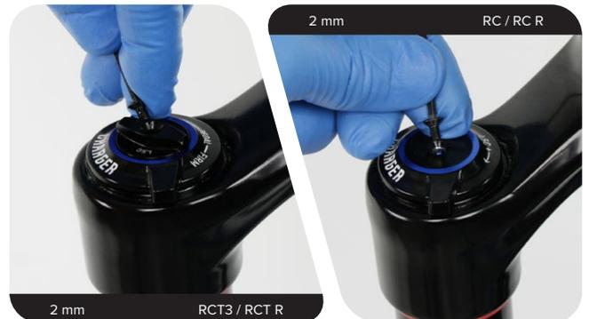
**3** **RCT R / RC R** : desserrez la vis de fixation du collier d'arrêt du câble de la commande à distance, puis retirez le collier.
