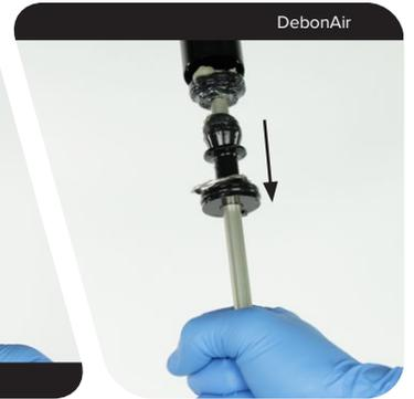
**6** Retirez la tête d'étanchéité, le ressort ondulé, la rondelle de blocage et la butée de talonnage situés sur la came du ressort pneumatique.
