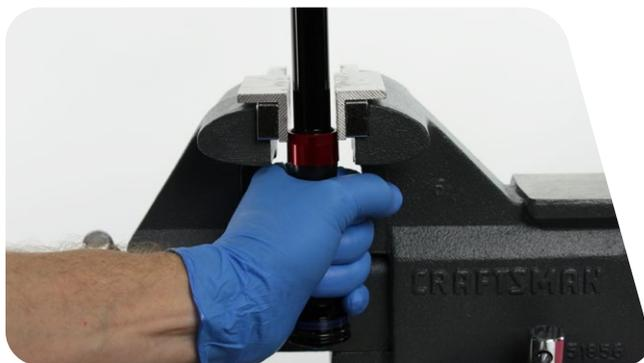
**11** Retirez le tube hors de l'étau. Tournez le tube la tête en bas et pressez la vessie jusqu'à ce que tout le produit de nettoyage et toute l'huile restante se soient écoulés dans le récipient prévu à cet effet.
