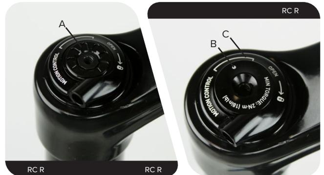
Mettez la vis de blocage de la bobine en place puis serrez-la jusqu'à ce qu'elle touche la bobine supérieure. Ne serrez pas la vis à fond.
