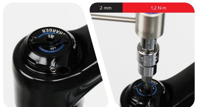
**RC R** : mettez le collier d'arrêt du câble en place avec le guide de la gaine tourné vers l'avant à 6 heures, en respectant un angle d'environ 20 degrés par rapport au centre.
