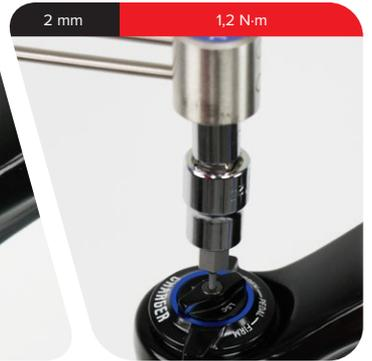
**RC** : mettez la molette de réglage de compression sur le capuchon supérieur avec la languette tournée vers l'avant en position déverrouillée.
