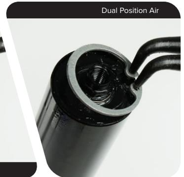
**DebonAir** : avec votre pouce, enfoncez fermement la came pneumatique dans le tube supérieur. Poussez la languette de la tête d'étanchéité (A) à l'intérieur du tube supérieur et sous l'anneau de blocage.
