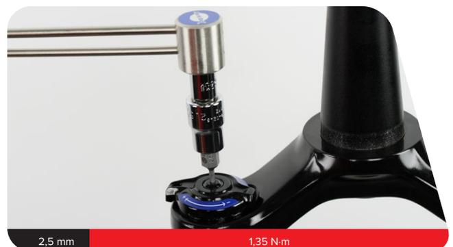
**6b RC R:** Bringen Sie den Zuganschlagring mit der Zugführung nach vorne in der 6-Uhr-Position bzw. in einem Winkel von ca. 20 bis 30 Grad zum Mittelpunkt an.
