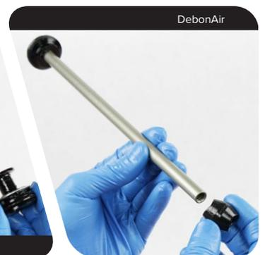
**7 Dual Position Air:** Entfernen Sie den inneren und den äußeren O-Ring des Luftkolbens und entsorgen Sie die O-Ringe. Säubern Sie den Luftkolben.
