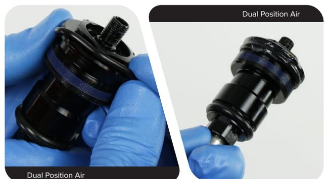
**4 Dual Position Air:** Schieben Sie die Luftführungsstange in das Standrohr, um ein Verkratzen beim Ausbau des Sicherungsringes zu vermeiden.
