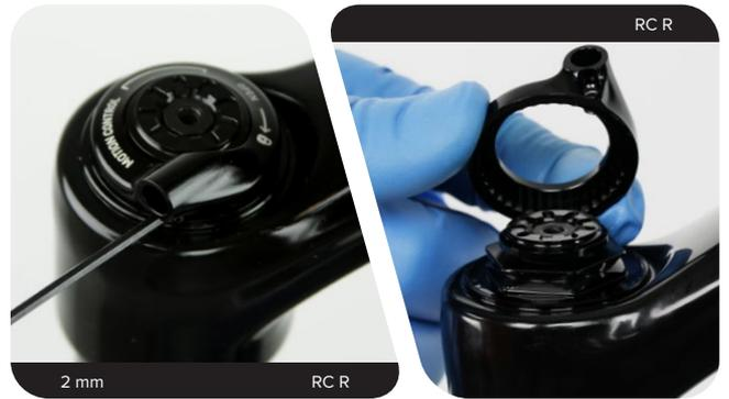
Entfernen Sie das Unterteil des Fernbedienungsringes.
