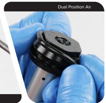
**DebonAir:** Entfernen Sie die Vierkant-Ringdichtung vom Luftkolben und entsorgen Sie sie.
