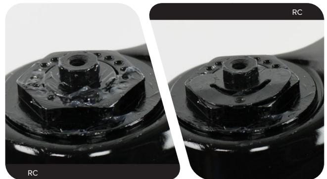
**6a** **RC:** Bringen Sie den Einstellring mit der Nase in der 7- bis 8-Uhr-Position (entsperrte Position) an.
