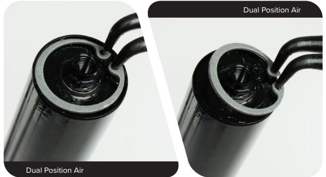
**DebonAir:** Schieben Sie die Luftführungsstange mit dem Daumen fest in das Standrohr. Schieben Sie den Dichtkopfzapfen (A) in das Standrohr und unter den Sicherungsring.
