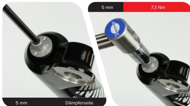
**8** Bauen Sie den Zugstufendämpfer-Einstellring ein und ziehen Sie die Feststellschraube fest.
