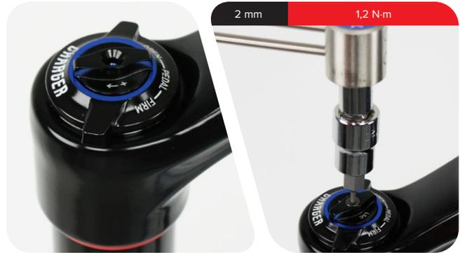
**RC:** Montieren Sie den Druckstufeneinstellung mit der Nase nach vorn in der entsperren Position auf der Abdeckkappe.
