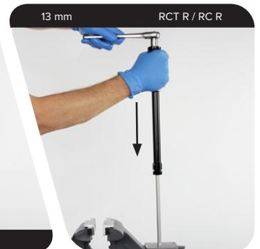
**1** Setzen Sie die Charger 2-Dämpfer-Baugruppe in das Standrohr auf der Dämpferseite ein. Schrauben Sie die Abdeckkappe in das Standrohr.
