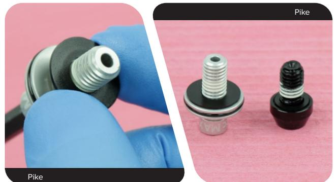
**7** Setzen Sie die schwarze untere Schraube in die Führungsstange auf der Federseite ein.
