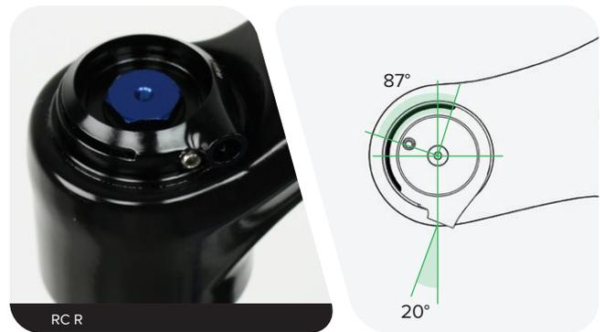
Montieren Sie den Fernbedienungsring auf dem Sechskanteinstelle, und richten Sie die Feststellschraube des Fernbedienungsrings im 87 Grad-Bereich aus.
