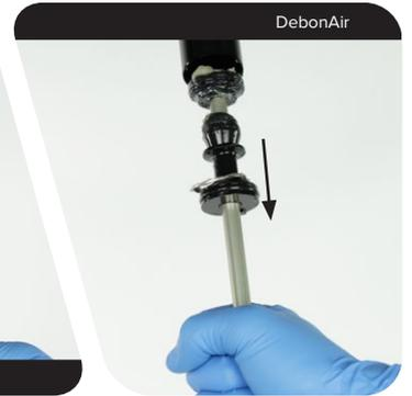
**6** Entfernen Sie den Dichtkopf, die Federscheibe, die Haltescheibe und den oberen Federweg-Anschlagpuffer von der Luftfeder-Führungsstange.
