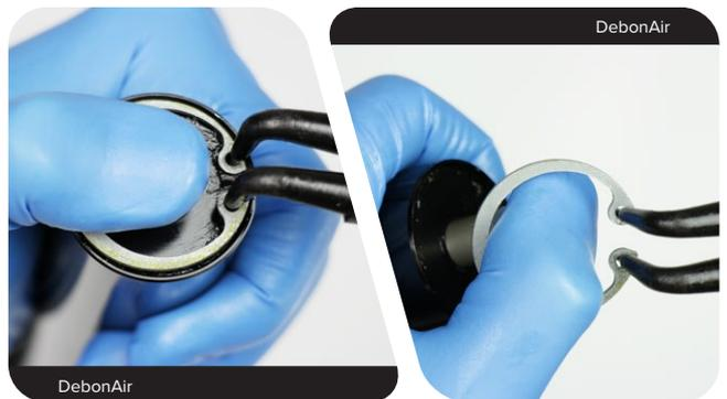
**5** Schrauben Sie die Führungsstangen-Schraube in das Ende der Luftfeder-Führungsstange, um sie besser fassen zu können.
