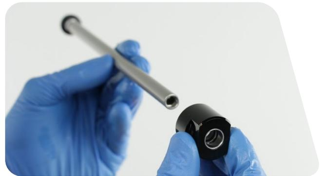
**7** Pulverice limpiador de suspensiones RockShox o alcohol isopropílico en el tubo del cartucho y limpie el interior del tubo con una toalla de taller limpia y una varilla fina ( $\leq 16$  mm de diámetro).
