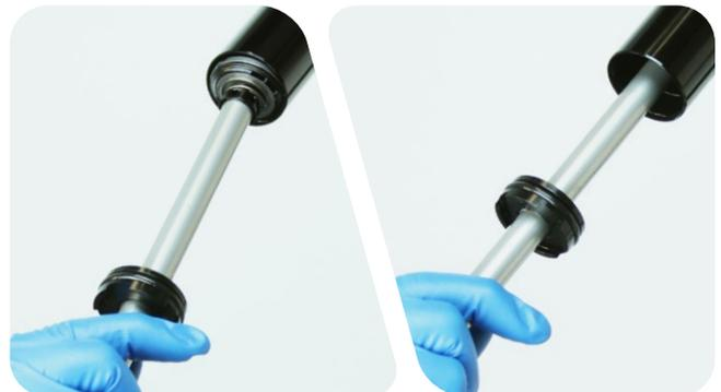
Empuje el cabezal de sellado hacia dentro del tubo superior hasta que quede visible la ranura donde va alojado el anillo de retención.
