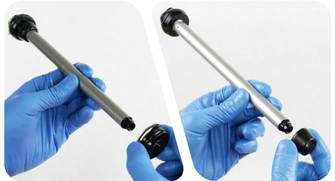
**10** Retire las juntas tóricas interior y exterior del pistón neumático y deséchelas. Limpie el pistón neumático.
