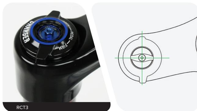
**RC2:** Instale el mando del regulador de compresión de alta velocidad.
