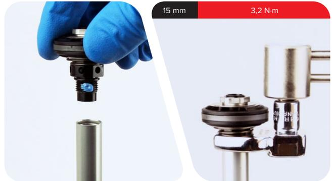
**2** Inserte el amortiguador de rebote y el cabezal de sellado en el tubo superior.
