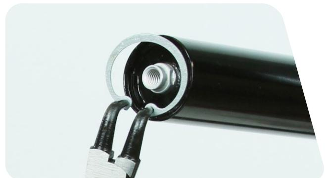
**5** Instale el perno inferior en el eje del amortiguador de rebote con 2-3 vueltas.
