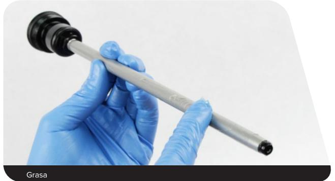
**10** Instale la tapa superior del muelle neumático en el tubo superior y apriétela. Presione fuerte hacia abajo mientras la aprieta.
