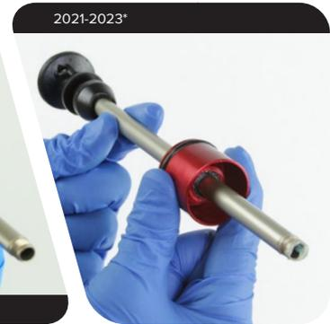
**6** Aplique Loctite 2760 rojo a las primeras dos o tres roscas completas del extremo del eje neumático.
