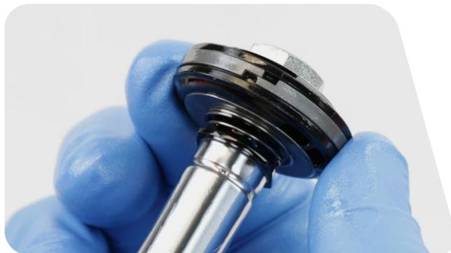
**1** Instale el cabezal de sellado sobre el eje del amortiguador de rebote, con el extremo plano apuntando hacia el pistón del amortiguador de rebote.
