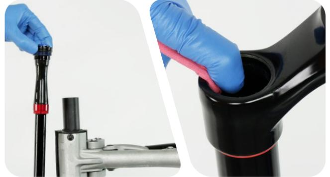
**7** Desenrosque y saque lentamente el conjunto del cabezal de sellado del amortiguador de rebote del tubo del cartucho.
