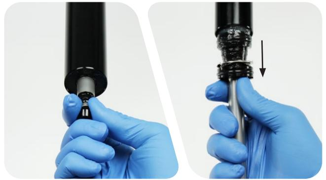
**9** Retire el cabezal de sellado, la arandela ondulada, la arandela de retención y el tope superior exterior del eje del muelle neumático.
