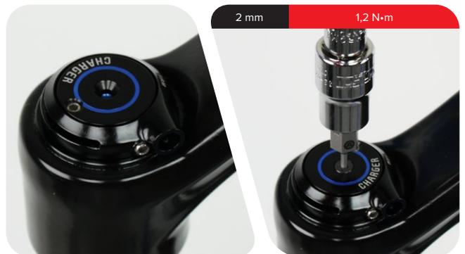
**4 RCT R / RC R:** Apriete el tornillo de fijación del collarín de tope del cable.
