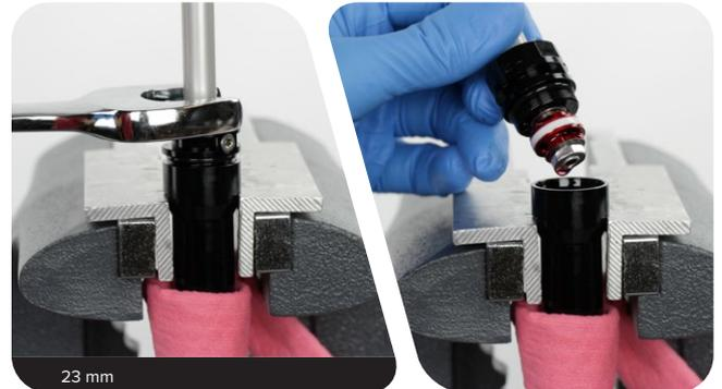
**8** Retire el cabezal de sellado del eje del amortiguador de rebote y deséchelo.
