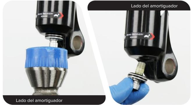
**10** Tire con fuerza hacia abajo del brazo inferior, hasta que empiece a caer líquido. Siga tirando hacia abajo para extraer el brazo inferior.
