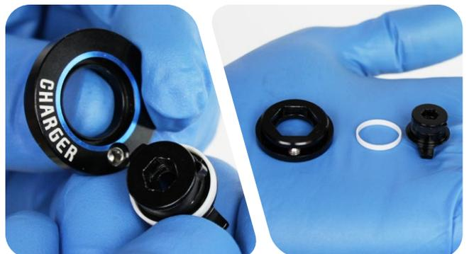
Instale el carrete del control remoto en el ajustador hexagonal con el tornillo de fijación del cable del carrete orientado dentro de la zona de 87°. Instale la junta del mando.
