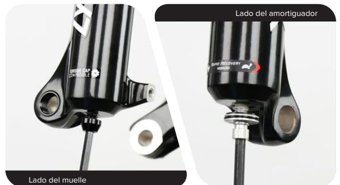
**9** Golpee cada perno inferior para sacar los ejes de cada lado del brazo inferior. La cabeza del perno debe entrar en contacto con la parte de abajo del brazo inferior.
