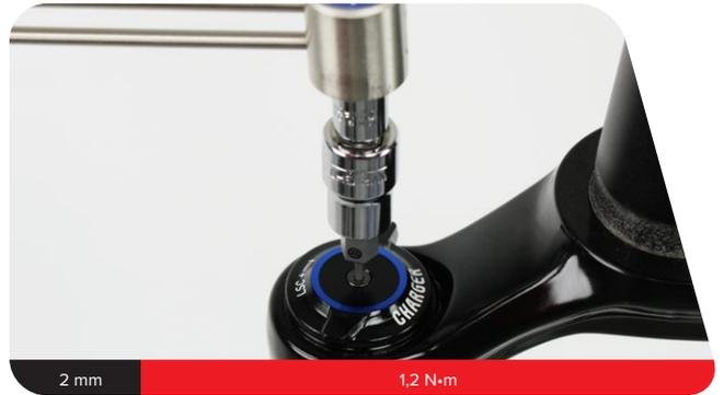
**3b RCT R:** Instale el collarín de tope del cable con la guía de la funda en la posición hacia delante, a las 6 en punto, y un ángulo de aproximadamente 20 grados desde el centro.
