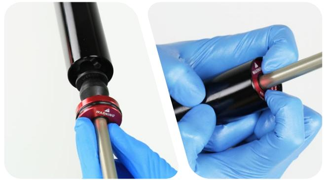
**9** Los anillos de retención tienen un lado recto y otro redondeado. Si coloca los anillos de retención con el lado recto apuntando hacia la herramienta, le resultará más fácil instalarlos y retirarlos.
