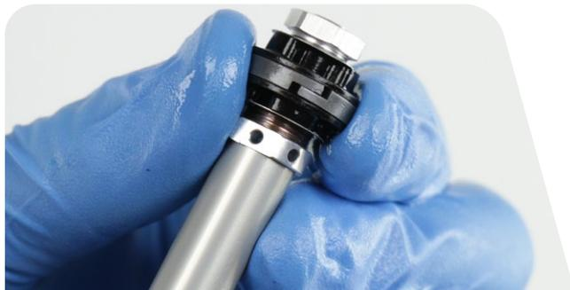
**Anillo deslizante de banda sólida (Ultimate/Select+):** El anillo deslizante de banda sólida no es desmontable y sólo requiere limpieza. No lo extraiga.
