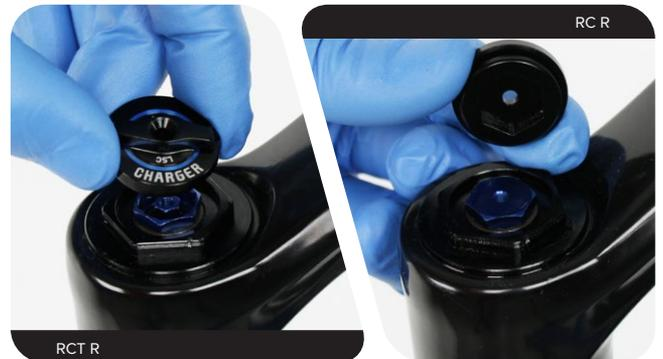
**6** Desenrosque la tapa superior del amortiguador y retire el conjunto de Charger 2 Damper/Charger 2.1 Damper.
