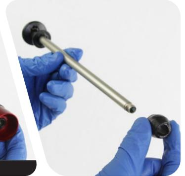
**10** Retire la junta de anillo cuádruple del pistón neumático y deséchela.
