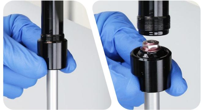
**6** Retire el cabezal de sellado y el amortiguador de rebote del tornillo de banco.
