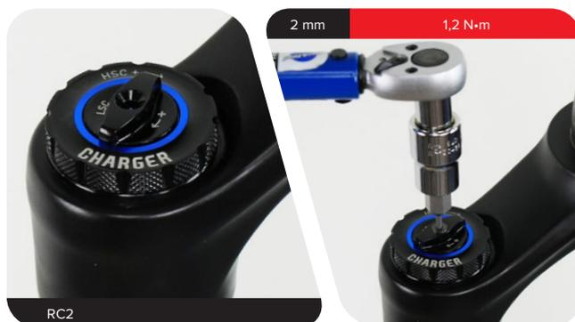
**RC:** Instale el mando del regulador de compresión en la tapa superior con la pestaña hacia delante, en la posición desbloqueada.
