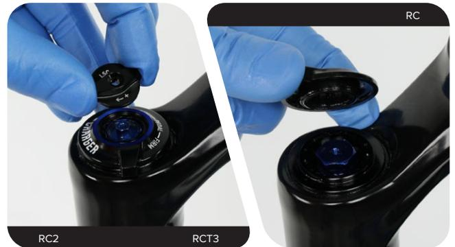
**RC2:** Retire el mando del regulador de compresión de alta velocidad.
