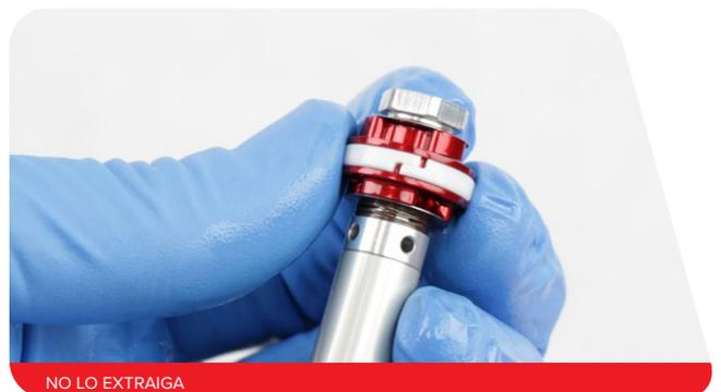
**4** Aplique grasa a las juntas del nuevo cabezal de sellado del amortiguador de rebote.
