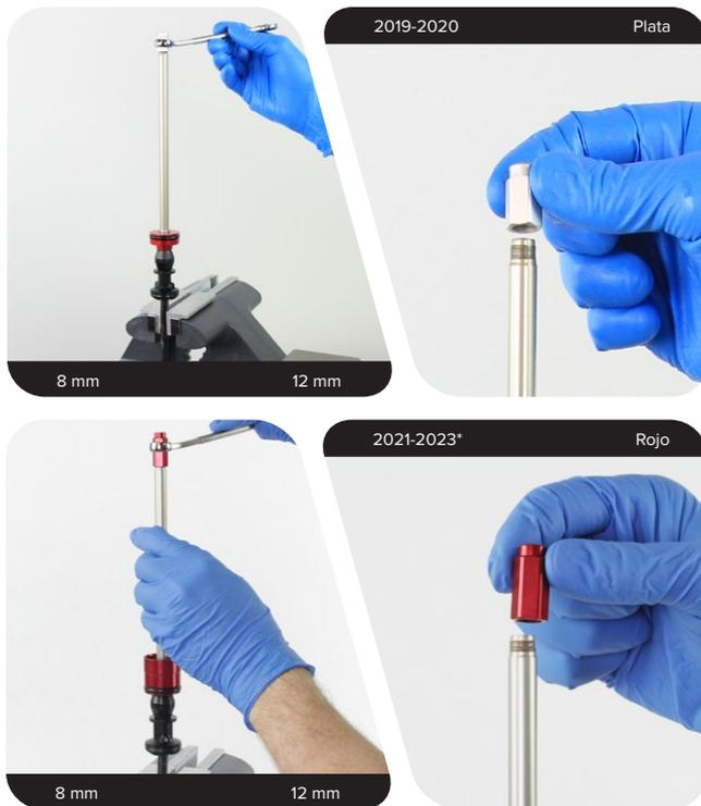
**9** Retire el cabezal de sellado y el tope superior exterior del eje del resorte neumático. Descarte el cabezal de sellado.
