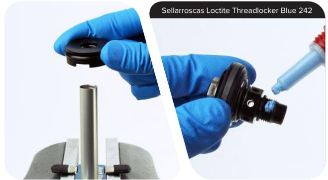
Enrosque al eje el pistón del amortiguador y apriételo.
