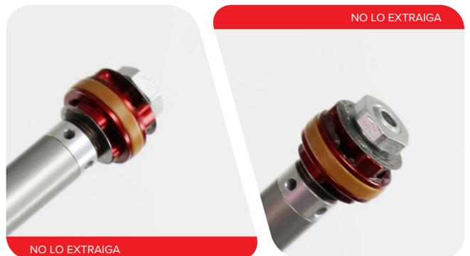
**Anillo deslizante de banda dividida:** El anillo de deslizamiento de la banda de separación no se sustituye durante el servicio y solo requiere limpieza. No lo retires.
