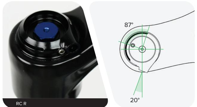
Instale el carrete del control remoto en el ajustador hexagonal con el tornillo de fijación del cable del carrete orientado dentro de la zona de 87°.
