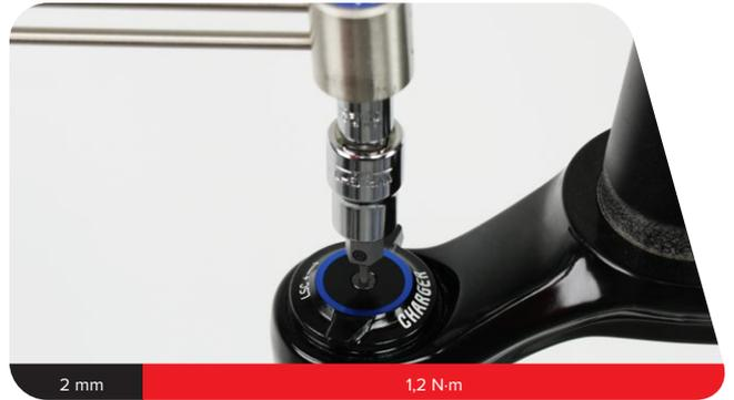
**3b RCT R:** Instale el collarín de tope del cable con la guía de la funda en la posición hacia adelante, a las 6 en punto, orientado hacia afuera aproximadamente 20 grados desde el centro.
