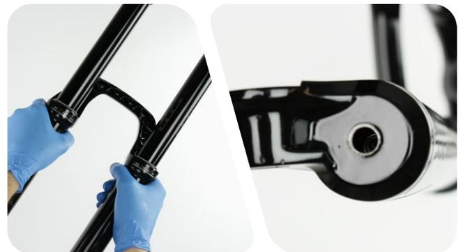
**4** Coloque la horquilla en un ángulo que deje los orificios de los pernos orientados hacia arriba.
