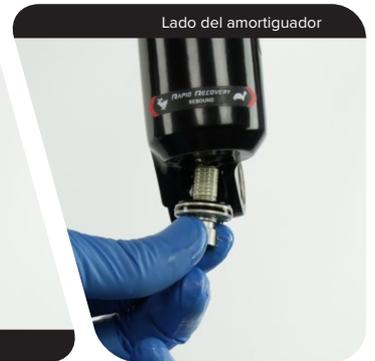
**9** Tire con fuerza hacia abajo del brazo inferior, hasta que empiece a caer líquido. Siga tirando hacia abajo para extraer el brazo inferior.
