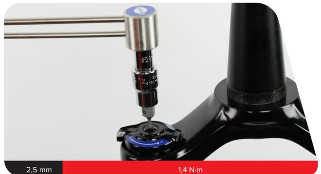
**6b RC R:** Instale el collarín de tope del cable con la guía de la funda en la posición hacia adelante, a las 6 en punto, orientado hacia afuera aproximadamente 20-30 grados desde el centro.
