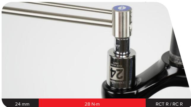
**3a RCT3:** Instale el mando del regulador del modo de compresión en la tapa superior con la pestaña hacia adelante, en la posición desbloqueada.
