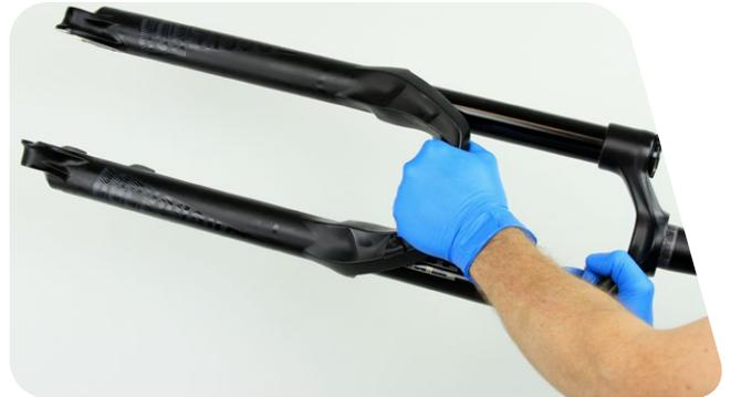
El resorte y los ejes del amortiguador deben poder verse a través de los orificios de los pernos inferiores.
