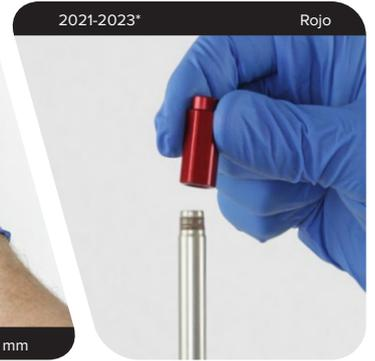
**6** Retire el cabezal de sellado y el tope superior exterior del eje del resorte neumático. Descarte el cabezal de sellado.
