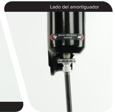
**8** Golpee cada perno inferior para sacar los ejes de cada lado del brazo inferior. La cabeza del perno debe entrar en contacto con la parte de abajo del brazo inferior.
