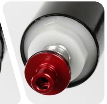
9 Tire del eje de rebote hasta extenderlo completamente.
