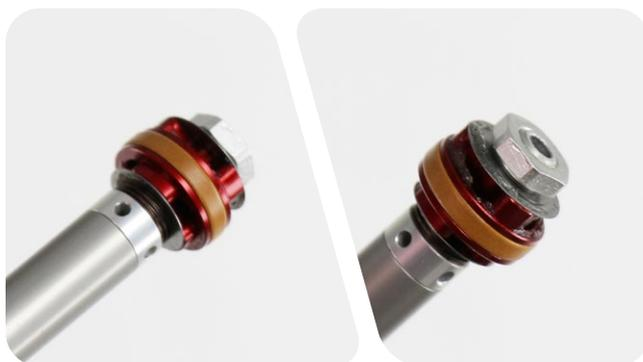
**10** Aplique grasa a la junta interior y al cojinete del nuevo cabezal de sellado del amortiguador de rebote.
