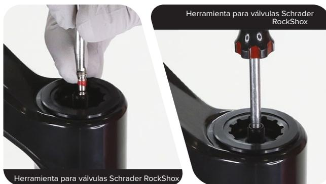
**Mantenimiento cada 200 horas** Para continuar con el mantenimiento del amortiguador Charger 2 Damper/Charger 2.1 Damper, vaya a [Mantenimiento de Charger 2 Damper/Charger 2.1 Damper](#).
