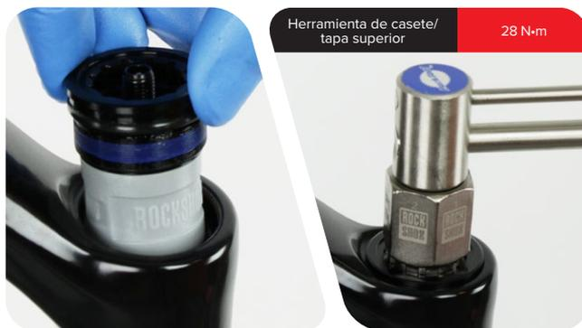
**13** Instale el obús de la válvula Schrader en la tapa superior y apriételo con los dedos.
