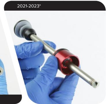
**6** Aplique Loctite 2760 rojo a las primeras dos o tres roscas completas del extremo del eje neumático.
