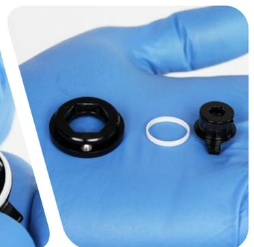
Instale el carrete del control remoto en el ajustador hexagonal con el tornillo de sujeción del cable del carrete orientado dentro de la zona de 87°.
