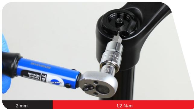
Instale el carrete del control remoto en el ajustador hexagonal con el tornillo de fijación del cable orientado a las 10 en punto, a aproximadamente 30 grados desde el centro.
