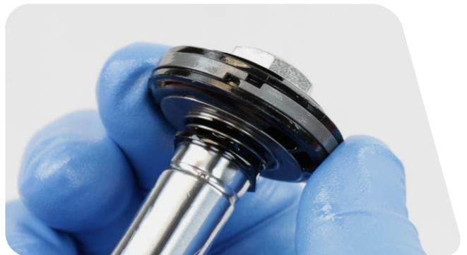
**5** Instale el cabezal de sellado en el eje del amortiguador de rebote.
