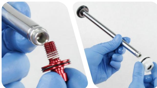
**3** Retire las juntas tóricas interior y exterior del cabezal de sellado y deséchelas.
