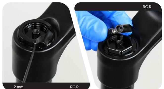
**4** Desenrosque la tapa superior del amortiguador y retire el conjunto del amortiguador.
