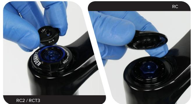
**RC2 / RCT3:** Retire el mando del regulador del modo de compresión.
