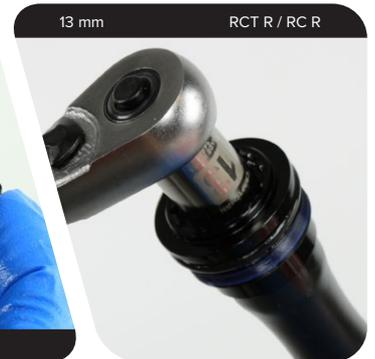
Empuje hacia abajo el conjunto del amortiguador para probar el purgado.
