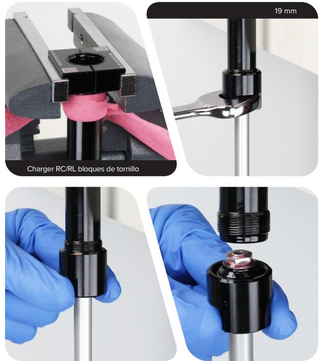
**6** Retire el cabezal de sellado del eje del amortiguador de rebote.
