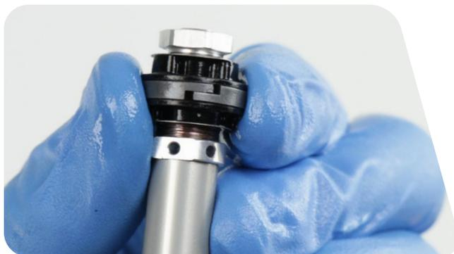
**Anillo deslizante de banda sólida:** El anillo de deslizamiento de la banda de separación no se sustituye durante el servicio y solo requiere limpieza. No lo retires.
