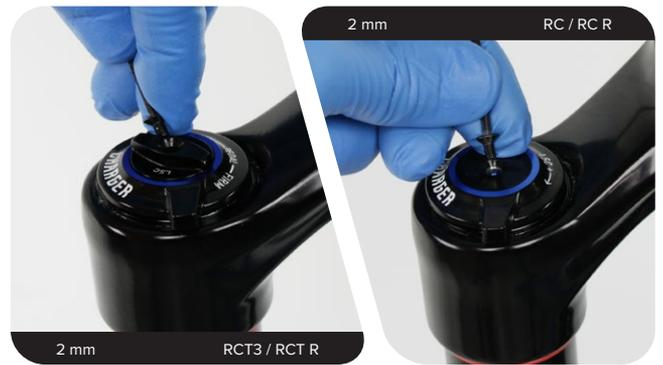
**3** **RC2 / RCT3 / RC:** Retire el mando del regulador de compresión de baja velocidad.
