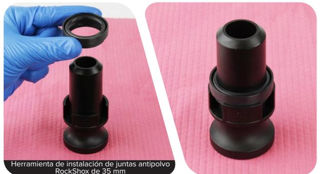
Herramienta de instalación de juntas antipolvo RockShox de 35 mm
