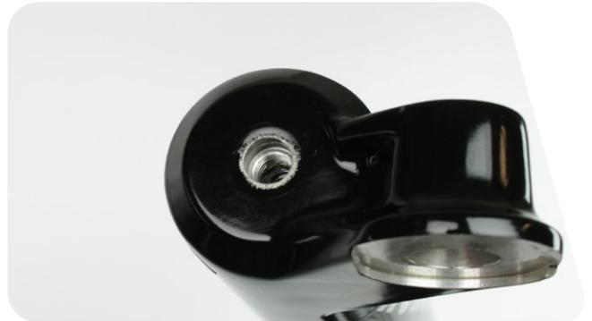
**6** **Mantenimiento cada 200 horas** Retire las arandelas de presión antiguas de cada uno de los pernos inferiores.
