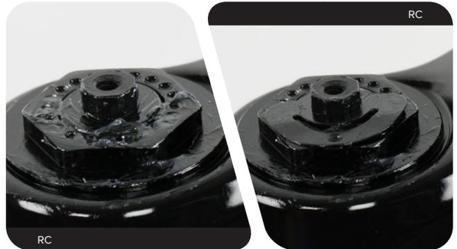
**6a** **RC:** Instale el mando del regulador con la pestaña orientada hacia las 7-8 en punto, en la posición desbloqueada.
