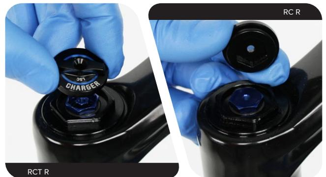
**6** Desenrosque la tapa superior del amortiguador y retire el conjunto del amortiguador Charger 2 Damper/Charger 2.1 Damper.
