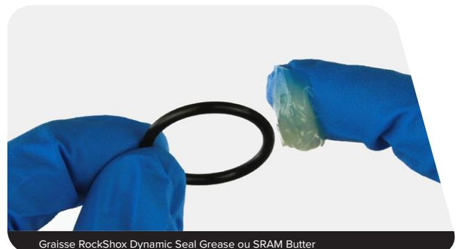
Graisse RockShox Dynamic Seal Grease ou SRAM Butter
