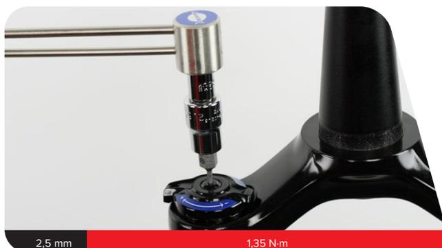
**6b RC R** : mettez le collier d'arrêt du câble en place avec le guide de la gaine tourne vers l'avant a 6 heures, orienté vers l'extérieur, en respectant un angle d'environ 20 à 30 degrés par rapport au centre.
