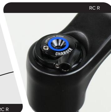
Mettez la vis de blocage de la bobine de la commande de rappel en place puis serrez-la.
