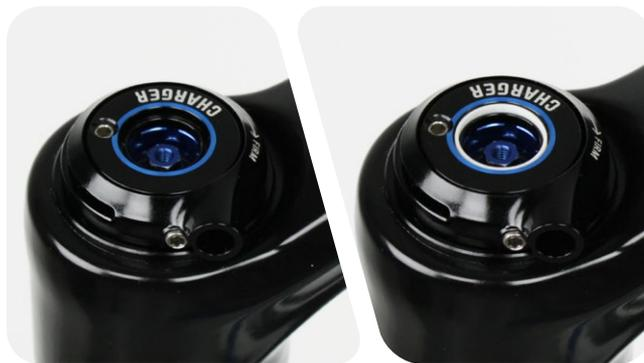
Installez la molette de réglage basse vitesse sur la tige de réglage hexagonale. Mettez la vis de blocage de la molette en place puis serrez-la.
