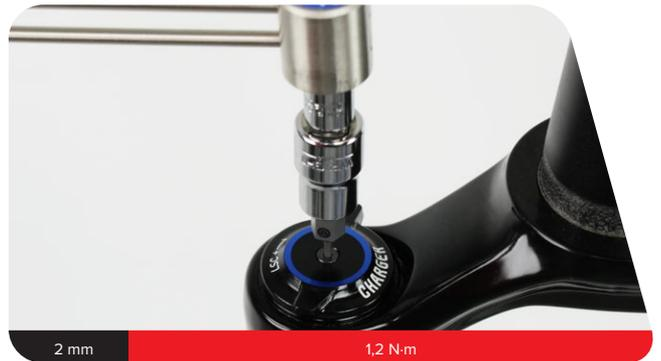
**3b RCT R :** mettez le collier d'arrêt du câble en place avec le guide de la gaine tourné vers l'avant à 6 heures, orienté vers l'extérieur, en respectant un angle d'environ 20 degrés par rapport au centre.
