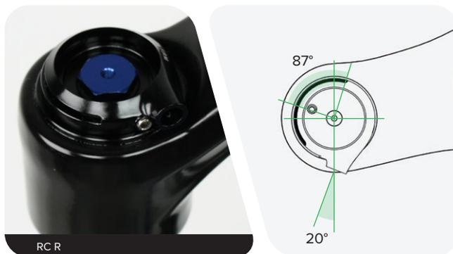
Installez la bobine de la commande de rappel sur le réglage hexagonal de manière à ce que la vis de fixation du câble de la bobine se trouve dans la zone à 87°.
