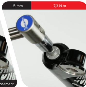
**8** Installez la molette de la cartouche de détente puis serrez la vis de fixation.
