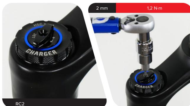
**RC :** mettez la molette de réglage de compression sur le capuchon supérieur avec la languette tournée vers l'avant en position déverrouillée.
