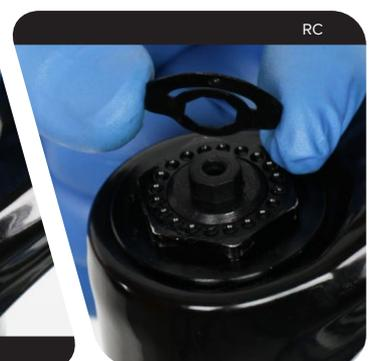
**4** RC R: Desserrez la vis de fixation puis retirez le collier d'arrêt du câble.
