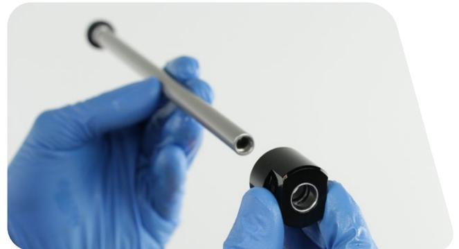
**7** Vaporisez du produit de nettoyage pour suspension RockShox ou de l'alcool isopropylique dans le tube de la cartouche puis nettoyez l'intérieur du tube à l'aide d'un chiffon propre enroulé autour d'un fin goujon ( $\leq 16$  mm de diamètre).
