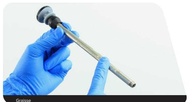
**4** Appliquez de la graisse sur le joint torique interne de la tête d'étanchéité neuve.
