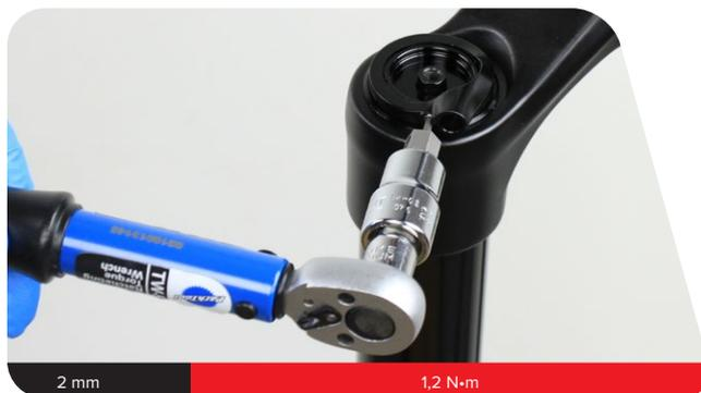
Installez la bobine de la commande de rappel sur le réglage hexagonal avec la vis de fixation du câble tournée à 10 heures, en respectant un angle d'environ 30 degrés par rapport au centre.
