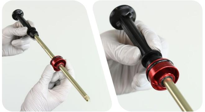
**6** Aplique Loctite 2760 rojo a las primeras dos o tres roscas completas del extremo del eje neumático.
