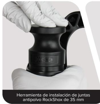
Herramienta de instalación de juntas antipolvo RockShox de 35 mm
