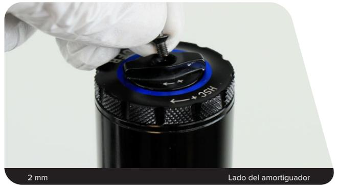
**4** Retire el mando del regulador de compresión de baja velocidad. Retire el mando del regulador de compresión de alta velocidad.
