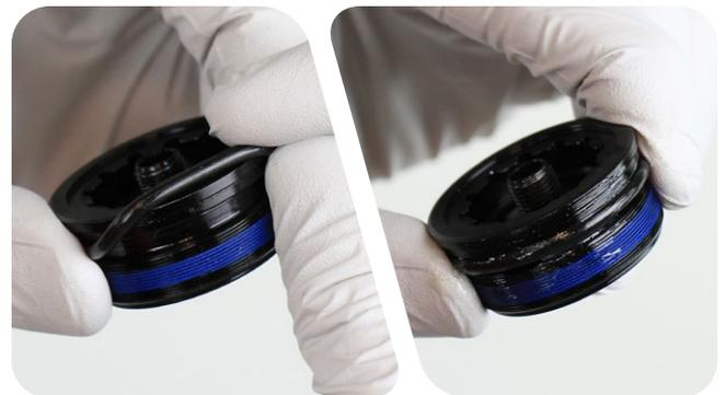
**6** Retire el anillo de retención. Utilice un dedo para guiar el anillo de retención sobre el eje del resorte.
