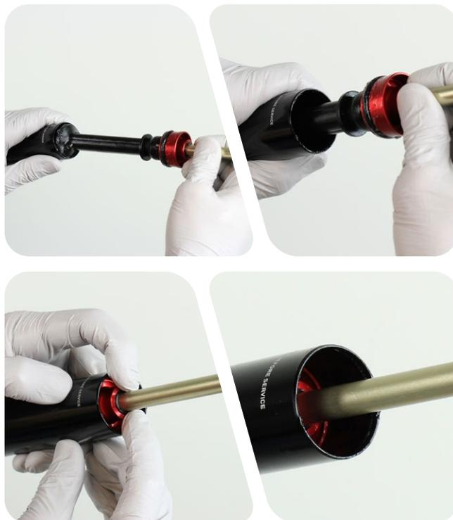
**10** Instale el espaciador del cabezal de sellado.
