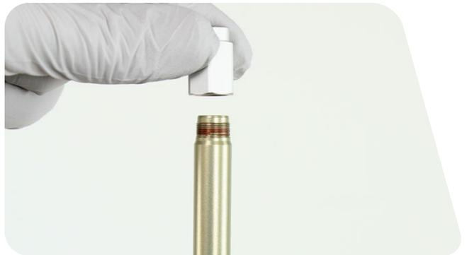
**10** Retire el cabezal de sellado y el tope superior exterior del eje del resorte neumático. Descarte el cabezal de sellado. Limpie e inspeccione el eje para comprobar si presenta algún daño. Limpie el tope superior exterior.
