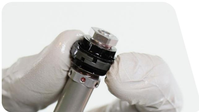
**Anillo deslizante de banda sólida:** El anillo deslizante de banda sólida no es desmontable y sólo requiere limpieza. No lo extraiga.
