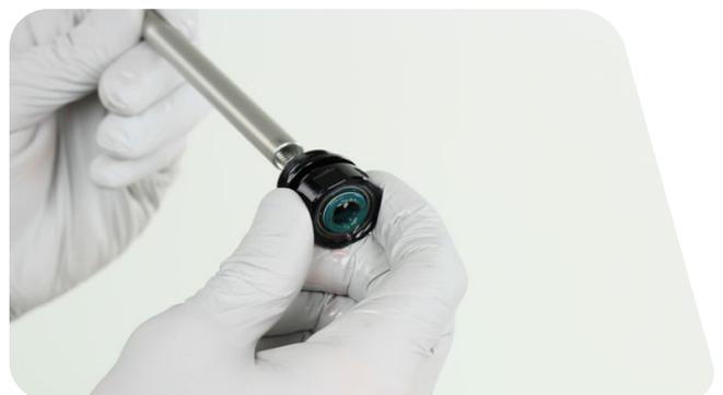
**5 Anillo deslizante de banda dividida:** El anillo de deslizamiento de la banda de separación no se sustituye durante el servicio y solo requiere limpieza. No lo retires.
