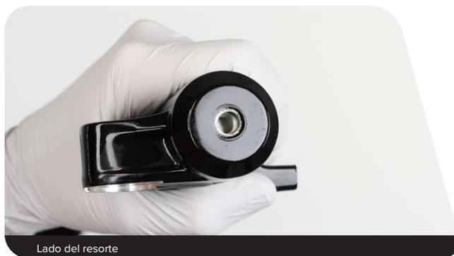
**14** Instale el perno inferior negro en el eje y apriételo al par especificado.
