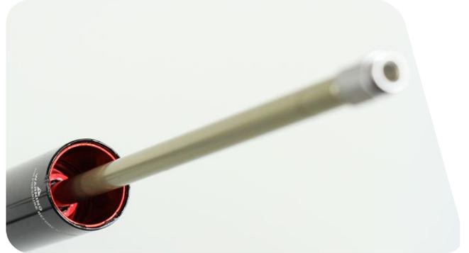
**7** Envuelva una toalla de taller alrededor del extremo del eje neumático para poder agarrarlo mejor. Empuje el eje hasta la mitad en el tubo superior; a continuación, tire rápida y firmemente del eje hacia fuera para desalojar el cabezal de sellado. Extraiga el conjunto del resorte neumático del tubo superior.
