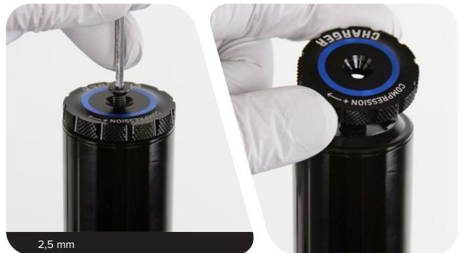
**4** Desensrosque la tapa superior del amortiguador y retire el conjunto del Charger Damper RC.
