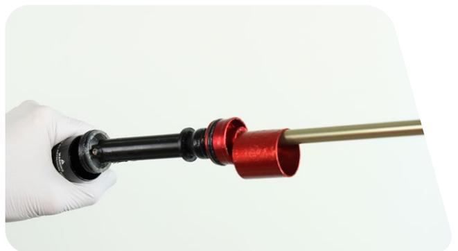
**8** Retire el espaciador del cabezal de sellado.
