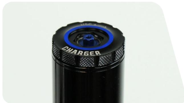
Instale el mando del regulador de compresión de baja velocidad en la varilla del ajustador hexagonal.
