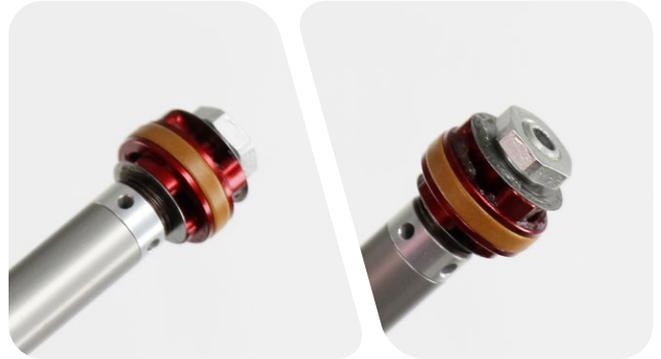
**6 Aplique grasa a las juntas del nuevo cabezal de sellado del amortiguador de rebote.**
