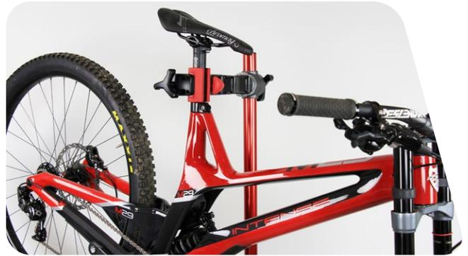
**2** Como ayuda para el montaje tras el mantenimiento, mida la distancia desde el punto más alto del tubo superior hasta el punto más alto de la corona inferior.
