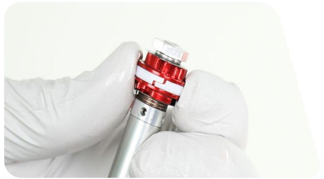
**Anillo deslizante de banda sólida:** El anillo deslizante de banda sólida no es desmontable y sólo requiere limpieza. No lo extraiga.
