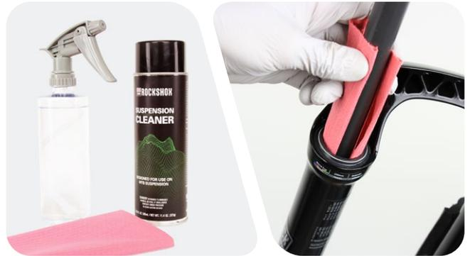
Sustituya la junta tórica o de estanqueidad por otra nueva del kit de mantenimiento. Utilice los dedos o un punzón de plástico para perforar y retirar la junta tórica o de estanqueidad antiguas.
