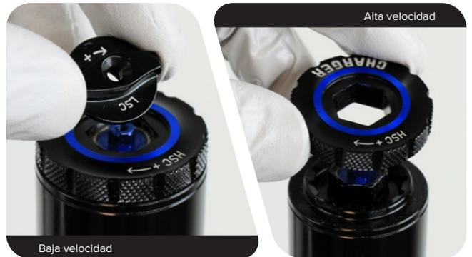
**5** Desenrosque la tapa superior del amortiguador y retire el conjunto del Charger 2 Damper/Charger 2.1 Damper.
