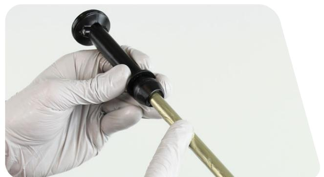
**4** Aplique grasa a la nueva junta interior del cabezal de sellado.
