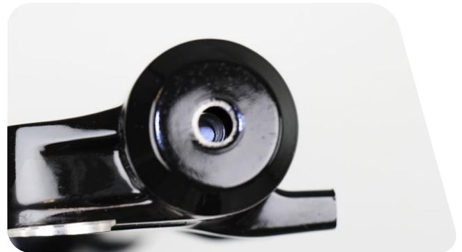
**12** Inyecte aceite para suspensiones en el brazo inferior a través del orificio del perno inferior.
