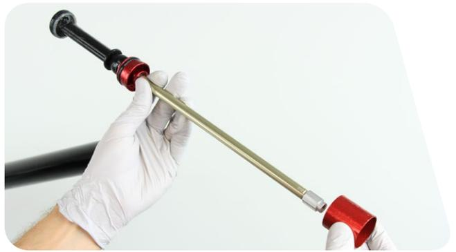
**9** Sujete una llave Allen de 8 mm en un tornillo de banco. Coloque el pistón neumático en la llave Allen. Mientras sujeta el eje neumático, desenrosque y quite la tuerca del eje del resorte neumático. Retire el conjunto neumático del tornillo de banco.
