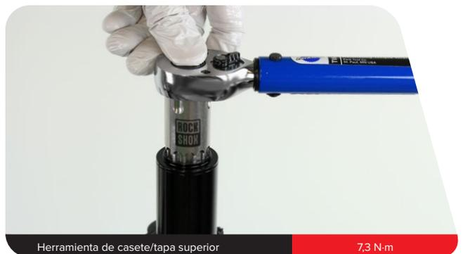
**3** Instale el mando del regulador de compresión de alta velocidad.
