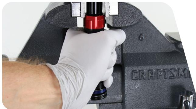
**11** Retirez le tube hors de l'étau. Tournez le tube la tête en bas et pressez la vessie jusqu'à ce que tout le produit de nettoyage et toute l'huile se soient écoulés dans le récipient prévu à cet effet.
