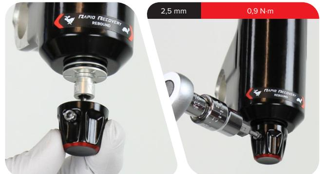
**10** Retirez le plongeur du côté de la cartouche d'amortissement serré dans le trépied d'atelier.
