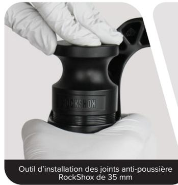
Outil d'installation des joints anti-poussière RockShox de 35 mm
