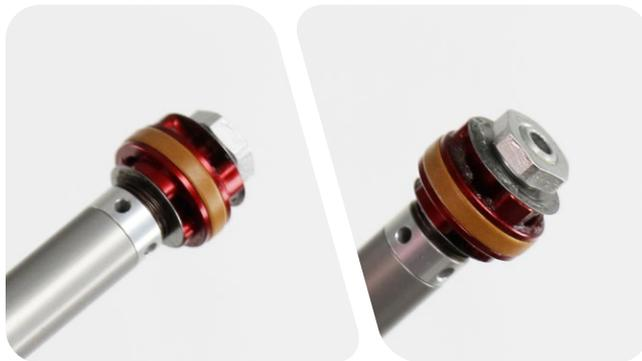
**6** Appliquez de la graisse sur les joints neufs de la tête d'étanchéité de la cartouche de détente.
