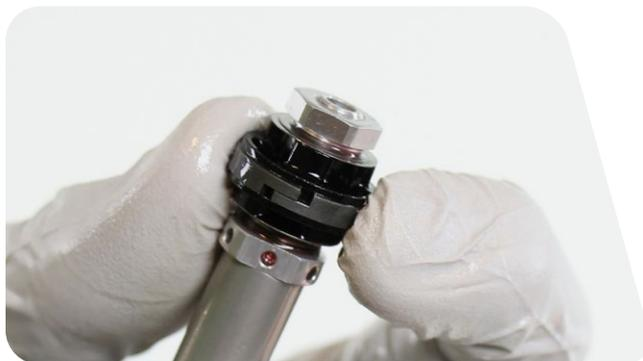
**Anneau de coulissage plein** : l'anneau de coulissage plein n'est pas amovible et ne nécessite qu'un nettoyage. Ne la retirez pas.
