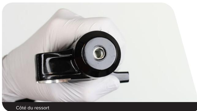
**14** Installez le boulon inférieur de couleur noire dans la came puis serrez-le au couple recommandé.
