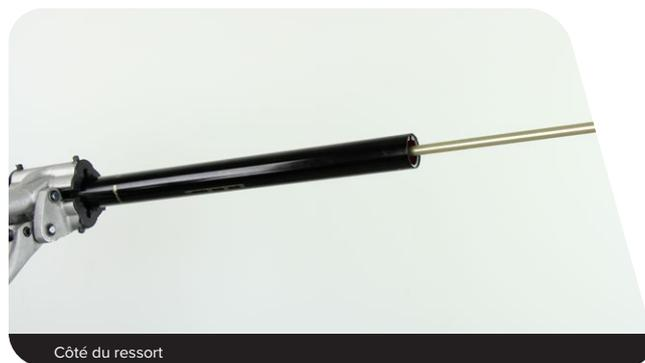
**11** Installez le fourreau inférieur du côté du ressort sur le plongeur et faites-le coulisser jusqu'à enclencher la bague supérieure.
