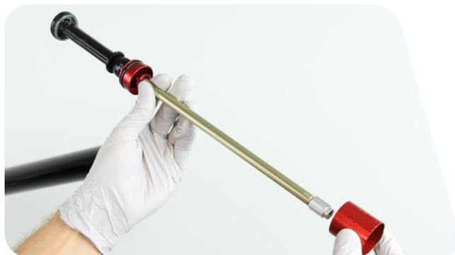
**9** Serrez une clé hexagonale de 8 mm dans un étau. Placez le piston pneumatique sur la clé hexagonale. Tout en maintenant la came pneumatique en place, dévissez puis retirez l'écrou situé sur la came du ressort pneumatique.
