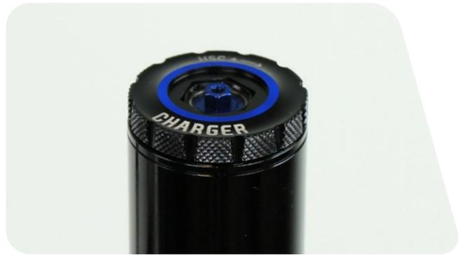
Mettez la molette de réglage de la compression basse vitesse sur la tige de réglage hexagonale.
