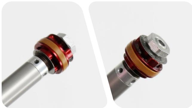
**10** Appliquez de la graisse sur le joint interne et la bague situés à l'intérieur de la tête d'étanchéité de la cartouche de détente neuve. Appliquez de la graisse sur l'extrémité de la came de la cartouche de détente.
