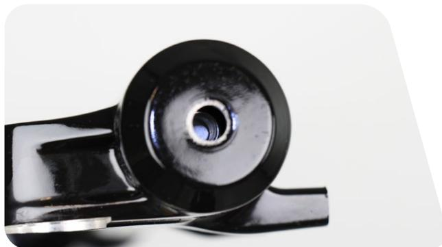
**12** Injectez de l'huile de suspension dans le fourreau inférieur à travers le trou du boulon inférieur.
