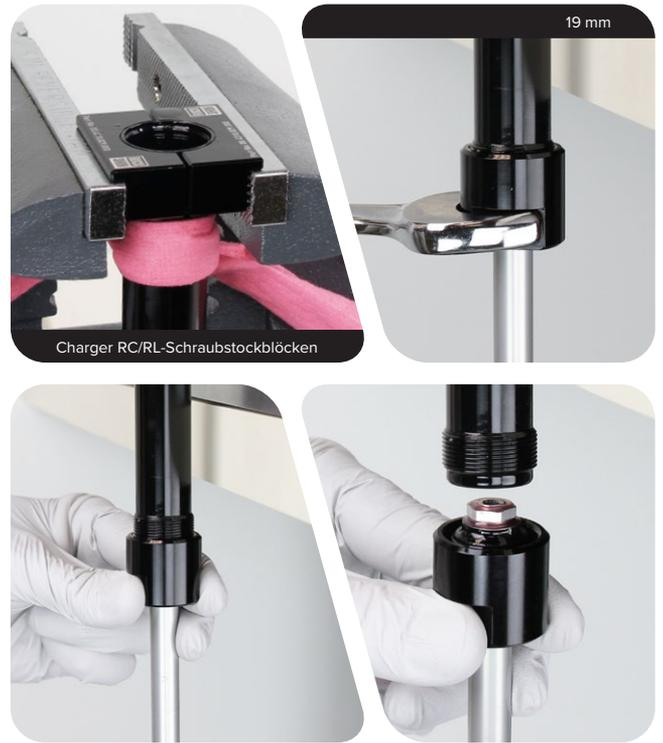
**6** Entfernen Sie den Dichtkopf von der Zugstufendämpfer-Führungsstange. Entsorgen Sie den Dichtkopf.
