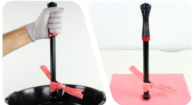
**12** Trocknen Sie das Patronenrohr und die Druckstufendämpfer-Baugruppe mit Druckluft.
