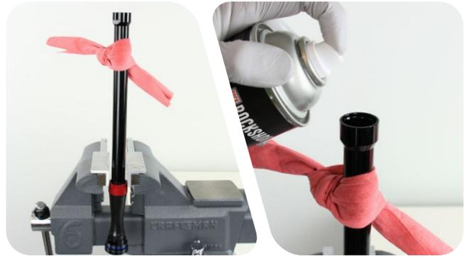
Drücken Sie die Membran 5 bis 6 Mal zusammen, damit das Reinigungsmittel sich im Dämpfer verteilt.
