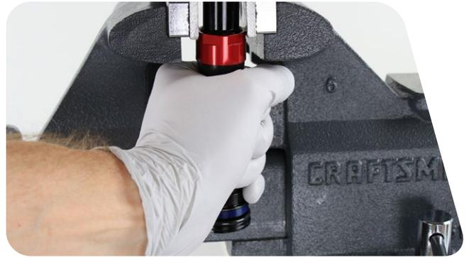
**11** Entnehmen Sie das Patronenrohr aus dem Schraubstock. Richten Sie das Patronenrohr nach unten aus und drücken Sie die Membran zusammen, bis das Reinigungsmittel und etwaiges restliches Öl in eine Ölauffangwanne abgelaufen sind.
