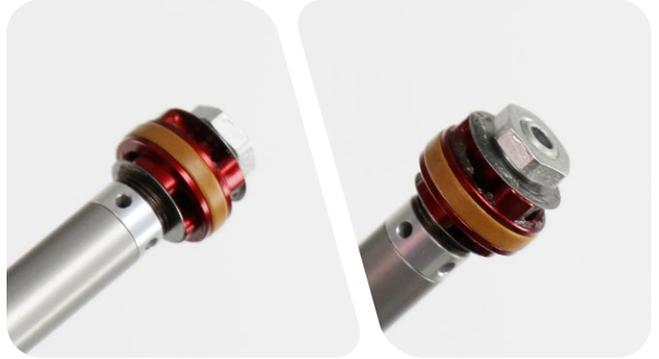
**10** Tragen Sie Schmierfett auf die innere Dichtung und die Buchse im neuen Zugstufendämpfer-Dichtkopf auf.
