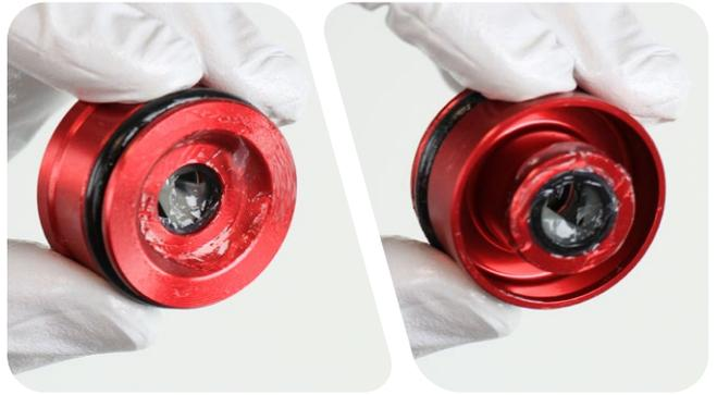
**5** Montieren Sie die neue Dichtkopf-Baugruppe auf der Luftführungsstange.
