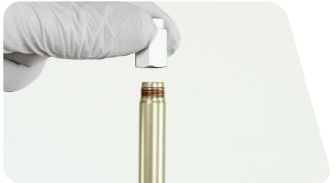
**10** Entfernen Sie den Dichtkopf und den oberen Federweg-Anschlagpuffer von der Luftfeder-Führungsstange. Entsorgen Sie den Dichtkopf. Säubern und prüfen Sie die Führungsstange auf Beschädigungen. Säubern Sie den oberen Federweg-Anschlagpuffer.
