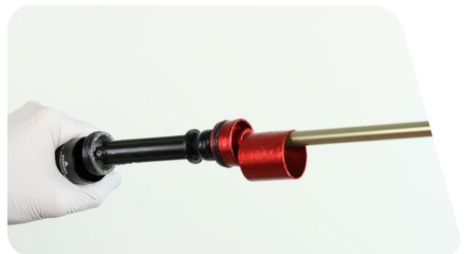
**8** Entfernen Sie das Dichtkopf-Distanzstück.
