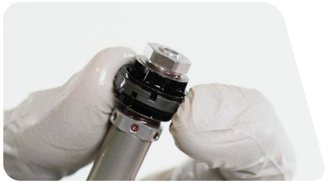
**Massiver Gleitring:** Der massive Gleitring ist nicht ausbaubar und muss lediglich gereinigt werden. Entfernen Sie ihn nicht.
