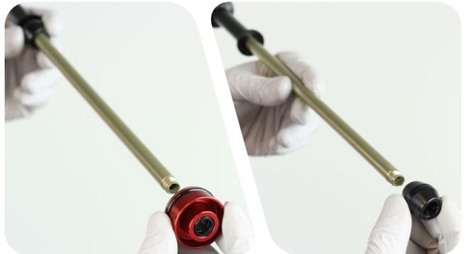
**11** Entfernen Sie die Vierkant-Ringdichtung vom Luftkolben und entsorgen Sie sie.
