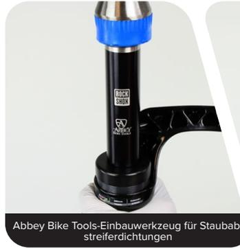
Abbey Bike Tools-Einbauwerkzeug für Staubabstreiferdichtungen
