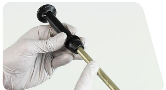
**4** Tragen Sie Schmierfett auf die neue innere Dichtung des Dichtkopfs auf.
