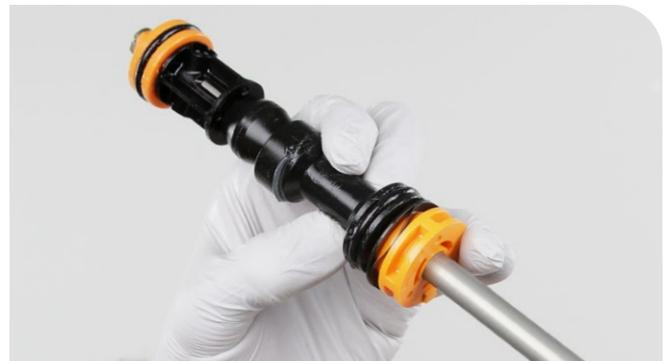
**6** Führen Sie die Luftfeder-Baugruppe in das Standrohr ein. Schieben Sie den Luftkolben fest in das Standrohr.
