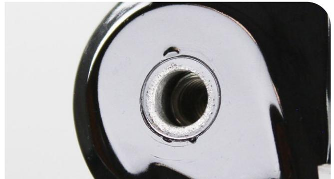
**6** **200-Stunden-Wartung** Entfernen Sie den alten Sprengringhaltering und den Sprengring von jeder unteren Schraube.
