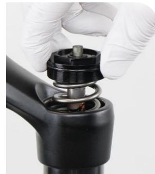
**2** Schrauben Sie die Abdeckkappe in das Standrohr.
