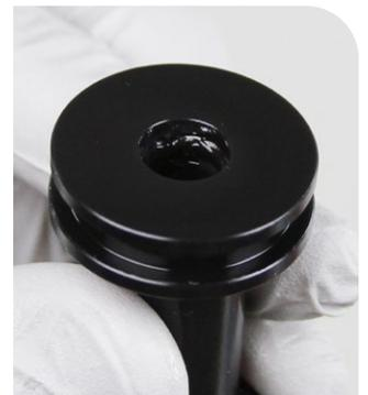
**12** Tragen Sie Schmierfett auf eine neue äußere O-Ring-Dichtung auf und bauen Sie sie ein.
