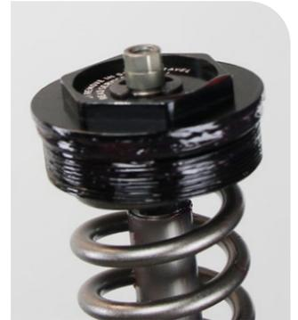
**1** Führen Sie die Schraubenfeder-Baugruppe in das Standrohr ein.
