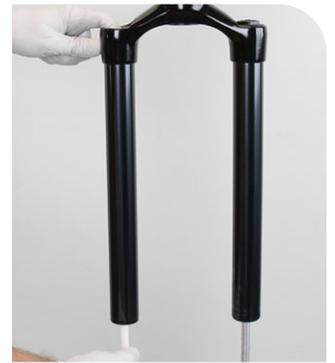
Schieben Sie mit einem zweiten Stab (15 bis 17 mm Durchmesser) den Dämpfer in das Standrohr, während Sie ihn mit dem dünnen Stab durch den Dichtkopf führen.
