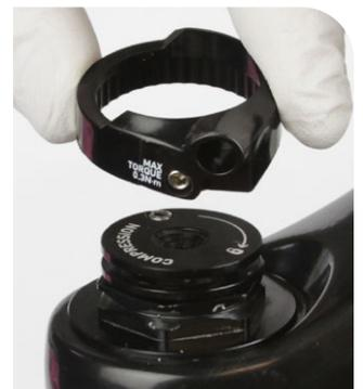
Entfernen Sie die Befestigungsschraube und danach den Fernbedienungsring.
