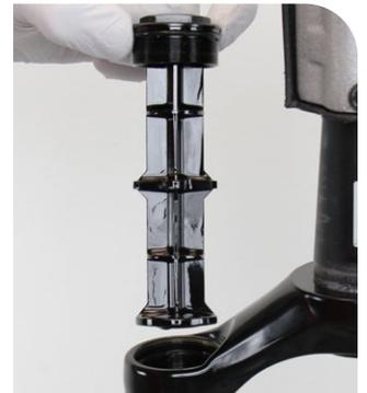
**4** Entnehmen Sie die Gabel aus dem Montageständer und lassen Sie das Federungsöl in eine Ölauffangwanne ablaufen.
