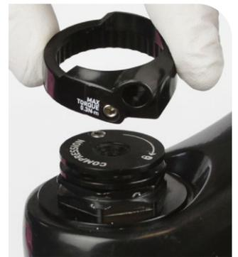
Entfernen Sie die Befestigungsschraube und danach den Fernbedienungsring.
