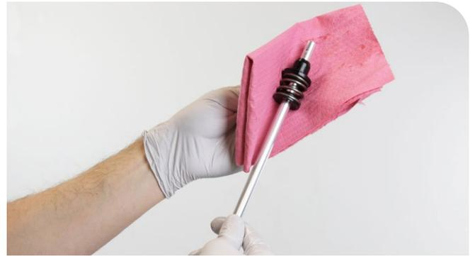
5 Säubern Sie die Schraubenfeder und die Innen- und Außenseite des Standrohrs.
