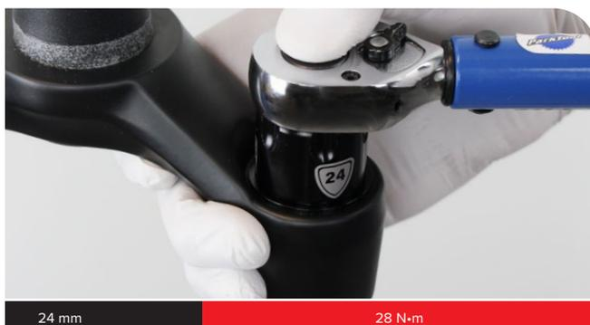
**3** Montieren Sie den Federwegeinstellring in der Stellung des maximalen Federwegs (gegen den Uhrzeigersinn bis zum Anschlag gedreht).
