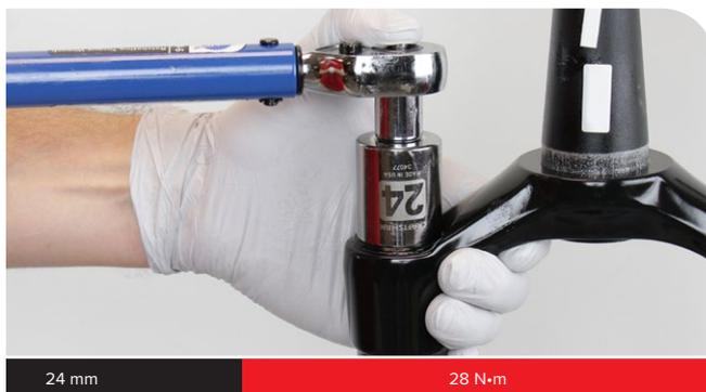
**5** **TK:** Instale el mando del regulador con la pestaña orientada hacia las 7-8 en punto, en la posición desbloqueada.
