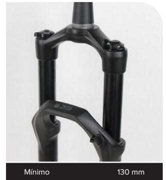
Con el mando del regulador de recorrido a tope en sentido antihorario (recorrido máximo), y la horquilla completamente extendida hasta su recorrido máximo, quite el tornillo de retención del mando del regulador de recorrido.
