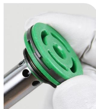
**5** Instale el cabezal de sellado en el eje del amortiguador de rebote.
