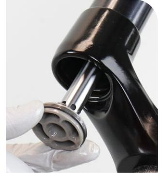
**6** Retire con cuidado el aro de retención del cabezal de sellado utilizando un destornillador de punta plana.
