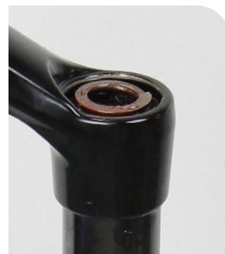
**3** Aplique grasa a cada lado de los espaciadores de precarga, si se han retirado durante el desmontaje, e instálelos encima del muelle helicoidal.
