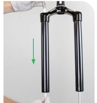
**5** Empuje el pistón del amortiguador de rebote dentro del tubo superior hasta que el pistón quede justo por debajo de las roscas del tubo superior.
