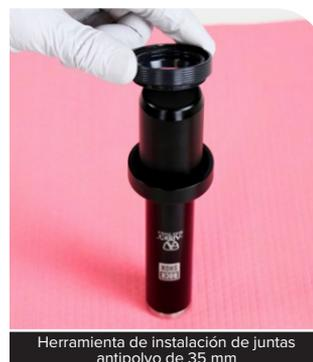
Herramienta de instalación de juntas antipolvo de 35 mm
