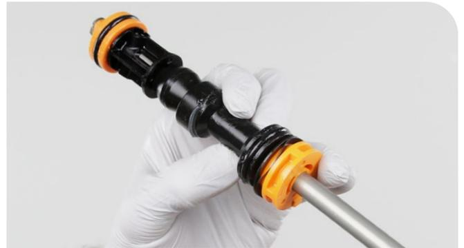
**6** Inserte el conjunto de resorte neumático en el tubo superior. Empuje firmemente el pistón neumático dentro del tubo superior.
