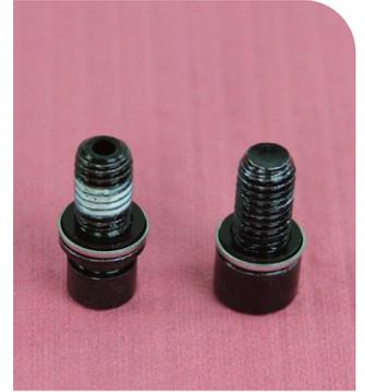
**7** Instale el perno inferior sólido en el eje del lado del resorte. Instale el perno hueco en el eje del lado del amortiguador. Apriete cada perno.
