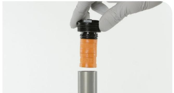
**3** Extraiga el conjunto del resorte neumático del tubo neumático.
