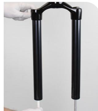
Use una segunda varilla (15-17 mm de diámetro) para empujar el amortiguador dentro del tubo superior mientras lo dirige a través del cabezal de sellado con la varilla fina.
