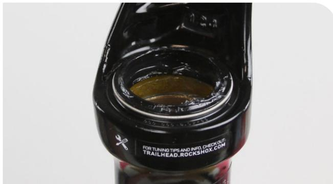
**3** Instale el conjunto del brazo inferior en los tubos superiores y deslícelo lo justo para encajar los casquillos superiores en los tubos superiores.
