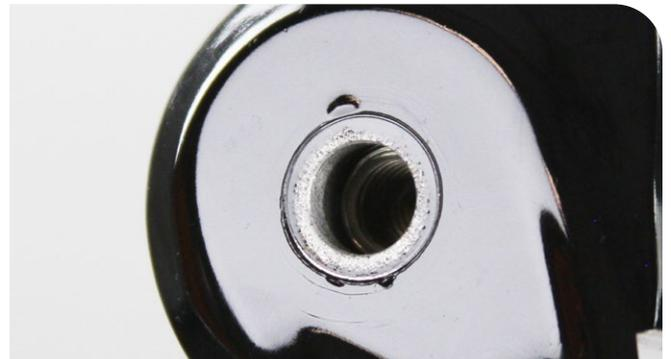
**6** **Mantenimiento cada 200 horas** Retire el aro de retención de arandela de presión y la propia arandela de presión antiguos de cada perno inferior.
