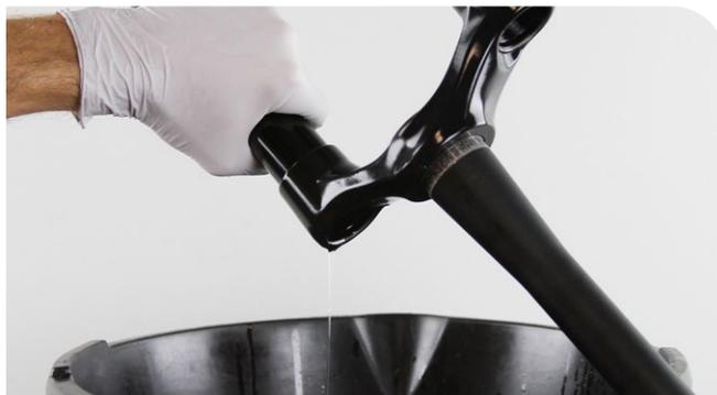
**5** Vuelva a colocar la horquilla en el soporte de trabajo con el tubo de dirección orientado hacia abajo.
