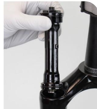
**R:** Desenrosque y retire el conjunto de tapa superior/espaciador de aceite de rebote. Presione fuerte hacia abajo mientras la afloja. No saque el espaciador de aceite de la tapa superior.
