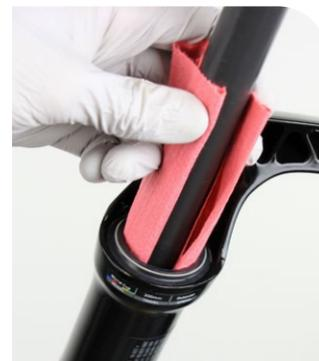
Sustituya la junta tórica o de estanqueidad por otra nueva del kit de mantenimiento. Utilice los dedos o un punzón para perforar y retirar la junta tórica o de estanqueidad antigua.
