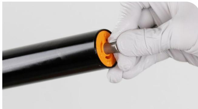
**8** Los anillos de retención tienen un lado recto y otro redondeado. Si coloca los anillos de retención con el lado recto apuntando hacia la herramienta, le resultará más fácil instalarlos y retirarlos.
