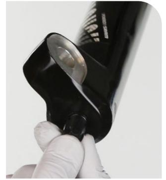
**9** **Horquillas con resorte neumático:** Consulte los ajustes que anotó antes de realizar el mantenimiento, o use la tabla neumática ubicada en el brazo inferior de la horquilla, para presurizar el resorte neumático.
