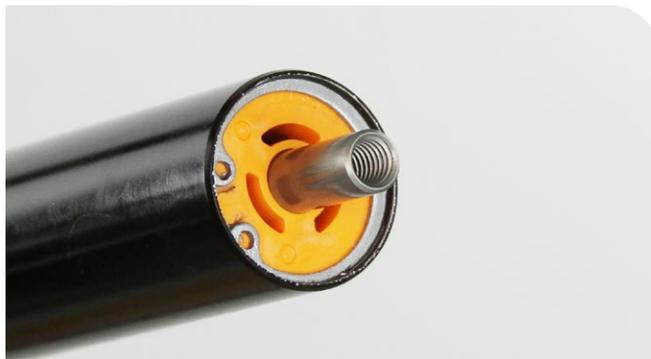
**9** Enrosque el perno inferior en el eje neumático y tire del eje hasta que se detenga.
