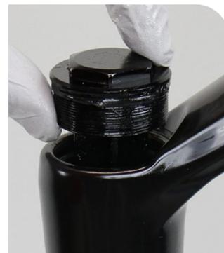
**4** Enrosque la tapa superior en el tubo superior y apriétela. Presione fuerte hacia abajo mientras la aprieta.
