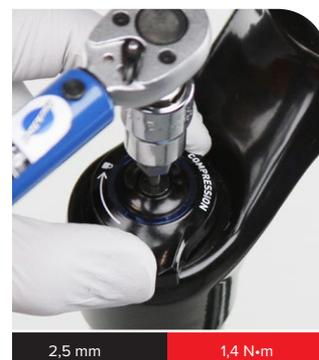
**6 TK R:** Instale el collarín de tope del cable con la guía de la funda en la posición hacia adelante y a 20 grados del centro.
