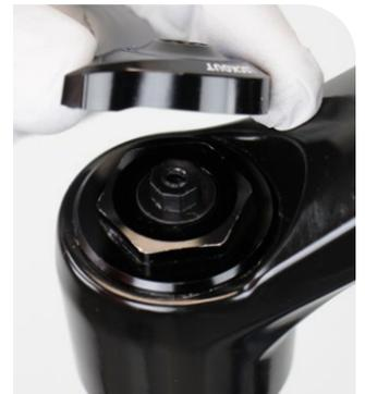
**2 TK R:** Afloje el tornillo de fijación y retire el collarín de tope del cable.
