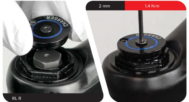
Bringen Sie den Zuganschlagring an. Ziehen Sie die Schraube des Zuganschlagrings erst handfest an und dann fest. Hinweise zur Montage der Züge finden Sie in der Bedienungsanleitung zur Fernbedienung.
