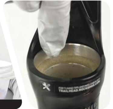
**5** Entnehmen Sie die äußere Drahtfeder aus den neuen Abstreiferdichtungen und legen Sie sie beiseite.
