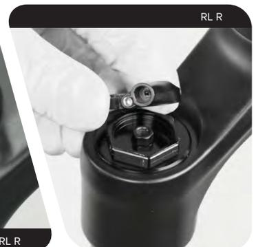
**4** Lösen Sie die Dämpfer-Abdeckkappe und entfernen Sie die Dämpfer-Baugruppe.
