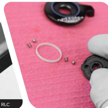
Setzen Sie eine Feder in jedes Loch an der Unterseite des Lowspeed-Druckstufeneinstellrings ein. Platzieren Sie eine Rastkugel auf jeder Feder. Montieren Sie einen neuen Gleitring in der Nut.
