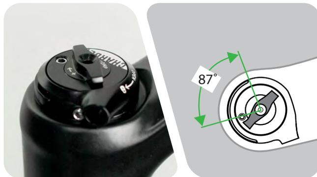
Bringen Sie die Schraube des Lowspeed-Druckstufeneinstellrings an und ziehen Sie sie fest.
