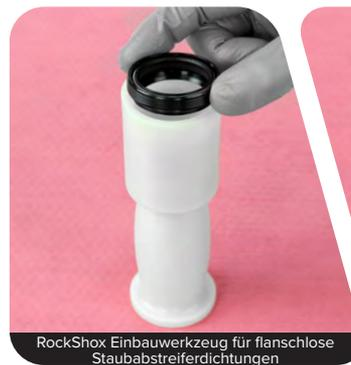
RockShox Einbauwerkzeug für flanschlose Staubabstreiferdichtungen
