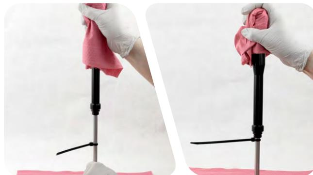
**1 RL:** Drehen Sie die Druckstufennocke mit dem Einstellring im Uhrzeigersinn bis zum Anschlag in die feste Position.
