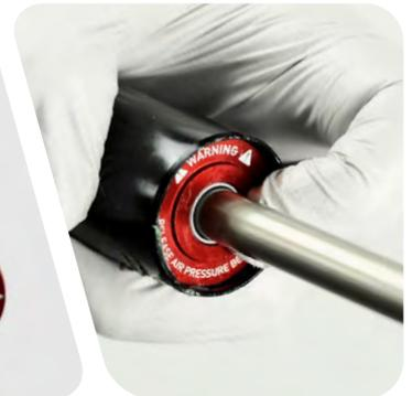
**17** Sicherungsringe haben jeweils eine Seite mit einer eckigen und einer runden Kante. Die Sicherungsringe lassen sich einfacher ein- und ausbauen, wenn die eckige Kante zum Werkzeug weist.
