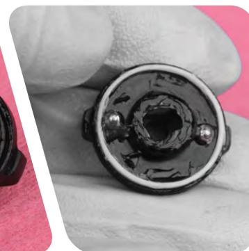
Setzen Sie den Lowspeed-Druckstufeneinstellring auf den Sperren-Einstellring auf. Bringen Sie die Befestigungsschraube an und ziehen Sie sie fest.
