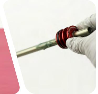
**16** Führen Sie die Luftfeder-Baugruppe in das Standrohr ein. Schieben Sie den Luftkolben fest in das Standrohr.
