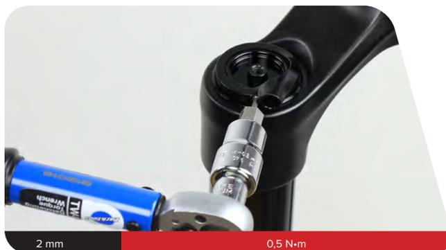
Montieren Sie den Fernbedienungsring so auf dem Sechskanteinsteller, dass die Zugstellschraube auf die 10-Uhr-Position ausgerichtet ist, in einem Winkel von ca. 30 Grad zum Mittelpunkt.
