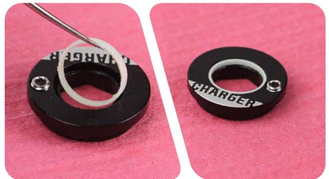
Tragen Sie Schmierfett auf den Lowspeed-Druckstufeneinstellung auf. Drücken Sie die Wölbung des Rastrings nach unten, um den Lowspeed-Druckstufeneinstellung in den Zugring einzusetzen. Drehen Sie den Einstellring um 8 bis 10 Klicks aus der offenen Position.
