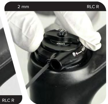
**2c** RL R: Entfernen Sie den Zuganschlagring. Entfernen Sie den Zugring.
