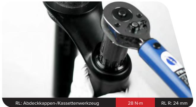
RL: Abdeckkappen-/Kassettenwerkzeug 28 N·m RL R: 24 mm
