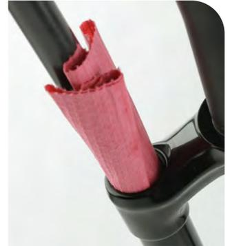
Ersetzen Sie den O-Ring oder die Dichtung durch ein neues Teil aus dem Wartungssatz. Entfernen Sie den O-Ring oder die Dichtung mit den Fingern oder einem Dorn aus Kunststoff.
