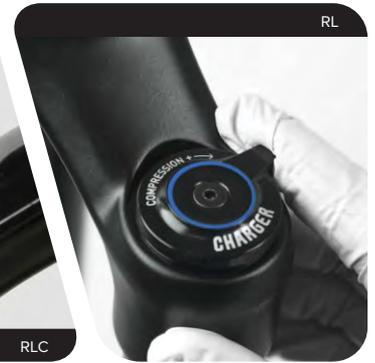
**2a** **RLC und RL:** Entfernen Sie den Lowspeed-Druckstufeneinstellung und den Sperren-Einstellung von der Abdeckkappe. Halten Sie die Teile beieinander und legen Sie sie beiseite.
