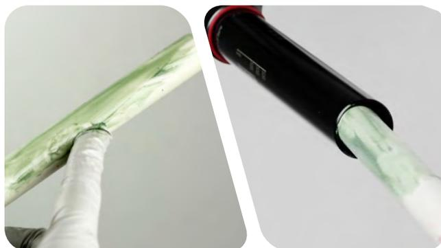
**14** Tragen Sie reichlich Schmierfett auf den Luftkolben und den oberen Anschlagpufferkegel auf.
