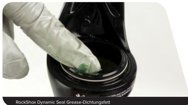
RockShox Dynamic Seal Grease-Dichtungsfett
