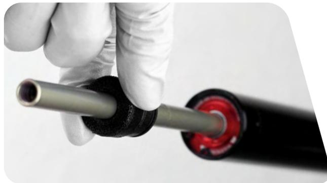
**19** Spritzen oder gießen Sie RockShox-Federungsöl in das Luftfeder-Standrohr.
