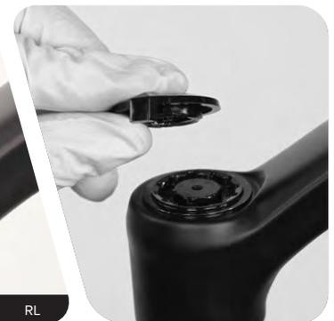
**2b** **RLC R:** Entfernen Sie den Lowspeed-Druckstufeneinstellung und die Zugring-Baugruppe. Entfernen Sie den Zuganschlagring. Halten Sie die Teile beieinander und legen Sie sie beiseite.
