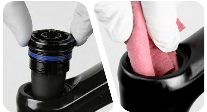
**4** Entfernen Sie den O-Ring der Abdeckkappe. Montieren Sie einen neuen O-Ring an der Abdeckkappe.
