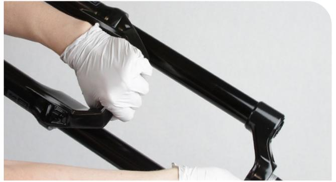
Les tiges du ressort et de la cartouche d'amortissement doivent être visibles à travers les trous des boulons inférieurs.
