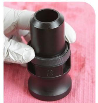
**7** Assurez-vous que les fourreaux sont bien stables sur un établi. Maintenez le fourreau en place puis enfoncez le joint anti-poussière dans le fourreau jusqu'à ce que le haut du joint affleure avec le haut du fourreau.
