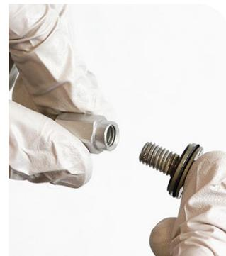
**8** Serrez une douille de 18 mm dans un étau. Placez le piston à air sur la douille. Tout en maintenant la tige à air en place, dévissez puis retirez l'écrou situé sur la tige du ressort à air.
