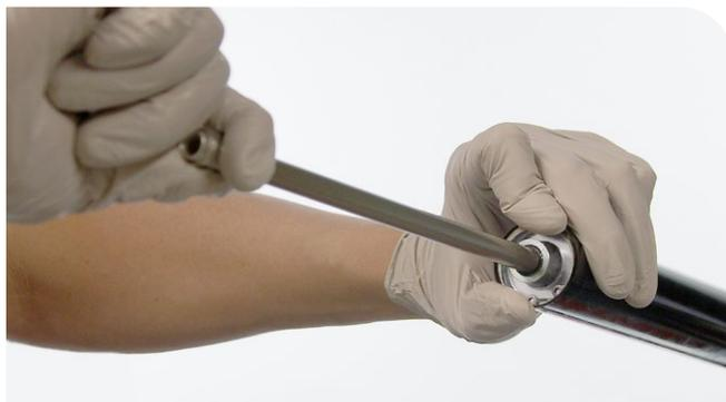
**11** Injectez ou versez du lubrifiant pour suspension à l'intérieur du plongeur du ressort à air.
