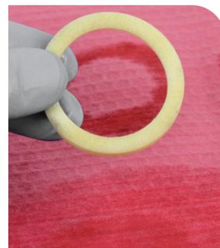
3 Faites tremper les anneaux en mousse dans de l'huile de suspension.
