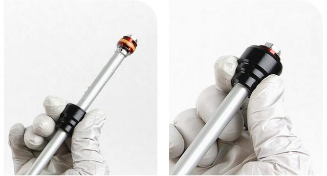
**2** Insérez la molette de réglage de la détente dans la tige de la cartouche de détente puis faites-la tourner dans le sens inverse des aiguilles d'une montre jusqu'à ce qu'elle se bloque. C'est la position d'ouverture maximale.
