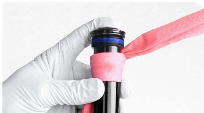
**14** Enfoncez lentement la tige de la cartouche de détente à l'intérieur du tube jusqu'à ce que le serre-câble vienne toucher la tête d'étanchéité. **N'enfoncez pas davantage la cartouche d'amortissement.**
