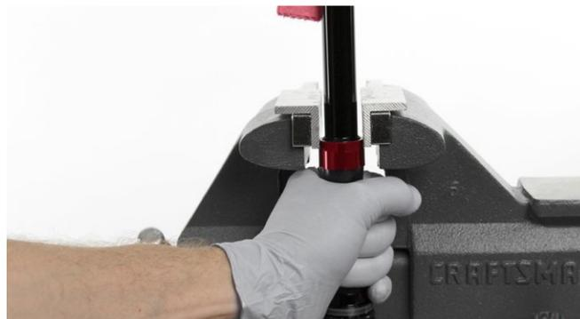
**12** Retirez le tube hors de l'étai. Tournez le tube la tête en bas et pressez la vessie jusqu'à ce que tout le produit de nettoyage et toute l'huile se soient écoulés dans le récipient prévu à cet effet.
