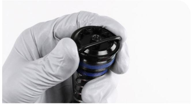
**9** L'anneau de coulissage plein n'est pas amovible et ne nécessite qu'un nettoyage. Ne le retirez pas.
