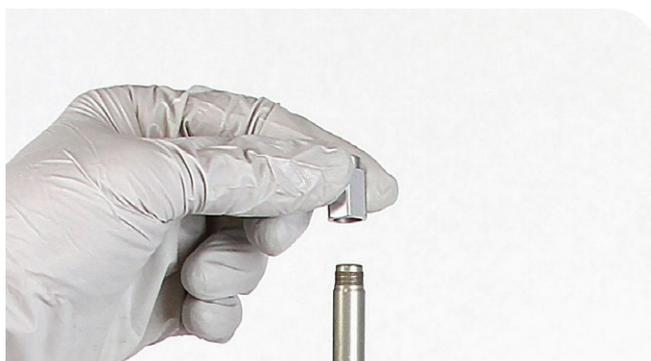
**9** Retirez la tête d'étanchéité et la butée de talonnage situées sur la tige du ressort à air. Jetez la tête d'étanchéité.
