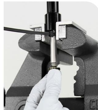
**1** Le serre-câble doit se trouver à **19 mm** de l'extrémité de la tige. **Ne compressez pas davantage la cartouche de détente.**
