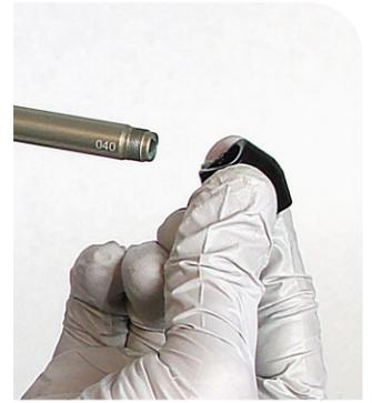
**10** Retirez le joint quadrilobe situé sur le piston à air puis jetez-le.
