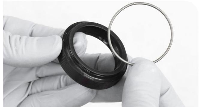
**6** Insérez la partie étroite du joint anti-poussière neuf dans la partie creuse de l'outil d'installation des joints anti-poussière de 38 mm.
