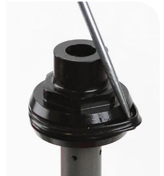
Appliquez de la graisse sur les joints toriques neufs, puis mettez-les en place.
