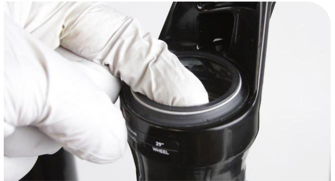
**3** Faites coulisser l'unité des fourreaux sur les plongeurs de manière à ce que seules les bagues supérieures s'engagent dans les plongeurs.
