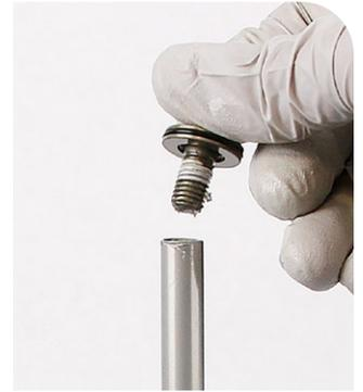
**1** Tout en comprimant la cartouche d'amortissement, faites tourner la tige de compression dans le sens des aiguilles d'une montre à l'aide d'une douille de 13 mm jusqu'à ce qu'elle se bloque sur la position « ferme ».
