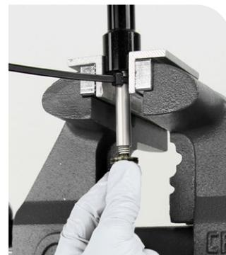
**1** À l'aide de la molette de réglage, faites tourner la tige de la compression dans le sens des aiguilles d'une montre jusqu'à ce qu'elle se bloque sur la position « ferme ».
