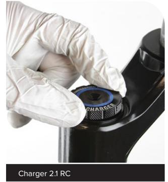
**2** Montieren Sie den Lowspeed-Druckstufeneinstellung auf der Sechskantstange des Einstellers.
