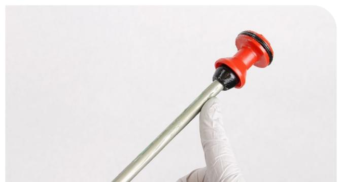
**4** Tragen Sie Schmierfett auf die neue innere Dichtung des Dichtkopfs auf.
