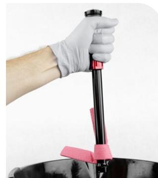
10 Spannen Sie das Patronenrohr wieder mit den Schlüsselflanken des Membran-Kupplungsstücks in den Schraubstock ein.
