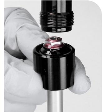
**6** Entfernen Sie den Dichtkopf von der Zugstufendämpfer-Führungsstange.
