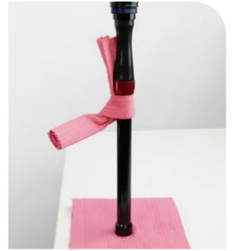
**13** Trocknen Sie das Patronenrohr und die Druckstufendämpfer-Baugruppe mit Druckluft.
