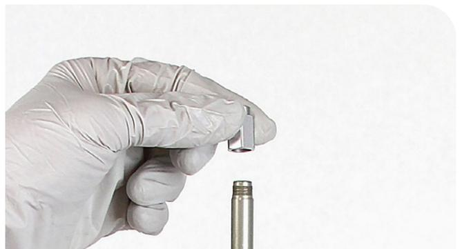
**6** Entfernen Sie den Dichtkopf und den oberen Federweg-Anschlagpuffer von der Luftfeder-Führungsstange. Entsorgen Sie den Dichtkopf.
