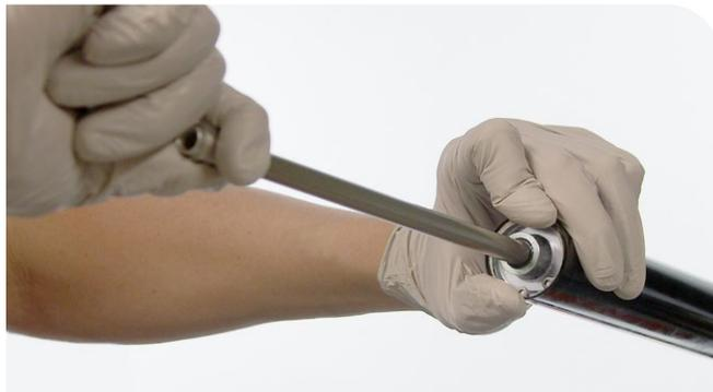
**11** Spritzen oder gießen Sie Federungsöl in das Luftfeder-Standrohr.
