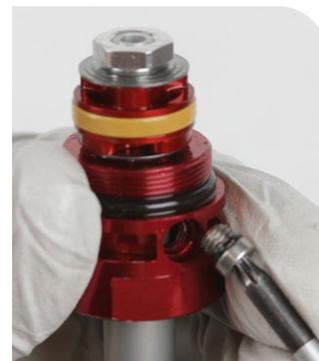
9 Entfernen Sie das Patronenrohr aus dem Schraubstock und lassen Sie das Öl in eine Ölauffangwanne ablaufen.
