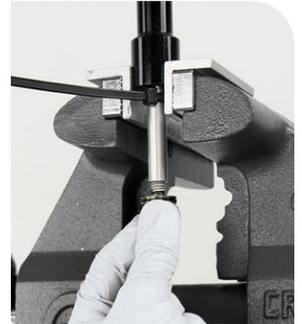
**1** Drehen Sie die Druckstufenocke mit dem Einstellring bis zum Anschlag im Uhrzeigersinn in die feste Position.
