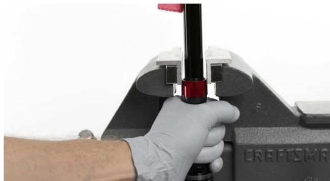
**12** Entnehmen Sie das Patronenrohr aus dem Schraubstock. Richten Sie das Patronenrohr nach unten aus und drücken Sie die Membran zusammen, bis das Reinigungsmittel und etwaiges restliches Öl in eine Ölauffangwanne abgelaufen sind.
