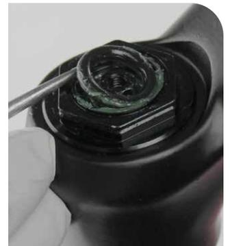
**3** **RL R** : desserrez la vis de fixation puis retirez la bobine et le collier d'arrêt du câble.
