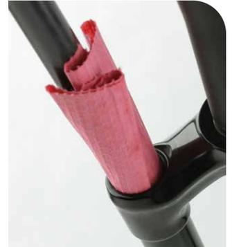
Remplacez le joint ou joint torique par un neuf fourni dans le kit d'entretien. Avec vos doigts ou en le piquant avec une pointe en plastique, retirez le joint ou joint torique usagé.
