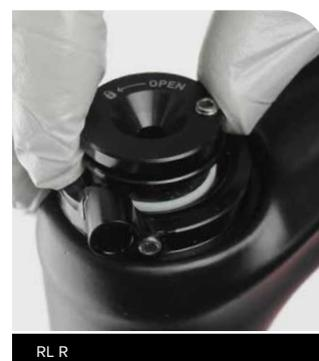
Installez la vis de maintien de la bobine du rappel à distance puis serrez-la.
