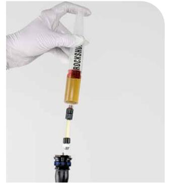
Relâchez le piston pour que l'air se purge dans la seringue. Comprimez le piston et relâchez-le pour injecter de l'huile dans la cartouche d'amortissement. Remplissez la seringue quand il le faut.
