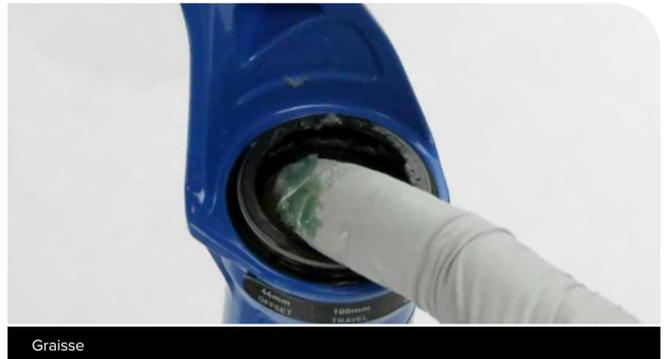
**3** Si nécessaire, installez la butée de talonnage sur la tige du ressort à air. Installez la coupelle inférieure, avec son côté à épaulement tourné vers le bas, dans le fourreau du côté du ressort.
