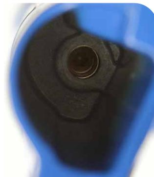
**Ultimate** : à l'aide d'une clé de 5 mm, guidez la tige de la cartouche d'amortissement à travers le trou du fourreau. Repoussez le fourreau sur l'unité té-plongeurs jusqu'à ce que le filetage de la tige de la cartouche soit visible.
