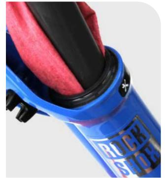
**6** Installez les bagues en mousse sous les joints racleurs. Vérifiez que les bagues en mousse sont parfaitement mises en place dans l'espace situé sous les joints racleurs et qu'elles ne débordent pas par-dessus les douilles. Installez le ressort métallique.
