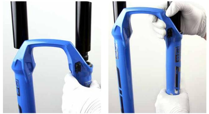
La base interne des fourreaux ne doit pas entrer en contact avec les tiges du ressort ou de la cartouche. Un espace doit être visible entre les extrémités des tiges et les trous des vis des fourreaux.
