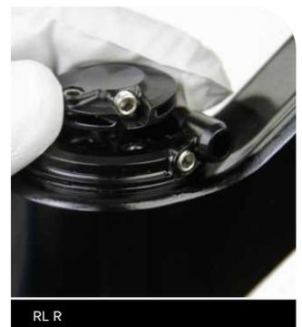
Serrez la vis de fixation.
