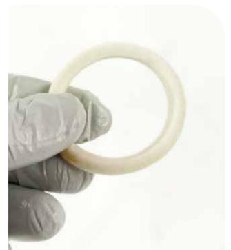
**4** Faites tremper les bagues en mousse dans de l'huile de suspension.
