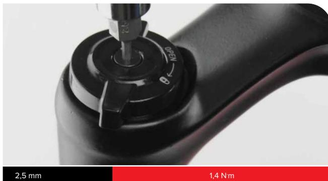
**4** **RL R** : installez le collier d'arrêt du câble avec le guide de la gaine tourné vers l'avant. Serrez la vis de fixation.
