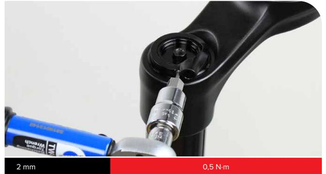
Installez la bobine de rappel à distance sur le régleur hexagonal en orientant la vis de fixation du câble dans la plage de 20° indiquée dans le schéma.
