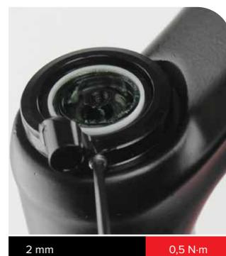
Installez la bobine du rappel à distance sur le régleur hexagonal avec la vis de fixation du câble positionnée dans un angle de  $\approx 110^\circ$  par rapport au guide de la gaine.
