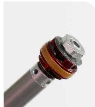
**12** Appliquez de la graisse sur un joint torique interne neuf pour tête d'étanchéité. Mettez la tête d'étanchéité en place sur la tige de la cartouche de détente.
