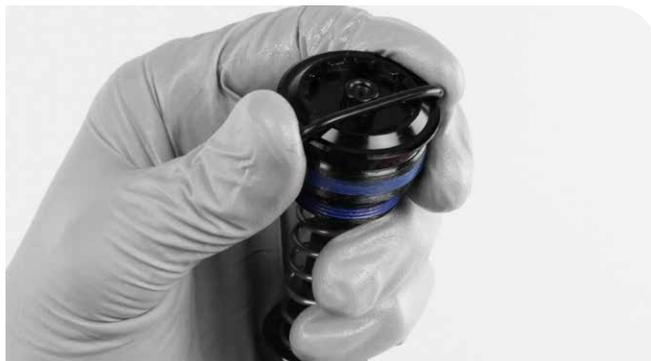
**8** **Anneau de coulissage fendu** : Remplacez l'anneau de coulissage sur le piston de la cartouche de détente.
