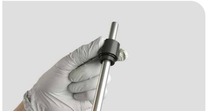
**11** **Anneau de coulissage fendu** : Remplacez l'anneau de coulissage sur le piston de la cartouche de détente.
