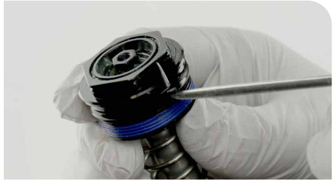
**8** Appliquez de la graisse sur le joint interne et la bague situés à l'intérieur de la tête d'étanchéité de la cartouche de détente neuve.
