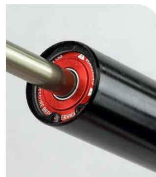
**18** Mettez en place la butée de talonnage sur la tige pneumatique.
