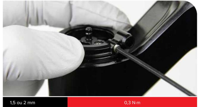
Installez la bobine de rappel à distance en orientant la vis de fixation du câble dans la plage de  $20^\circ$  indiquée dans le schéma.
