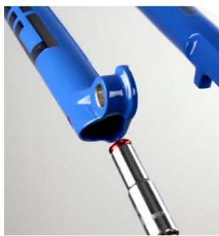
Ultimate: 10 mm Dämpferseite
