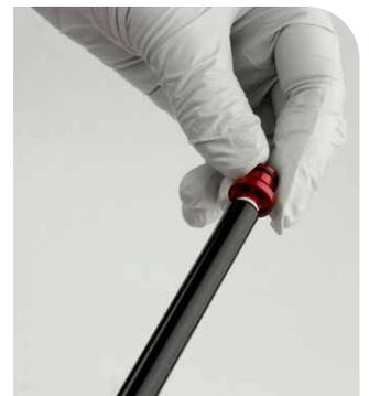
**4** Aplique sellaroscas Loctite Blue 242 o equivalente a dos o tres roscas del tubo del cartucho (A).
