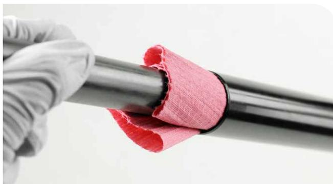
**10** Retire el cabezal de sellado del eje neumático.
