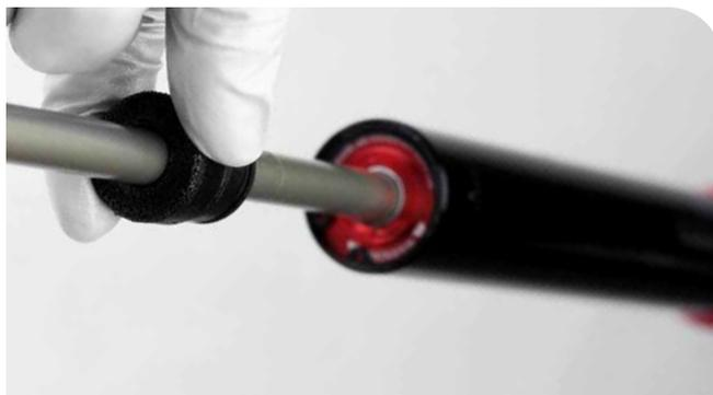
**19** Inyecte o vierta aceite para suspensiones RockShox dentro del tubo superior del resorte neumático.
