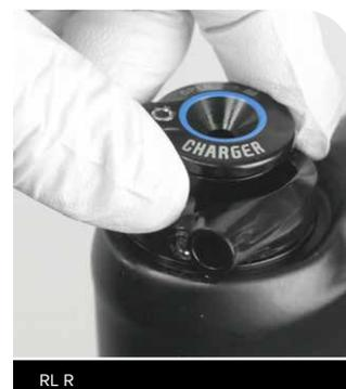
Instale y apriete el tornillo de retención del carrete del control remoto. Consulte el manual de usuario correspondiente en [www.sram.com/service](http://www.sram.com/service) para obtener instrucciones de instalación del cable y el control remoto.
