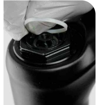
**4** Desensrosque la tapa superior del amortiguador y retire el conjunto del amortiguador.
