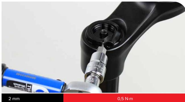
Instale el carrete del control remoto en el ajustador hexagonal con el tornillo de fijación del cable orientado dentro del intervalo de 20 grados indicado en el diagrama.
