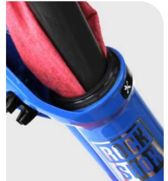
**6** Instale los anillos de gomaespuma debajo de las juntas antipolvo. Confirme que los anillos de gomaespuma quedan colocados uniformemente en el espacio debajo de las juntas antipolvo y que no sobresalen de los cojinetes. Instale la arandela de alambre.
