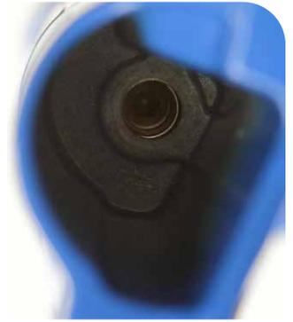
**Ultimate:** Use una llave de 5 mm para guiar el eje del amortiguador a través del orificio del brazo inferior. Empuje el brazo inferior un poco más hacia la corona superior, hasta que las roscas del eje del amortiguador queden expuestas.
