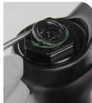
**3** **RL R:** Afloje el tornillo de fijación y retire el carrete del cable y el collarín de tope del cable.
