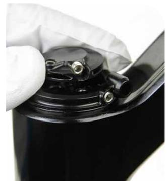
**RL R:** Afloje el tornillo del collarín de tope del cable y retire el collarín.
