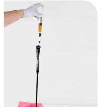
**9** Empuje el mango de la jeringa hacia abajo y luego suelte el émbolo. Deje que la cámara flexible alcance una posición de reposo natural; para ello, espere un momento hasta que la jeringa deje de llenarse.
