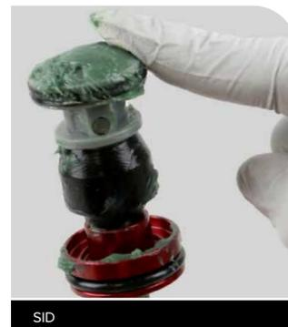
**16** Inserte el conjunto de resorte neumático en el tubo superior. Empuje firmemente el pistón neumático dentro del tubo superior.
