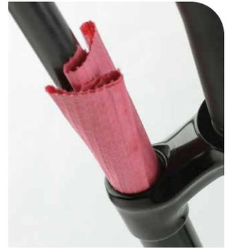
Sustituya la junta tórica o de estanqueidad por otra nueva del kit de mantenimiento. Utilice los dedos o un punzón de plástico para perforar y retirar la junta tórica o de estanqueidad antiguas.
