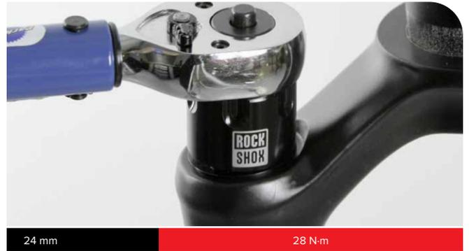
**2** Algunas tapas superiores de amortiguador tienen una ranura alrededor del ajustador hexagonal. Las tapas superiores de amortiguador con ranura deben usarse con un carrete que también tenga una ranura.
