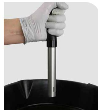
**8** Pulverice limpiador de suspensiones RockShox o alcohol isopropílico en el tubo del cartucho.
