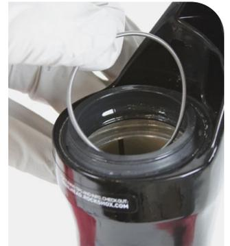
**2** Fixieren Sie das untere Gabelbein in einer Werkbank. Platzieren Sie die Spitze eines Downhill-Reifenhebers unter der Abstreiferdichtung. Drücken Sie den Downhill-Reifenheber nach unten, um die Dichtung zu entfernen.
