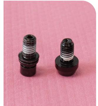
**7** Setzen Sie die massive (nicht hohle) untere Schraube in die Führungsstange auf der Federseite ein.
