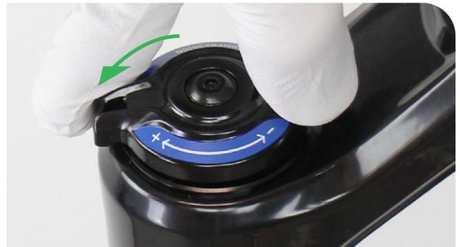
Entfernen Sie die Befestigungsschraube und danach den Druckstufendämpfer-Einstellring.
