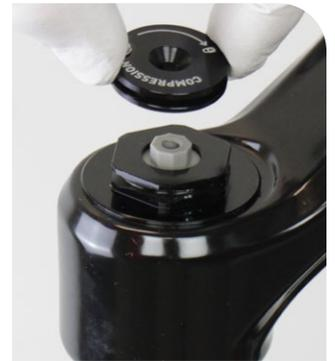
**3 RC / RC R:** Schrauben Sie die Druckstufendämpfer-Abdeckkappe ab. Drücken Sie die Abdeckkappe beim Lösen fest nach unten.
