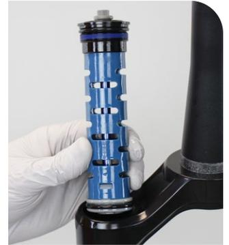
**R:** Lösen und entfernen Sie die Abdeckkappen/Zugstufen-Öldistanzstück-Baugruppe. Drücken Sie die Abdeckkappe beim Lösen fest nach unten.
