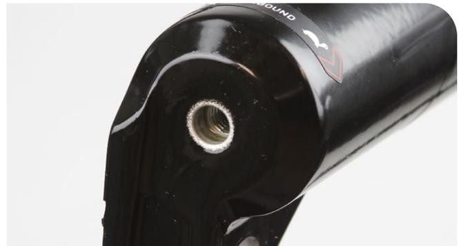
**6** **200-Stunden-Wartung** Entfernen Sie die alten Sprengringe von den unteren Schrauben.
