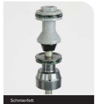
**8** Führen Sie die Luftfeder-Baugruppe in das Standrohr ein. Schieben Sie den Luftkolben fest in das Standrohr.
