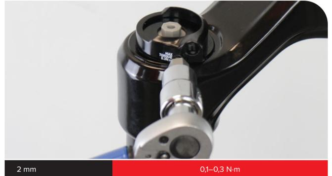
Montieren Sie den Fernbedienungsring (A) so auf den Sechskanteinsteller, dass die Zugklemmschraube (B) 20 bis 40 Grad vom Rand der Zuganschlagnut zur Vorderseite des Gabelkopfs ausgerichtet ist.
