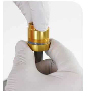
**8** Retire el eje del amortiguador de los bloques adaptadores de tornillo de banco de banco.
