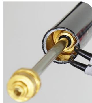
**Lyrik y Pike:** Levante los dos extremos de las clavijas desde el centro del anillo con objeto de abrir el anillo de retención para su instalación.
