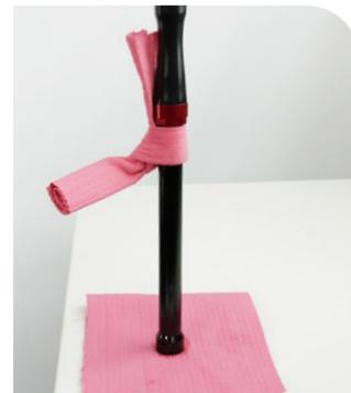
**11** Seque el tubo del cartucho y el conjunto del amortiguador de compresión con aire comprimido.
