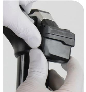
Si oye clics o nota que el motor traquetea, significa que el módulo de control está mal instalado. Puede que no estén bien alineadas las chavetas del motor de salida y del amortiguador de compresión.
