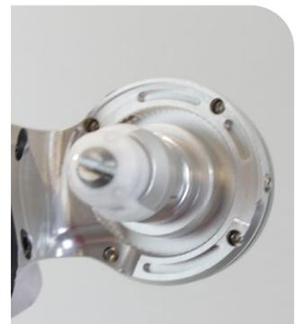
Si el ajuste de la alineación no se ha realizado correctamente, retire el módulo de control, alinee las chavetas del motor de salida y de compresión, y vuelva a instalar el módulo de control en la tapa superior del amortiguador de compresión. Repita los pasos 1 a 5 del procedimiento de instalación del módulo de control.
