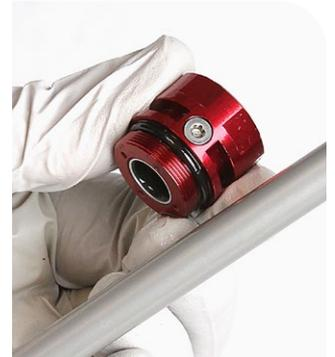
**7** Retire el tornillo de purgado del cabezal de sellado.
