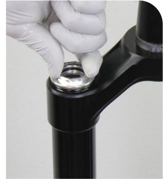
Enrosque la tapa superior en el tubo superior y apriétela. Presione fuerte hacia abajo mientras la aprieta.
