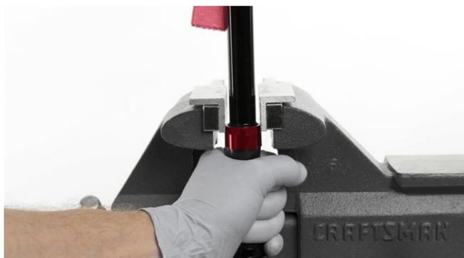
**10** Retire el tubo del tornillo de banco. Oriente el tubo del cartucho hacia abajo y apriete la cámara flexible hasta que caiga el limpiador y cualquier resto de aceite en un recipiente para recoger el aceite.
