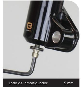
**6** Golpee la cabeza de cada uno de los pernos para que se desprendan del brazo inferior los ButterCups del eje del amortiguador y del resorte neumático. La cabeza del perno debe estar en contacto con la parte de abajo del brazo inferior.
