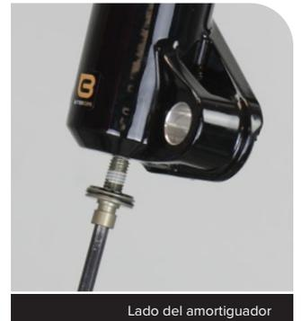
**7** Tire con fuerza hacia abajo del brazo inferior, hasta que empiece a caer líquido. Siga tirando hacia abajo para extraer el brazo inferior.
