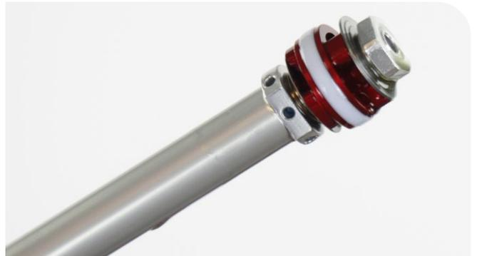
**10** Aplique grasa a la junta interior y al casquillo del nuevo cabezal de sellado del amortiguador de rebote.
