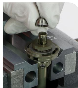
**14** Retire el conjunto del amortiguador de compresión y el tubo del IFP del tornillo de banco.
