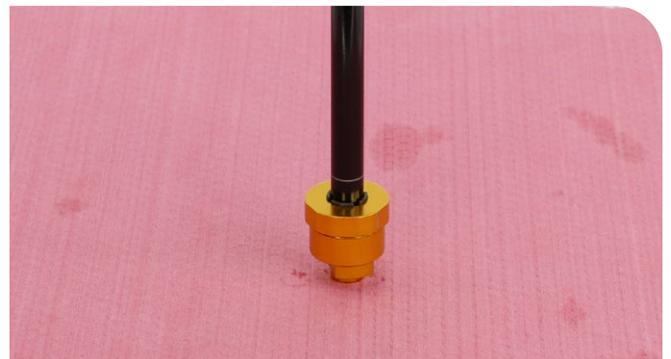
**3** Para purgar el aceite de la parte superior del IFP, comprima manualmente el IFP en el tubo del IFP con el resorte del IFP, mientras que el amortiguador de rebote se comprime y descomprime en el tubo del amortiguador de cartucho.
