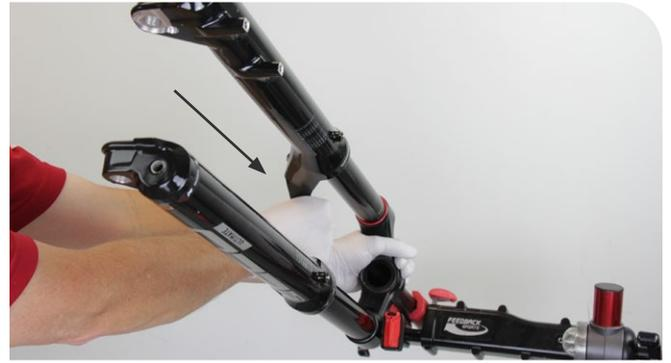
El resorte neumático y el eje del amortiguador o los ButterCups (Ultimate) deben poder verse a través de los orificios de los pernos inferiores.
