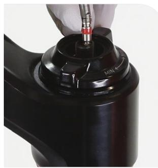
Herramienta para válvulas Schrader RockShox Dual Position Air
