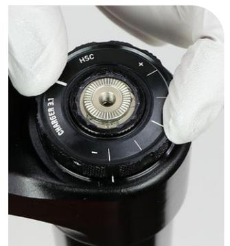
Gire a tope la leva del regulador de LSC **en sentido horario** con una llave Allen de 2,5 mm.
