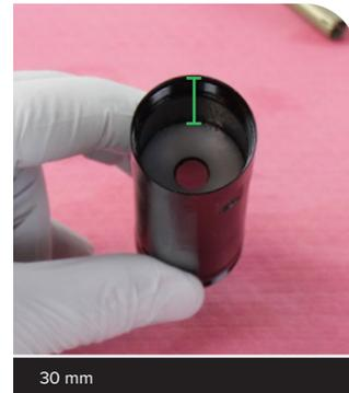
**4 Actualización de Charger 3 a Charger 3.1:** Si el amortiguador de compresión Charger 3 se actualiza a Charger 3.1 RC2, instale el nuevo conjunto de eje del amortiguador de compresión/pistón Charger 3.1 RC2 actualizado.
