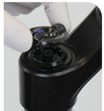
**Charger RL3R:** Afloje el tornillo de fijación y retire el carrete del cable y su collarín de tope.
