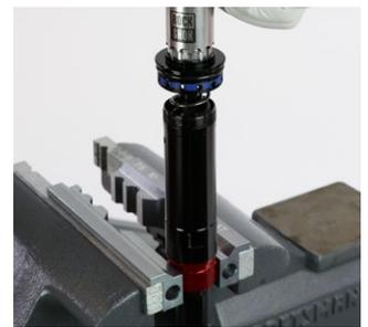
**2** Retire la tapa superior y el resorte del IFP del tubo del IFP.
