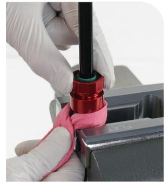
**Cabezal de sellado de rebote de dos piezas:** Desenrosque la parte roja del cabezal de sellado del tubo del cartucho.
