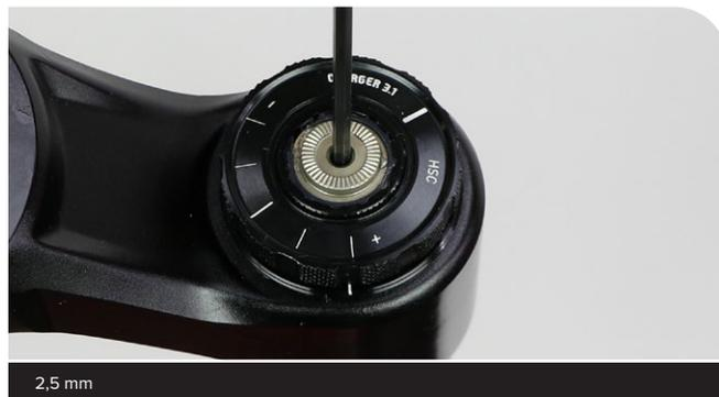
Instale y coloque el mando del regulador de LSC, de forma que las marcas de alineación de LSC (A) y de HSC (B) queden como se muestra en la imagen.
