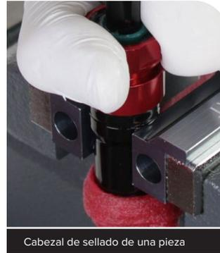
Cabezal de sellado de una pieza
