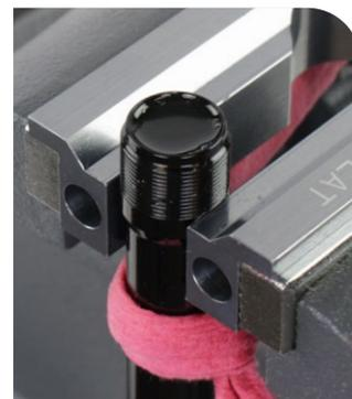
**8** Aplique grasa a la junta antipolvo del nuevo conjunto de cabezal de sellado del amortiguador de rebote.
