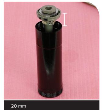
**5 Actualización de Charger 3 a Charger 3.1:** Si el amortiguador de compresión Charger 3 se actualiza a Charger 3.1 RC2, instale el nuevo conjunto de tubo de compresión de alta velocidad (HSC)/leva de compresión de baja velocidad (LSC) Charger 3.1 incluido en el kit de actualización.
