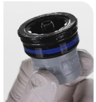
**6 ZEB Ultimate (en la foto):** Coloque un trozo de tubo de plástico cortado, o una toalla de taller, alrededor del eje del resorte neumático para proteger la superficie del eje durante la extracción.
