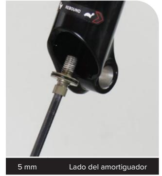
**11** Tire con fuerza hacia abajo del brazo inferior, hasta que empiece a caer líquido. Siga tirando hacia abajo para extraer el brazo inferior.
