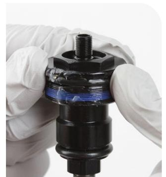
**7** Empuje el eje neumático inferior en el tubo superior para evitar que se raye al retirar el anillo de retención.
