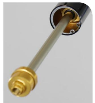
Coloque un trozo de tubo de plástico cortado, o una toalla de taller, alrededor del eje del resorte neumático para proteger la superficie del eje durante la instalación.
