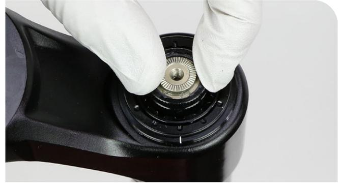
Instale el mando de HSC (GRANDE) y alinee la marca (+) (A) con la marca de alineación (B) en la placa de retención de la parte posterior de la corona. Consulte el diagrama anterior.
