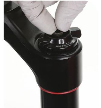
Enrosque la tuerca de retención del mando en el cuerpo roscado de la válvula de aire y apriete dicha tuerca.
