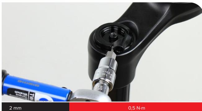
Instale el carrete del control remoto en el regulador hexagonal, con el tornillo de fijación del cable dentro del intervalo de 20 grados indicado en el diagrama.
