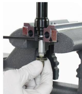
**1** Utilice el mando del regulador para girar a tope la leva de compresión en sentido horario, hasta la posición firme.
