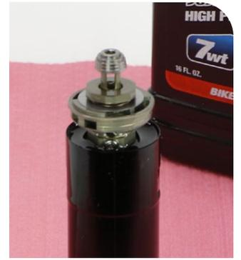
**12** Coloque una toalla de taller alrededor del tubo del IFP. Empuje el pistón hacia abajo dentro del tubo del IFP hasta que se detenga.
