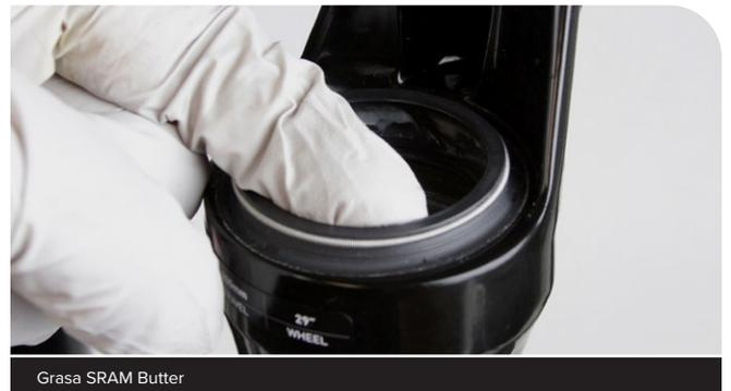
**3** Instale el conjunto del brazo inferior en los tubos superiores y deslícelo lo justo para encajar los casquillos superiores en los tubos superiores.
