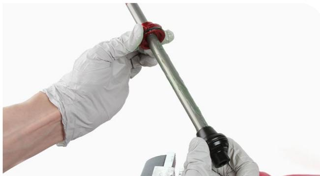
**6** Aplique grasa a las juntas tórica y de estanqueidad exteriores del pistón neumático y el cabezal de sellado.
