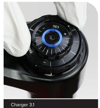
**2** Quite el tornillo de retención del mando de compresión de baja velocidad (LSC).
