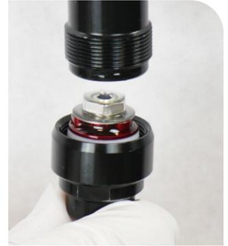
**6** Retire el cabezal de sellado del eje del amortiguador de rebote. Deseche el cabezal de sellado.
