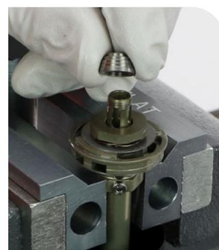
**14** Entfernen Sie die Druckstufendämpfer-Baugruppe und das IFP-Rohr aus dem Schraubstock.
