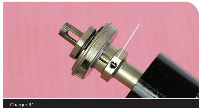
**7** Bringen Sie Nockeneinsteller-Klemmschraube (2 Stücke) gleichmäßig handfest an. Ziehen Sie beide Klemmschrauben mit dem angegebenen Drehmoment fest.
