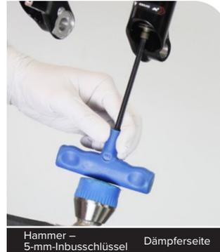
Hammer – 5-mm-Inbusschlüssel Dämpferseite
