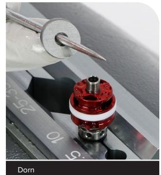
**3** Ordnen Sie den neuen Zugstufenabstimmungs-Federplättchenstapel in der Reihenfolge der gewünschten Abstimmung an. Verwenden Sie die nachfolgende Spezifikation für die Federplättchenabstimmung.
