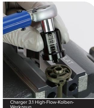
Charger 3.1 High-Flow-Kolben-Werkzeug
