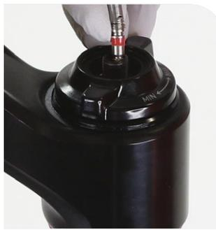
RockShox-Schrader-Ventilwerkzeug Dual Position Air
