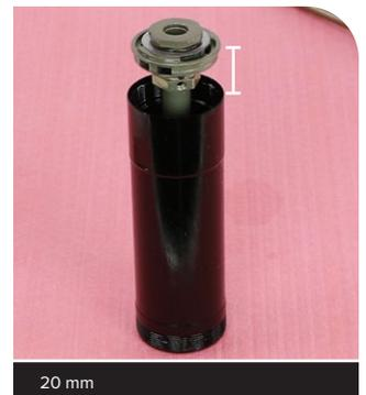
**5 Upgrade von Charger 3 auf Charger 3.1:** Wenn der Charger 3 Druckstufendämpfer auf Charger 3.1 RC2 aufgerüstet wird, bauen Sie das neue Upgrade mit der im Upgrade-Kit enthaltenen Baugruppe mit High-Speed-Druckstufenrohr (HSC) und Low-Speed-Druckstufen-Nockeneinsteller (LSC) ein.
