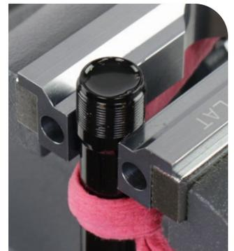
**8** Tragen Sie Schmierfett auf die Abstreiferdichtung an der neuen Zugstufendämpfer-Dichtkopf-Baugruppe auf.
