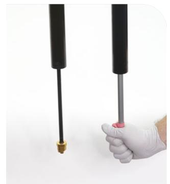
**4** Entfernen Sie die Sicherungsmutter des Federweg-Einstellrings.
