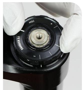
Drehen Sie die Einstellnocke des Lowspeed-Druckstufeneinstellers mit einem 2,5-mm-Inbusschlüssel **im Uhrzeigersinn** bis zum Anschlag.
