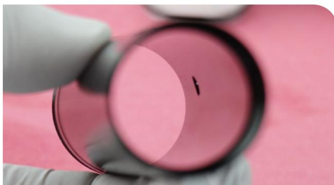
**19** Entfernen Sie den inneren und den äußeren O-Ring des IFP und entsorgen Sie die O-Ringe.
