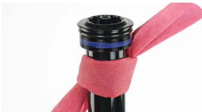
**14** Schieben Sie die Zugstufendämpfer-Führungsstange langsam in das Rohr, bis der Kabelbinder den Dichtkopf berührt, und stoppen Sie dann. **Schieben Sie den Dämpfer nicht weiter hinein.**
