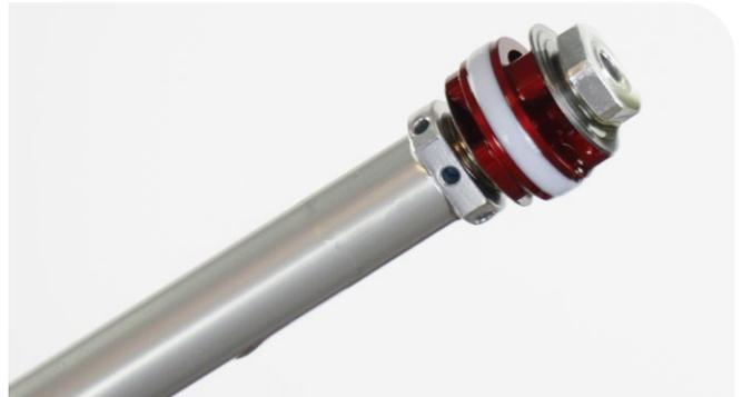
**10** Tragen Sie Schmierfett auf die innere Dichtung und die Buchse im neuen Zugstufendämpfer-Dichtkopf auf.
