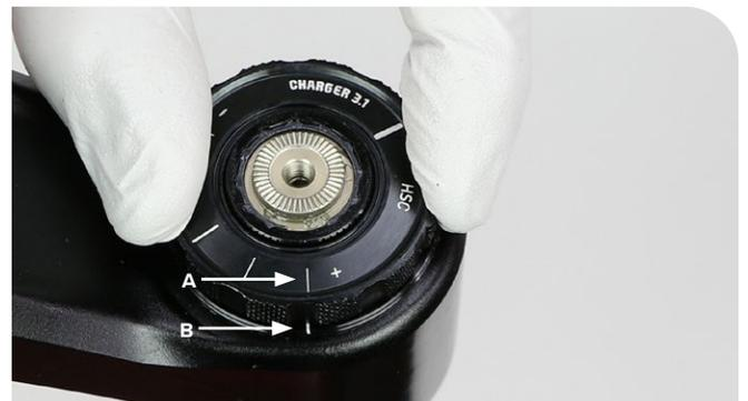
Ziehen Sie die Klemmschraube des Highspeed-Druckstufeneinstellers (HSC) fest.
