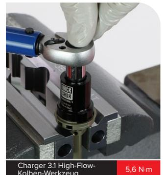
Charger 3.1 High-Flow-Kolben-Werkzeug
