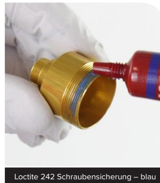
Loctite 242 Schraubensicherung – blau
