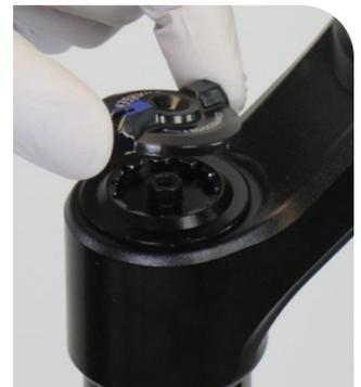
**Charger RL3R:** Lösen Sie die Klemmschraube und entfernen Sie den Zugring und den Zuganschlagring.
