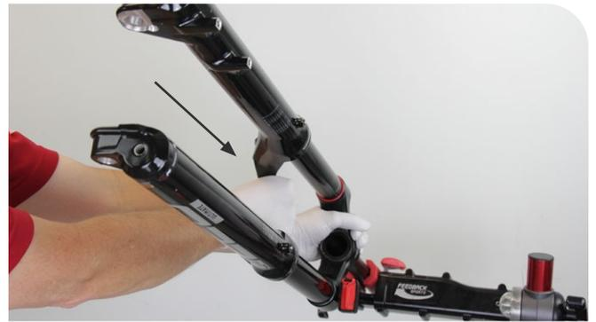
Die Luftfeder- und Dämpferführungsstange oder der/die ButterCups(s) (Ultimate) sollten durch die Bohrungen für die unteren Schrauben sichtbar sein.
