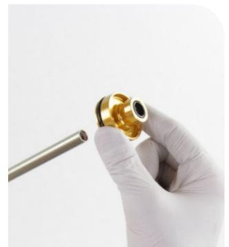
**3** Nur **Select+**, **Select**, **Base**: Spannen Sie die neue (längere oder kürzere) Luftfeder-Führungsstange mit nach unten ausgerichtetem Luftkolben im 10-mm-Schlitz der Reverb-Schraubstockblöcke oder des RockShox Hinterbaudämpfer-Schraubstockblocks ein.
