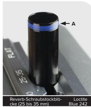
Reverb-Schraubstockblöcke (25 bis 35 mm) Loctite Blue 242
