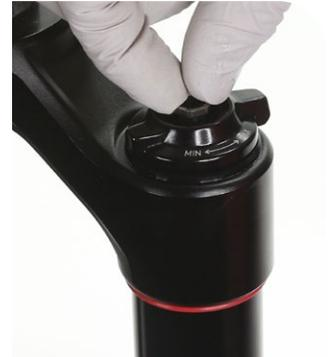
Schrauben Sie die Sicherungsmutter des Einstellrings auf das Gewinde des Luftventilkörpers und ziehen Sie sie fest.
