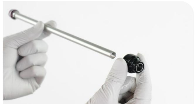
**7** Sprühen Sie RockShox Suspension Cleaner oder Isopropyl-Alkohol in das Patronenrohr und reinigen Sie die Innenseite des Rohrs mit einem sauberen Werkstatttuch und einer dünnen Stange ( $\leq 16$  mm Durchmesser).
