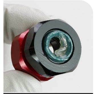
SRAM Butter-Schmierfett Zweiteiliger Dichtkopf
