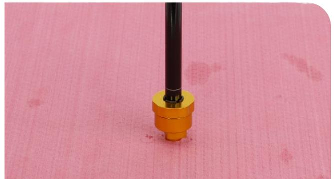
**3** Um Öl von oberhalb des IFP abzulassen, muss der IFP manuell mit der IFP-Feder im IFP-Rohr zusammengedrückt werden, während der Zugstufendämpfer im Patronendämpferrohr zusammengedrückt und durchbewegt wird.
