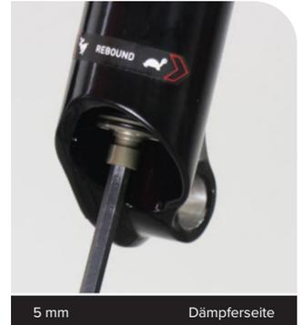
**10** Schlagen Sie auf jeden Schraubenkopf, um die Feder und die ButterCups der Dämpferführungsstange vom unteren Gabelbein zu trennen. Der Schraubenkopf sollte die Unterseite des unteren Gabelbeins berühren.
