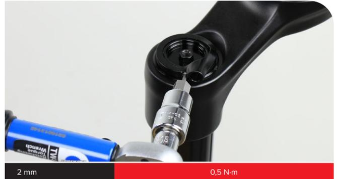
Montieren Sie den Fernbedienungsring so auf dem Sechskanteinsteller, dass sich die Zugklemmschraube in dem in der Abbildung dargestellten 20-Grad-Bereich befindet.
