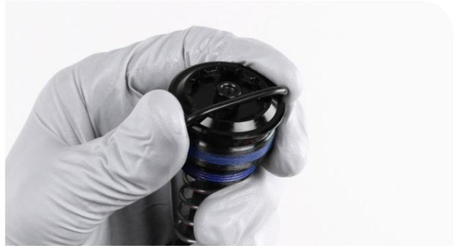
**9** Der massive Gleitring ist nicht ausbaubar und muss lediglich gereinigt werden. Entfernen Sie ihn nicht.
