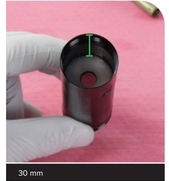
**4 Upgrade von Charger 3 auf Charger 3.1:** Wenn der Charger 3 Druckstufendämpfer auf Charger 3.1 RC2 aufgerüstet wird, bauen Sie das neue Upgrade mit Charger 3.1 RC2 Druckstufendämpferschaft/ Kolben-Baugruppe ein.
