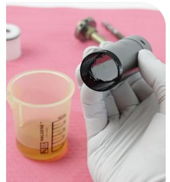
**3** Führen Sie den IFP in das IFP-Rohr und setzen Sie ihn mit dem flachen Ende/äußeren O-Ring voran in das Ende des IFP-Rohrs mit dem Außengewinde ein.
