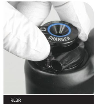
Bringen Sie die Befestigungsschraube des Fernbedienungsringes an und ziehen Sie sie fest.
