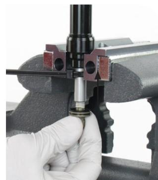
**1** Drehen Sie die Druckstufennocke mit dem Einstellring bis zum Anschlag im Uhrzeigersinn in die feste Position.
