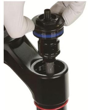
**6** Entfernen Sie den Abdeckkappen-O-Ring und entsorgen Sie ihn. Geben Sie Schmierfett auf einen neuen O-Ring und setzen Sie ihn ein.
