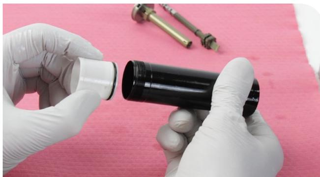
**18** Säubern Sie das IFP-Rohr und überprüfen Sie es auf Kratzer. Legen Sie das IFP-Rohr beiseite.
