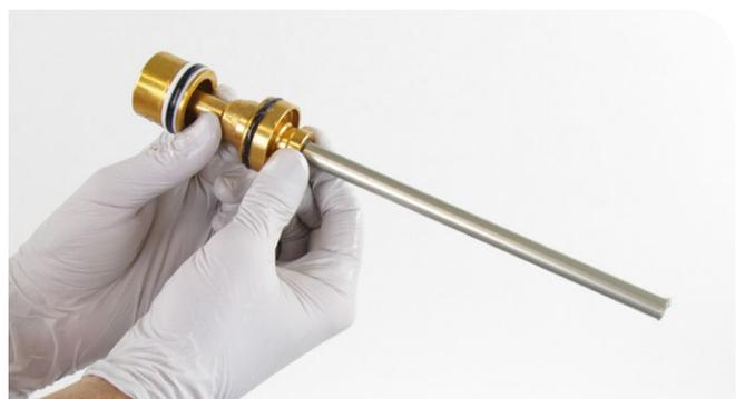
9 Entfernen Sie das Schmierfett vom inneren Führungstangengewinde.
