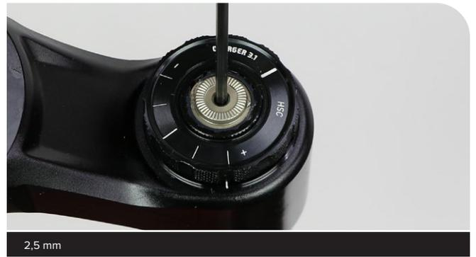
Installieren und positionieren Sie den Lowspeed-Druckstufeneinstellung (LSC) und richten Sie ihn wie abgebildet auf die Markierungen LSC (A) und HSC (B) aus.
