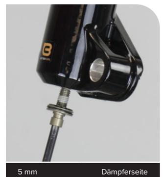
**Pike 27,5" und 29", Lyrik 29":** Führen Sie einen 5-mm-Inbusschlüssel in die Schraube ein und klopfen Sie auf den Schlüssel, um Schäden am unteren Gabelbein zu vermeiden.
