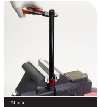
Entfernen Sie das Kartuschenrohr.
