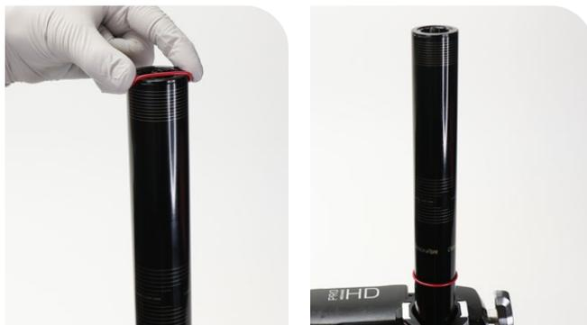
**MANTENIMIENTO CADA 100 HORAS** Continúe con [Instalación del brazo inferior](#) para instalar el tubo superior del lado del resorte neumático en el brazo inferior.
