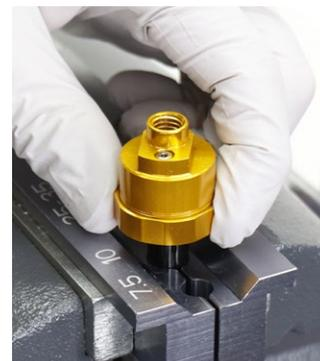
**7** Saque el eje del amortiguador de rebote de los bloques adaptadores de tornillo de banco.
