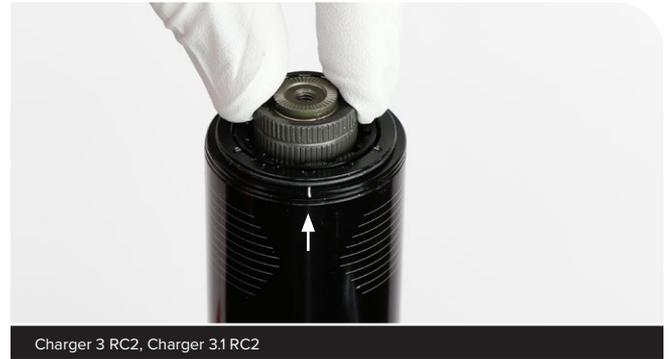
Instale el mando de HSC y alinee la marca (+) (A) con la marca (B) de la placa de retención.
