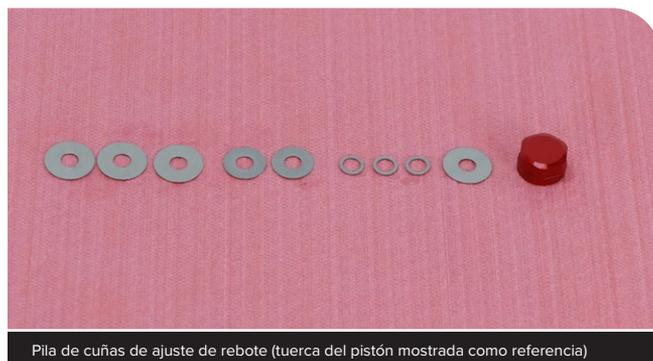
Pila de cuñas de ajuste de rebote (tuerca del pistón mostrada como referencia)
