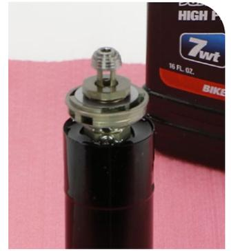
**12** **Charger 3 RC2, Charger 3.1 RC2 (actualizado):** Coloque una toalla de taller alrededor del tubo del IFP.
