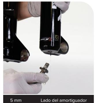
**15** Empuje hacia abajo el brazo inferior hasta que empiece a caer aceite. Siga empujando hacia abajo para extraer el brazo inferior.
