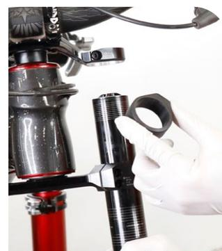
**10** Deslice los tubos superiores fuera de la corona inferior y retire la horquilla de la bicicleta.
