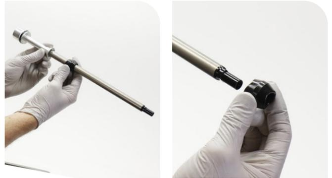
**2** Limpie el eje del resorte neumático y compruebe si presenta desgaste o daños.
