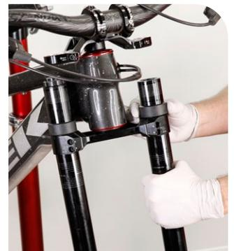
**6** Deslice un tubo superior, de cualquier lado, hacia arriba dentro de la corona superior hasta que el borde superior de la corona inferior quede en su posición original, alineado con la marca de altura de la corona del tubo superior. Apriete el perno de la corona inferior con los dedos.
