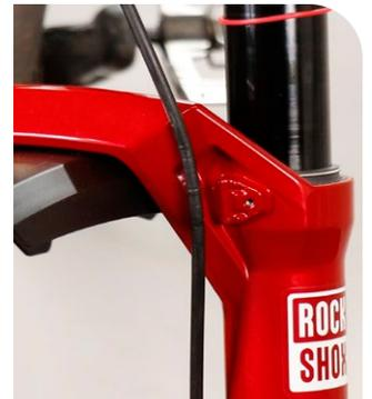
**6** Introduzca un espaciador de pastillas de freno en la pinza de freno para evitar que avancen los pistones de la pinza.
