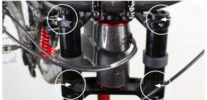
Posición de la marca de altura de la corona/tubo superior
