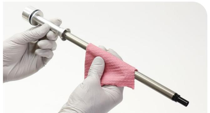
**3** Retire la arandela de refuerzo gruesa (superior), la junta de anillo cuádruple y la arandela de refuerzo fina (inferior) del pistón neumático.
