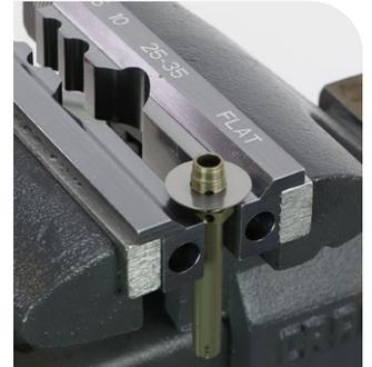
**7** Instale el pistón de caudal alto en el eje del amortiguador de compresión y apriételo al par especificado.
