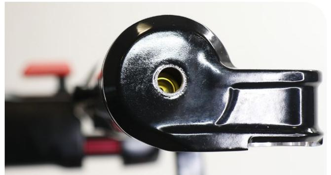
**6** Instale el tubo superior del lado del resorte neumático en el brazo inferior. Inserte el tubo superior en el brazo inferior lo justo para acoplar el casquillo superior.
