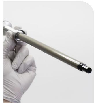
**8** Aplique grasa a la junta cuádruple interior e instálela en el cabezal de sellado.
