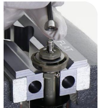
**12** Retire el conjunto del amortiguador de compresión y el tubo del IFP del tornillo de banco.
