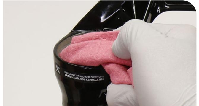
**4** Sumerja los anillos de gomaespuma nuevos en aceite para suspensiones Maxima PLUSH Dynamic Suspension Lube Light. Instale los anillos de gomaespuma nuevos en el brazo inferior.
