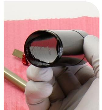
**3** Introduzca e instale el IFP en el tubo del IFP, con el extremo plano/junta tórica exterior primero, en el extremo roscado externo del tubo del IFP.
