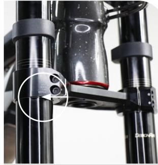
Posición de la marca de altura de la corona/tubo superior - Lado del amortiguador
