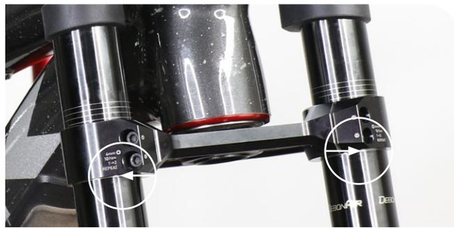
Posición de la marca de altura de corona inferior/corona tubo superior
