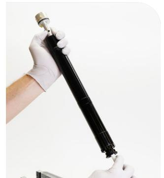
**Cambio de recorrido y actualización del ButterCups:** Deje a un lado el conjunto del resorte neumático original. No se volverá a instalar.
