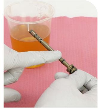
**6 Charger 3 RC2:** Alinee el orificio del tornillo (A) del conjunto de compresión de alta velocidad (HSC) con el tope de la ranura de ajuste (B) del conjunto del eje de compresión de baja velocidad (LSC).
