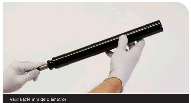
Para ayudar a colocar el resorte neumático en el tubo del resorte, enrosque la platina de cierre del ButterCups (Ultimate) o el perno inferior del resorte neumático (Base) en el extremo roscado del eje.
