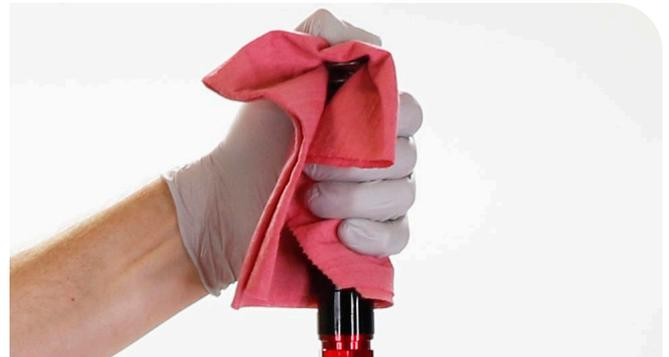
**6** Mientras mantiene comprimido el resorte del IFP, comprima lentamente el amortiguador hasta que el cabezal de sellado de rebote quede a la altura de la línea de purgado (A) del eje del amortiguador de rebote. Durante el proceso de purgado, el amortiguador de rebote no debe comprimirse más allá de la línea de purgado (A) del eje del amortiguador de rebote.
