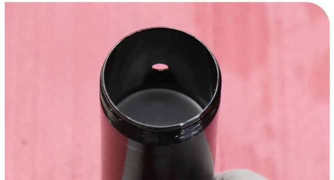
**4** **Charger 3 RC2:** Aplique una ligera capa de aceite para suspensiones al eje del amortiguador de compresión.
