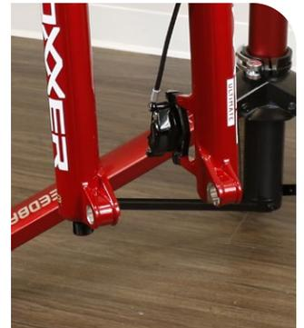
**5** Retire la guía del manguito del freno y el perno, y déjelos a un lado.
