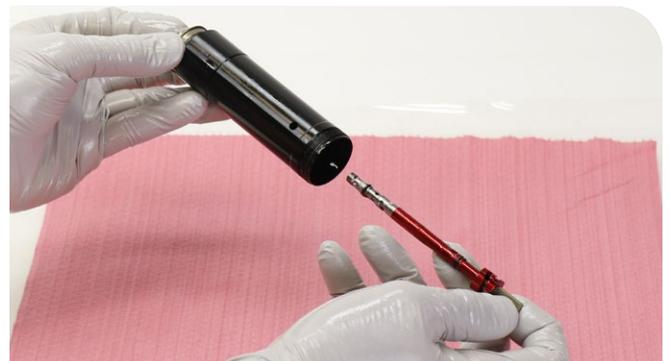
**14** Retire el conjunto del amortiguador de compresión del IFP y del tubo del IFP.
