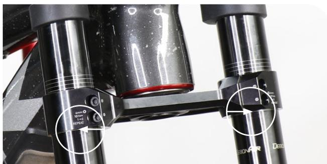
Position des graduations pour la hauteur du té inférieur sur les plongeurs
