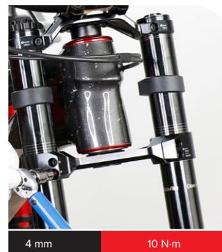
**9** Vérifiez que les plongeurs sont réglés de manière symétrique de chaque côté grâce aux graduations pour la hauteur du té inférieur des plongeurs.
