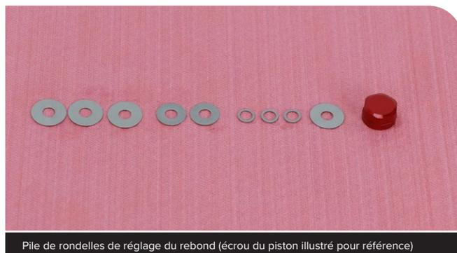
Pile de rondelles de réglage du rebond (écrou du piston illustré pour référence)
