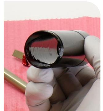
**3** Insérez le PFI par son extrémité plate/joint torique externe dans l'extrémité à filetage externe du tube du PFI.
