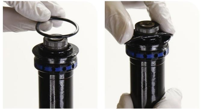
Appliquez de la graisse sur un joint torique neuf pour capuchon supérieur, puis installez-le.
