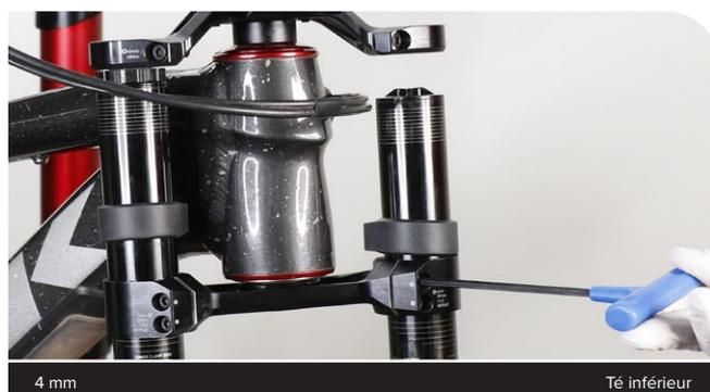
**9** Avec votre pouce, faites levier sur la partie la plus épaisse de chaque butée de cadre pour les décoller des plongeurs. Vaporisez de l'alcool isopropylique entre la butée de cadre et le plongeur de chaque côté.
