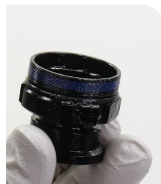
**10** Appliquez de la graisse sur la bague interne et le joint quadrilobe.
