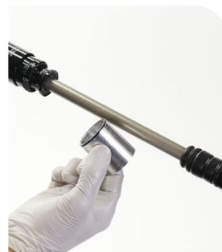
**10** Tirez de nouveau la tige du ressort à air et retirez le ressort à air et l'unité du tube du ressort à air hors du plongeur.
