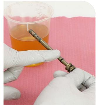
**6 Charger 3 RC2 :** Alignez l'orifice de la vis (A) dans l'unité de compression haute vitesse (HSC) avec le taquet de la cannelure de réglage (B) situé dans l'unité de la tige de compression basse vitesse (LSC).
