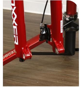
**5** Retirez la vis et le guide pour durite de frein et mettez-les de côté.
