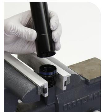
**5** Nettoyez le filetage situé à l'intérieur du tube du ressort à air.
