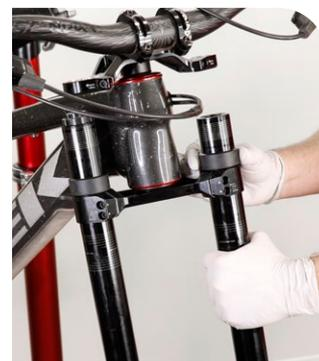
**6** Faites coulisser l'un des plongeurs du côté de votre choix vers le haut et dans le té supérieur jusqu'à ce que le bord supérieur du té inférieur soit réglé sur sa position d'origine grâce aux graduations pour la hauteur des tés des plongeurs. Serrez la vis du té inférieur à la main.
