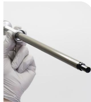
**8** Appliquez de la graisse sur le joint quadrilobe interne et installez-le dans la tête d'étanchéité.
