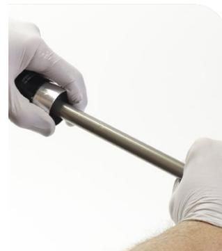
**9** Retirez l'entretoise de la tête d'étanchéité insérée dans le tube du ressort à air puis mettez-la de côté.
