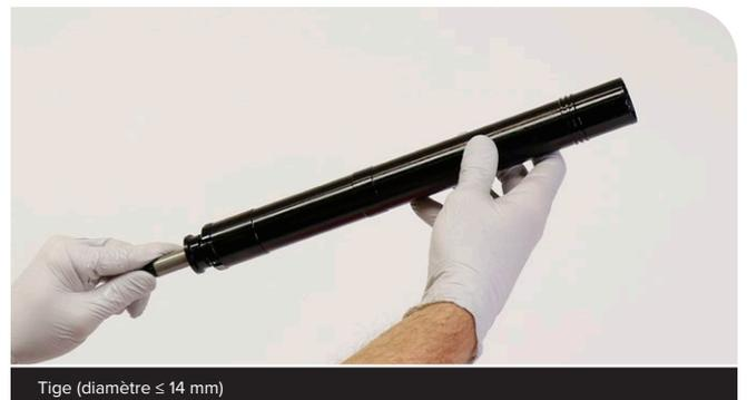
Pour permettre de positionner correctement le ressort à air dans le tube du ressort à air, vissez l'embase ButterCups (Ultimate) ou la vis inférieure du ressort à air (Base) dans l'extrémité fileté de la tige.
