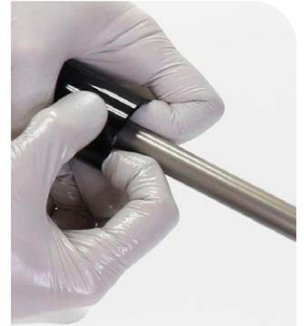
L'entretoise est parfaitement positionnée lorsque la cannelure du circlip est visible.
