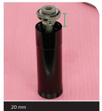
**5 Kit d'amélioration Charger 3 RC2 à Charger 3.1 RC2 :** Si l'amortisseur de compression Charger 3 RC2 est mis à niveau vers Charger 3.1 RC2, installez la nouvelle unité tube de compression haute vitesse Charger 3.1 RC2 (HSC)/tige de compression basse vitesse (LSC) inclus dans le kit d'amélioration.
