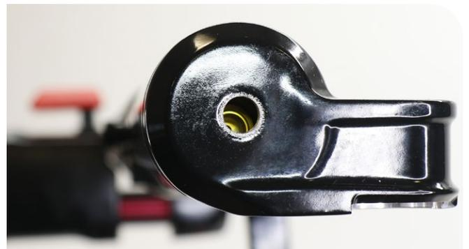
**6** Installez le plongeur du côté du ressort à air dans le fourreau. Faites suffisamment coulisser le plongeur dans le fourreau pour que la bague supérieure s'engage.
