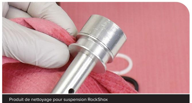
**5** Installez la bague d'appui fine (inférieure) sur le piston à air.
