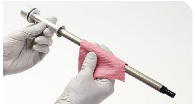
**3** Retirez la bague d'appui épaisse (supérieure), le joint quadrilobe et la bague d'appui fine (inférieure) situés sur le piston à air.
