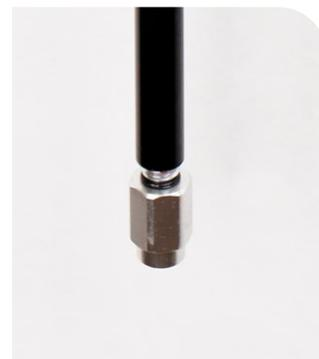
**3** À l'aide de la molette du régleur de la compression, tournez le régleur de la compression dans le sens des aiguilles d'une montre jusqu'à ce qu'il se bloque. C'est le réglage de la compression le plus ferme.
