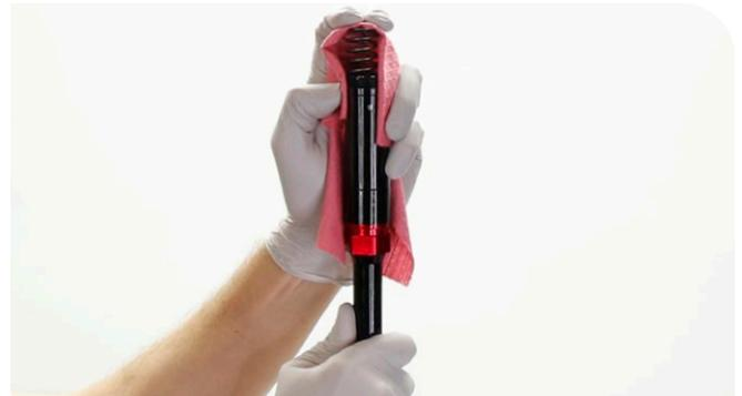
**5** Tout en maintenant toujours le ressort du PFI comprimé, comprenez lentement la cartouche d'amortissement jusqu'à ce que la tête d'étanchéité de la détente atteigne la ligne de purge (A) marquée sur la tige de la cartouche de détente. Pendant le processus de purge, la cartouche de détente ne doit pas être comprimée au-delà de la ligne de purge (A) marquée sur la tige de la cartouche de détente.
