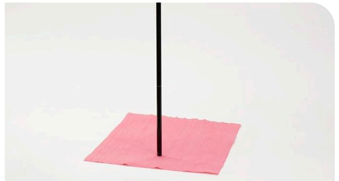
**4** Pour purger l'huile présente au-dessus du PFI, le PFI doit être comprimé à la main à l'intérieur du tube du PFI avec le ressort du PFI, tandis que la cartouche de détente est comprimée et actionnée à l'intérieur du tube de la cartouche d'amortissement.
