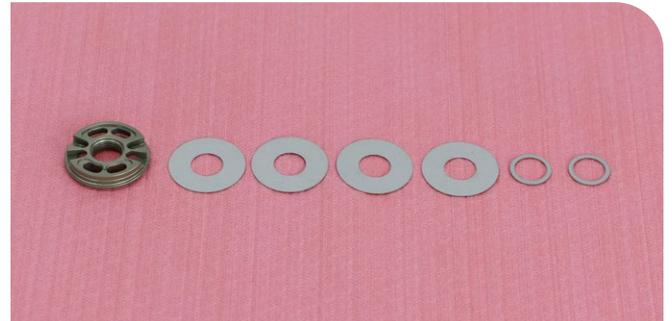
Druckstufenabstimmungs-Federplättchenstapel (Abbildung des High-Flow-Kolbens nur zur Referenz)
