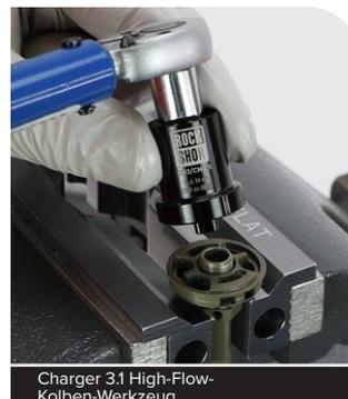
Charger 3.1 High-Flow-Kolben-Werkzeug
