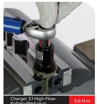
Charger 3.1 High-Flow-Kolben-Werkzeug
