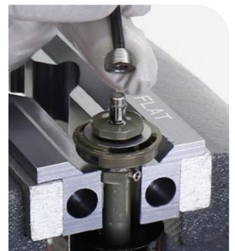
**12** Entfernen Sie die Druckstufendämpfer-Baugruppe und das IFP-Rohr aus dem Schraubstock.
