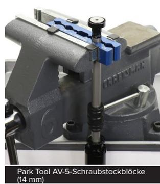
Park Tool AV-5-Schraubstockblöcke (14 mm)
