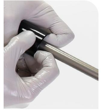
Das Distanzstück sitzt ordnungsgemäß, wenn die Nut des Sicherungsringes sichtbar ist.
