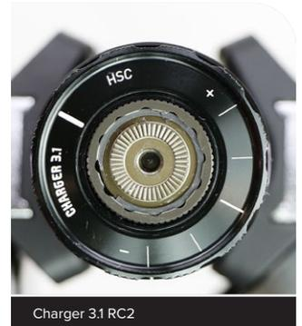
**6** Drehen Sie die Einstellnocke des Lowspeed-Druckstufeneinstellers mit einem 2,5-mm-Inbusschlüssel **im Uhrzeigersinn** bis zum Anschlag.
