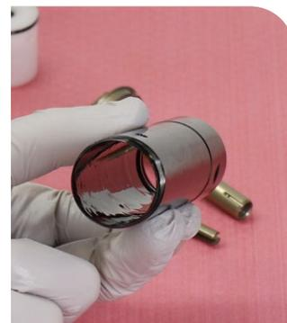
**3** Führen Sie den IFP in das IFP-Rohr und setzen Sie ihn mit dem flachen Ende/äußeren O-Ring voran in das Ende des IFP-Rohrs mit dem Außengewinde ein.
