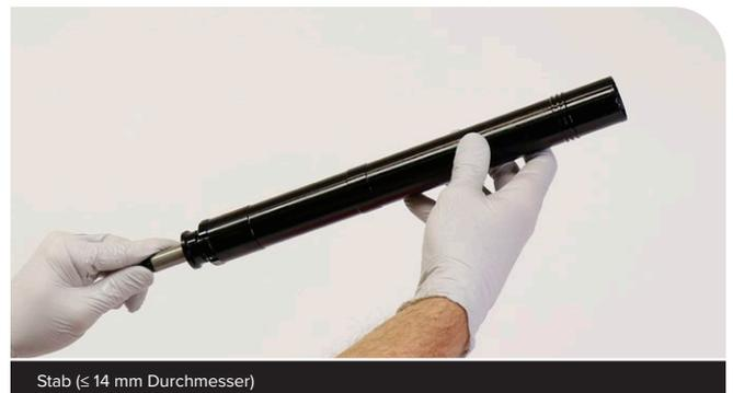
Um sich die Positionierung der Luftfeder im Luftfederrohr zu vereinfachen, schrauben Sie entweder die ButterCups-Endplatte (Ultimate) oder die untere Schraube der Luftfeder (Base) in das Schaftende mit Gewinde.
