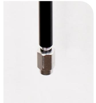
**3** Drehen Sie den Druckstufeneinsteller mit dem Druckstufeneinstellung bis zum Anschlag im Uhrzeigersinn. Dies ist die härteste Einstellung der Druckstufendämpfung.
