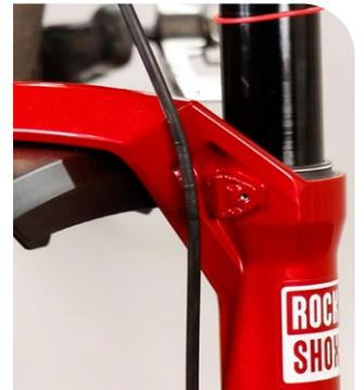
**6** Führen Sie einen Belagspreizer in den Bremssattel ein, um ein Vorschieben der Bremssattelkolben zu vermeiden.
