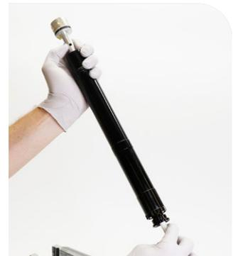
**Federweganpassung und ButterCups-Upgrade:** Legen Sie die Original-Luftfeder-Baugruppe beiseite. Sie wird nicht wieder eingebaut.
