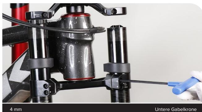
**9** Entfernen Sie mit dem Daumen die Rahmenanschlagpuffer an der dicksten Stelle von den Standrohren. Sprühen Sie Isopropyl-Alkohol zwischen jeden Puffer und auf das Standrohr.
