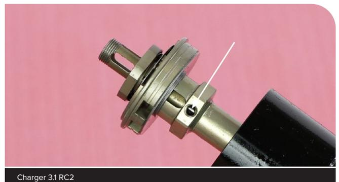
**7** **Charger 3 RC2, Charger 3.1 RC2 (Upgrade):** Bringen Sie jede Nockeneinsteller-Klemmschraube (2 Stück) gleichmäßig handfest an. Ziehen Sie beide Klemmschrauben mit dem angegebenen Drehmoment fest.
