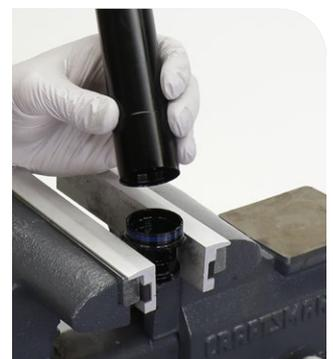
**5** Säubern Sie das Gewinde des Luftfederrohrs.
