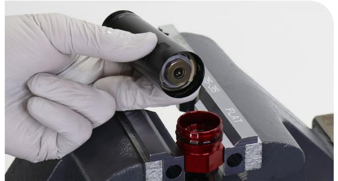
**15** Entfernen Sie das Kartuschenrohr aus dem Schraubstock.
