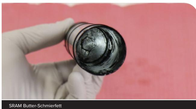
**8** Entfernen Sie das Schmierfett vom inneren Gewinde des Luftfederstift-Distanzstücks.
