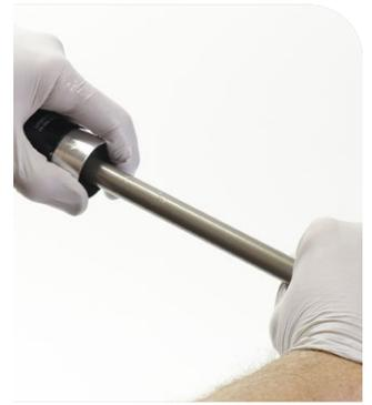
**9** Entfernen Sie das Dichtkopf-Distanzstück aus dem Luftfederrohr und legen Sie es beiseite.
