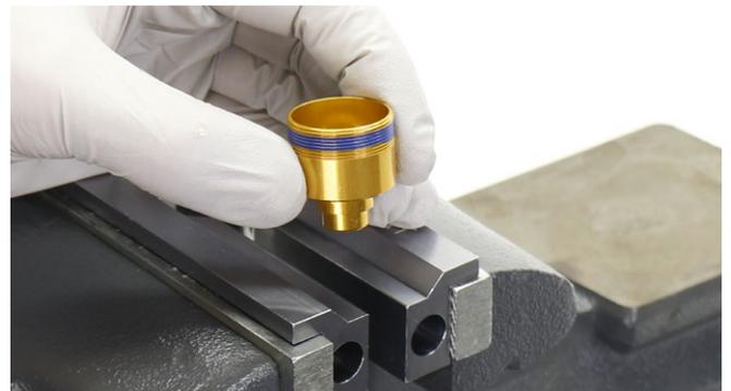
**5** Säubern Sie den Luftfederschaft und entfernen Sie sämtliches Schmierfett und Öl.
