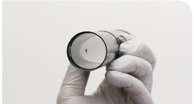
**6** Entfernen Sie die innere Vierkantringdichtung des Luftdichtkopfs.
