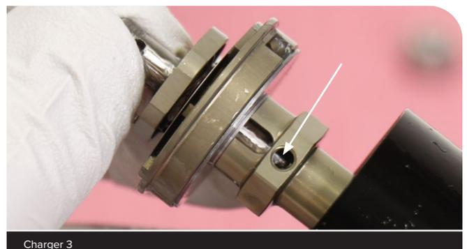
**Charger 3.1 RC2 (Upgrade):** Richten Sie die Schraubenbohrung (A) in der High-Speed-Druckstufen-Baugruppe (HSC) am Anschlag der Einstellnut (B) in der Low-Speed-Druckstufenschaft-Baugruppe (LSC) aus.
