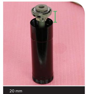
**5 Upgrade von Charger 3 RC2 auf Charger 3.1 RC2:** Wenn der Charger 3 RC2 Druckstufendämpfer auf Charger 3.1 RC2 aufgerüstet wird, bauen Sie das neue Upgrade mit der im Upgrade-Kit enthaltenen Baugruppe mit High-Speed-Druckstufenrohr (HSC) und Low-Speed-Druckstufen-Nockeneinsteller (LSC) ein.
