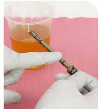
**6 Charger 3 RC2:** Richten Sie die Schraubenbohrung (A) in der High-Speed-Druckstufen-Baugruppe (HSC) am Anschlag der Einstellnut (B) in der Low-Speed-Druckstufenschaft-Baugruppe (LSC) aus.
