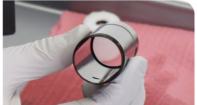
**24** Entfernen Sie den inneren und den äußeren O-Ring des IFP und entsorgen Sie die O-Ringe.
