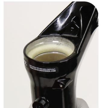
**5** Entfernen Sie die äußere Drahtfeder aus den beiden neuen Staubabstreiferdichtungen und legen Sie sie beiseite.
