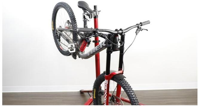
**2** **Notieren** Sie sich zur Unterstützung bei der Montage nach der Wartung die Positionen des Standrohrs und der Gabelkrone wie durch die Gabelkronen-Höhenmarkierungen auf dem Standrohr angegeben.
