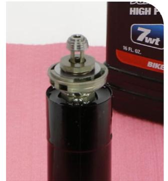
**12** **Charger 3 RC2, Charger 3.1 RC2 (Upgrade):** Halten Sie ein Werkstatttuch um das IFP-Rohr.
