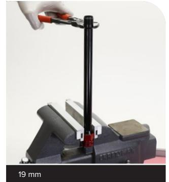
Entfernen Sie das Kartuschenrohr.
