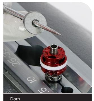
**3** Ordnen Sie den neuen Zugstufenabstimmungs-Federplättchenstapel in der Reihenfolge der gewünschten Abstimmung an. Verwenden Sie die nachfolgende Spezifikation für die Federplättchenabstimmung.
