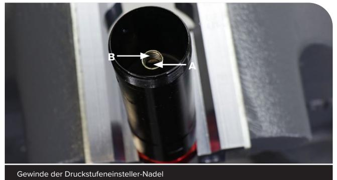
Gewinde der Druckstufeneinsteller-Nadel
