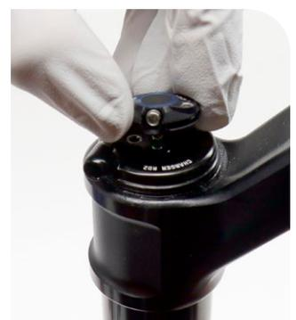
**RL R:** Afloje el tornillo de fijación del collarín de tope del cable y extraiga el collarín.
