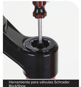
Herramienta para válvulas Schrader
