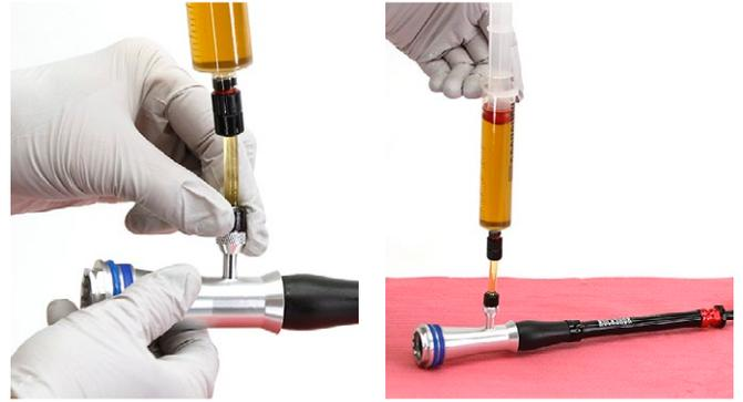
Suelte el émbolo y el aire se purgará en la jeringa. Comprima y suelte el émbolo para inyectar aceite en el amortiguador. Rellene la jeringa si fuera necesario.
