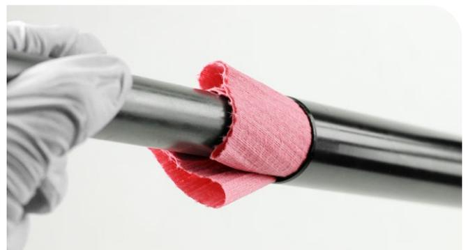
**10** **SID SL:** Desmonte el cabezal de sellado del eje neumático.
