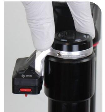
**3** Compruebe y confirme que el módulo de control se asienta completamente, queda plano sobre la tapa superior y NO toca ninguna parte de la corona de la horquilla. Compruebe y confirme que no queda hueco entre el módulo de control y la tapa superior.
