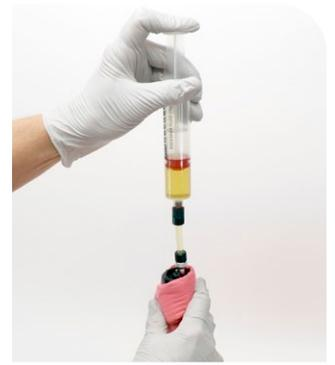
Suelte el émbolo y el aire se purgará en la jeringa. Comprima y suelte el émbolo para inyectar aceite en el amortiguador. Rellene la jeringa si fuera necesario.
