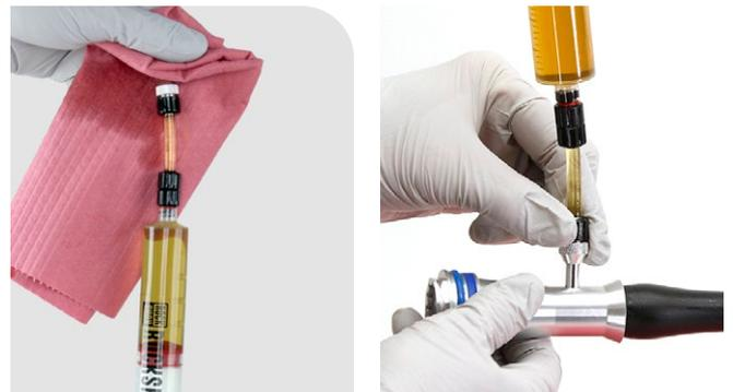
**7** Inyecte el aceite en el conjunto del amortiguador.
