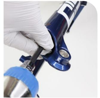
Ultimate/Select +: Lado del amortiguador - 5 mm
