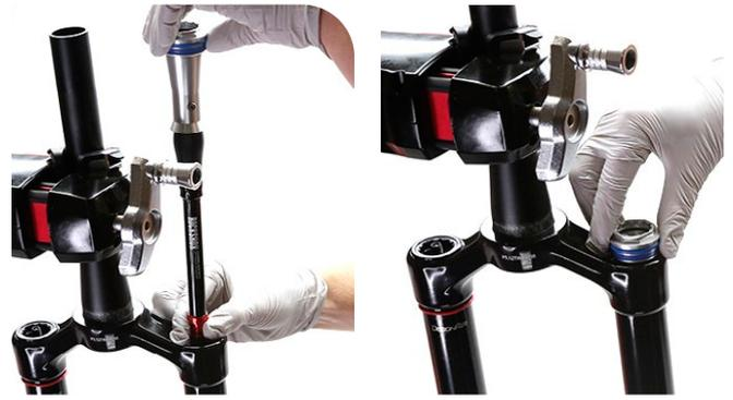
Enrosque la tapa superior en el tubo superior y apriétela. Presione fuerte hacia abajo mientras la aprieta.
