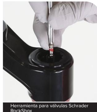
Herramienta para válvulas Schrader
