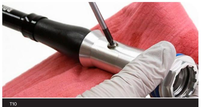
**10** Empuje rápidamente el eje de rebote hacia dentro y hacia fuera de 15 a 20 veces.
