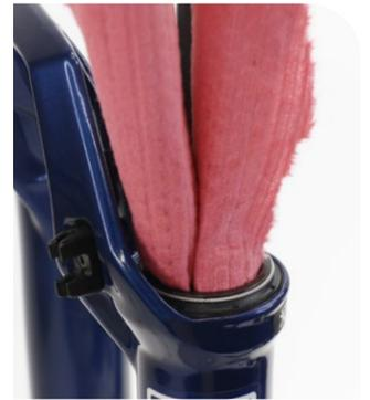
**6** Instale los anillos de gomaespuma debajo de las juntas antipolvo. Confirme que los anillos de gomaespuma quedan colocados uniformemente en el espacio debajo de las juntas antipolvo y que no sobresalen de los casquillos. Instale la arandela de alambre.
