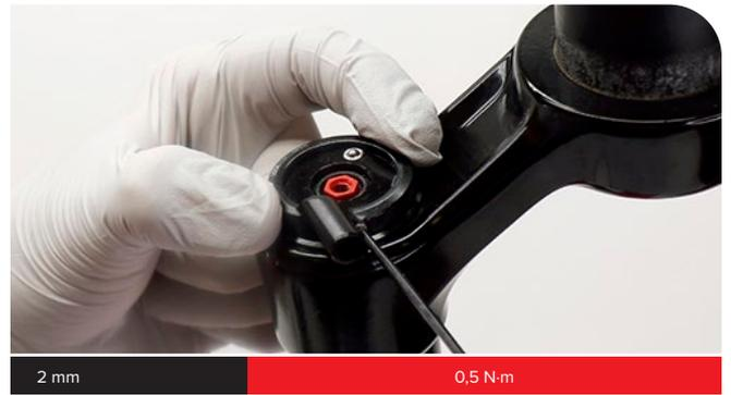
Instale el carrete del control remoto en el ajustador hexagonal con el tornillo de fijación del cable orientado dentro del intervalo de 20 grados en el diagrama.
