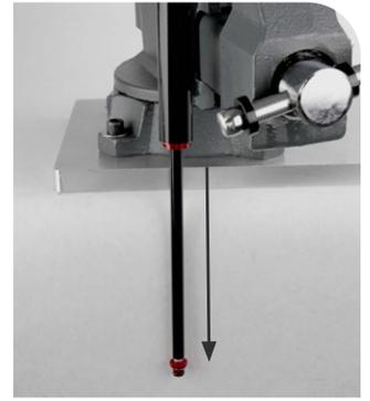
**5** Vierta aceite para suspensiones Maxima PLUSH 3wt dentro del tubo hasta llenarlo casi hasta la mitad. Mueva cíclicamente el eje del amortiguador de rebote hacia dentro y hacia fuera hasta la mitad de su recorrido para eliminar las burbujas de aire atrapadas debajo del pistón del amortiguador de rebote. Deténgase cuando no haya burbujas visibles en el aceite.
