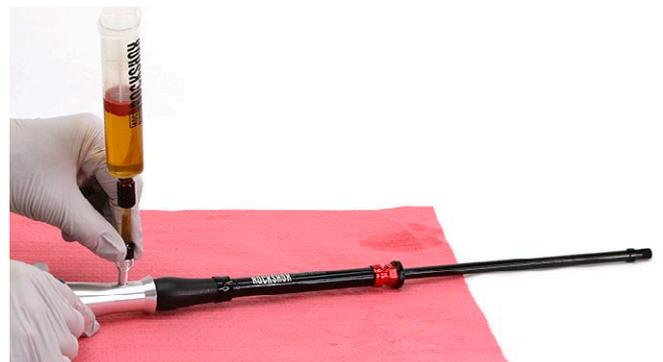
Mantenga el amortiguador en posición horizontal. Enrosque la jeringa en el orificio de purgado del cuerpo lateral del amortiguador.
