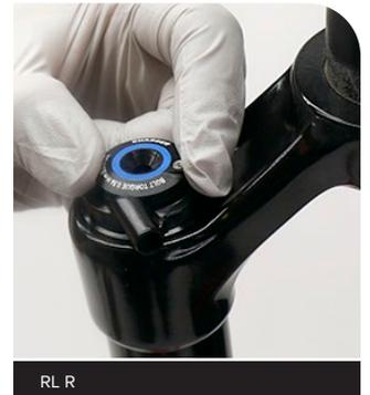
Instale y apriete el tornillo de retención del carrete del control remoto. En el manual de usuario correspondiente, disponible en [www.sram.com/service](http://www.sram.com/service), encontrará instrucciones para la instalación del cable y del control remoto.
