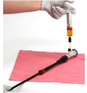
**8** Empuje el mango de la jeringa hacia abajo y luego suelte el émbolo. Deje que la cámara flexible alcance una posición de reposo natural; para ello, espere un momento hasta que la jeringa deje de llenarse.
