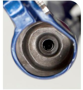
**Ultimate/Select +:** Use una llave de 5 mm para guiar el eje del amortiguador a través del orificio del brazo inferior. Empuje el brazo inferior un poco más hacia la corona superior, hasta que las roscas del eje del amortiguador queden expuestas.
