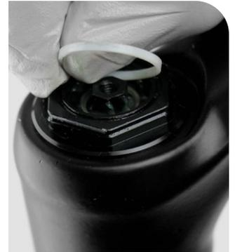
**4** Desenrosque la tapa superior del amortiguador y retire el conjunto del amortiguador.
