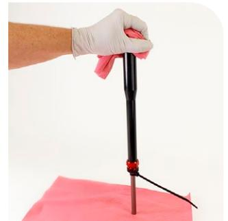
**1 RL:** Utilice el mando del regulador para girar a tope la leva de compresión en sentido horario hasta la posición firme.
