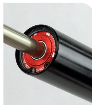
**20** Instale el tope inferior de rebote en el eje neumático.
