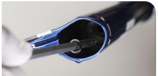
Ultimate/Select +: Lado del amortiguador - 5 mm
